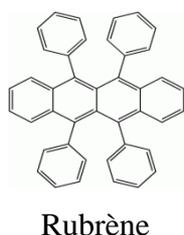
**Figure I.14** : Structure chimique de la molécule de Rubrène.
