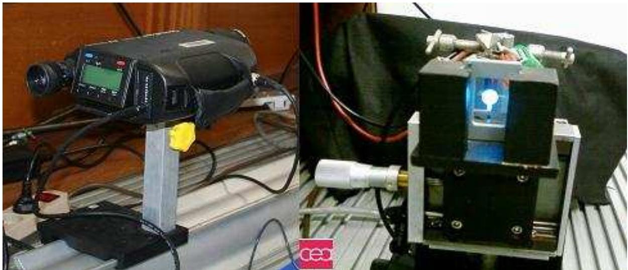
**Figure II.3 :** SpectraScan à gauche et l'OLED allumée à droite.
