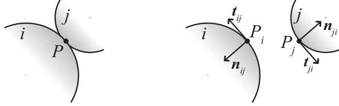
FIG. 2.5 – Repères locaux attachés à la particule i ( \mathbf{n}_{ij}, \mathbf{t}_{ij} ) et à la particule j ( \mathbf{n}_{ji}, \mathbf{t}_{ji} ). P_i et P_j sont les points matériels des particules i et j en contact
