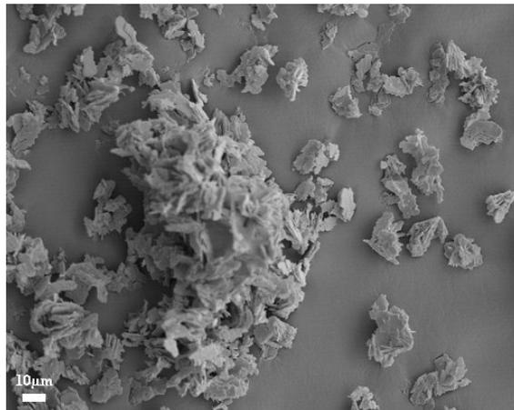
FIG. 2.5 – Photographies de solides obtenus par précipitation contenant  $\frac{P}{S} = 4$ .
