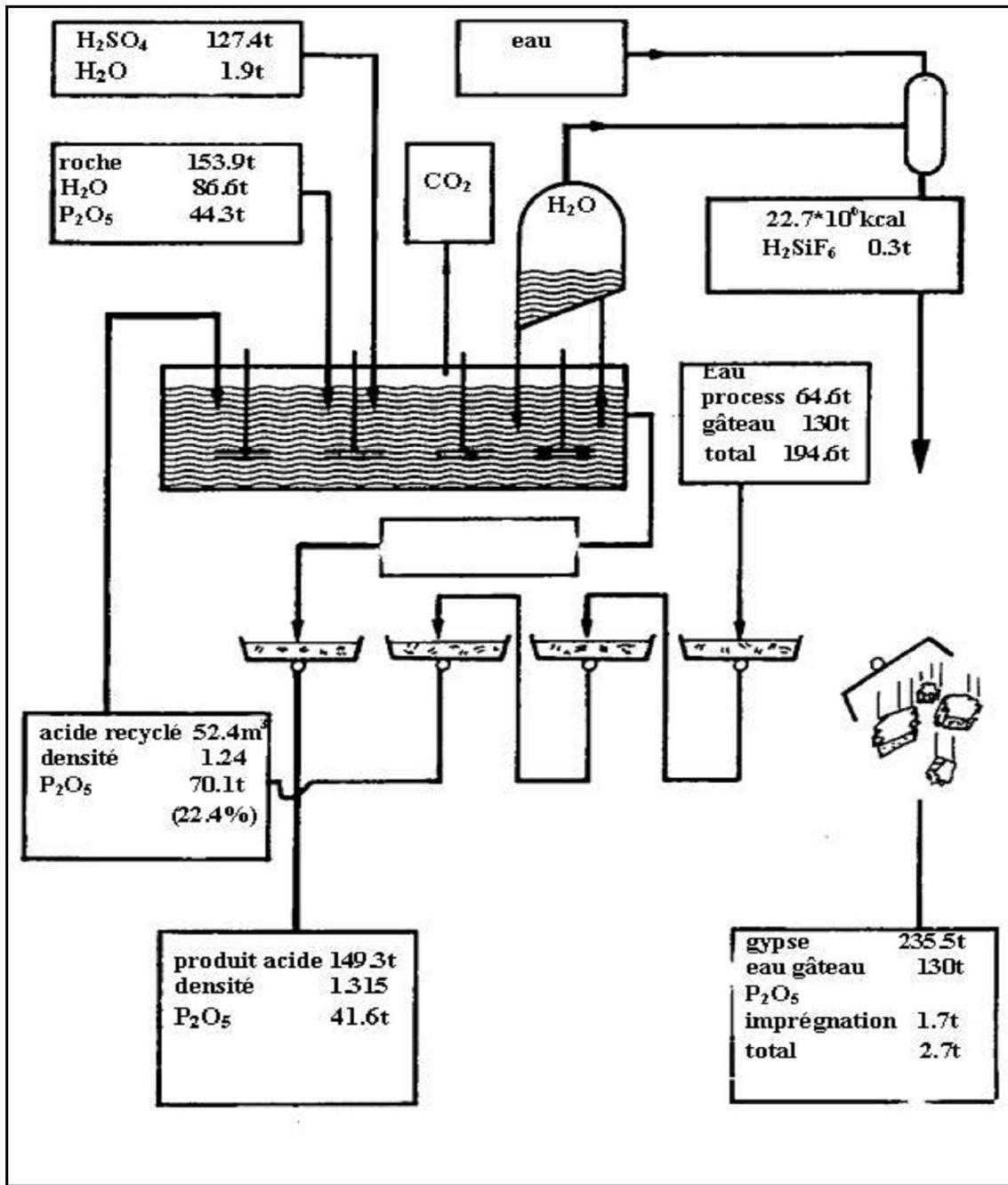
FIG. B.4 – Bilan matière d'une unité de production d'acide phosphorique (capacité de production : 1000t de P<sub>2</sub>O<sub>5</sub> par jour) selon le procédé dihydrate [2].
