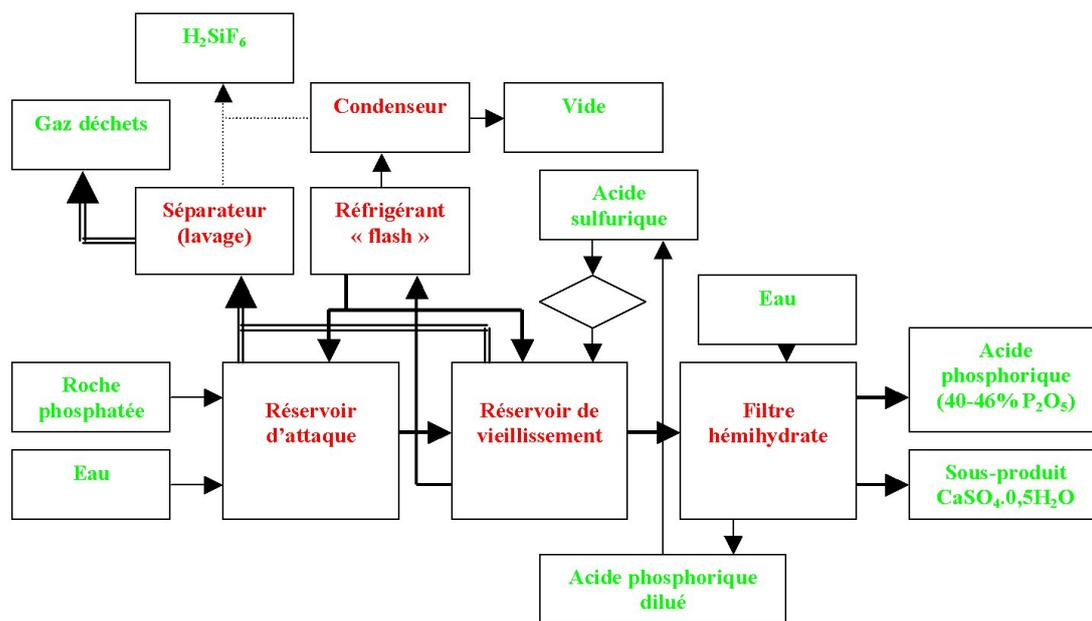
FIG. B.2 – Schéma du procédé hémihydrate (HH).
