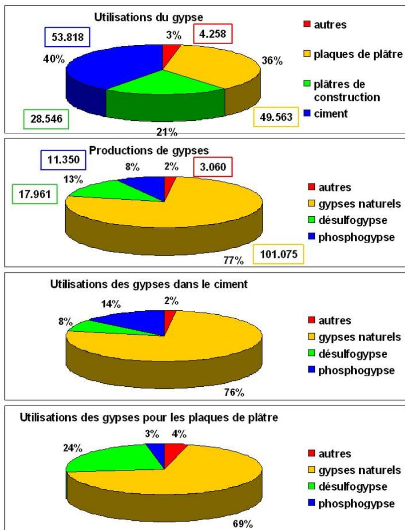
FIG. 1.1 – Productions et utilisations des différents types de gypse dans le monde en 2000 (Caspar et al. [5]).
