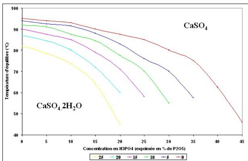
FIG. B.3 – Dépendance de l'équilibre sulfate de calcium/ $\alpha$ -hémihydrate avec la concentration en acide sulfurique.
