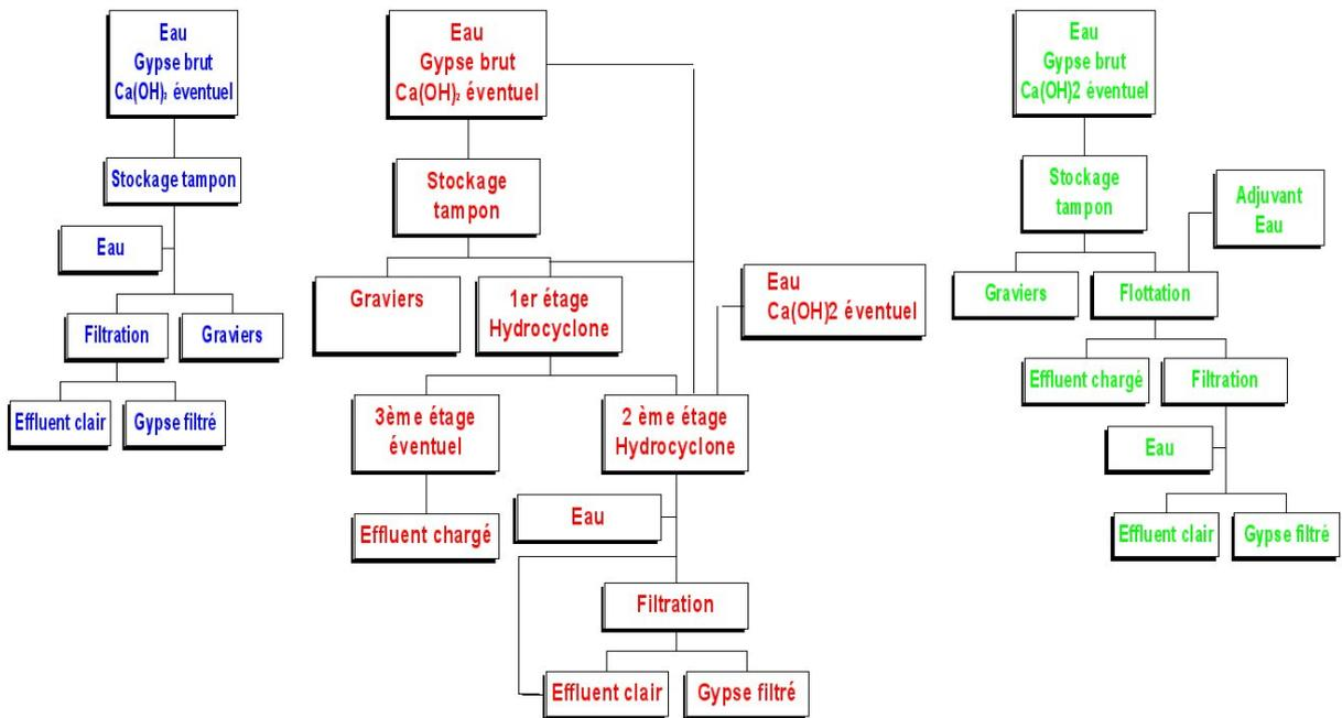
FIG. D.2 – Procédé Rhône-Poulenc de filtration-purification.
