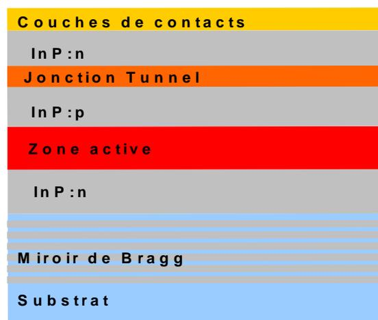
Figure 3- 1: Schéma de l'empilement des couches constituant le 1/2 VCSEL.
