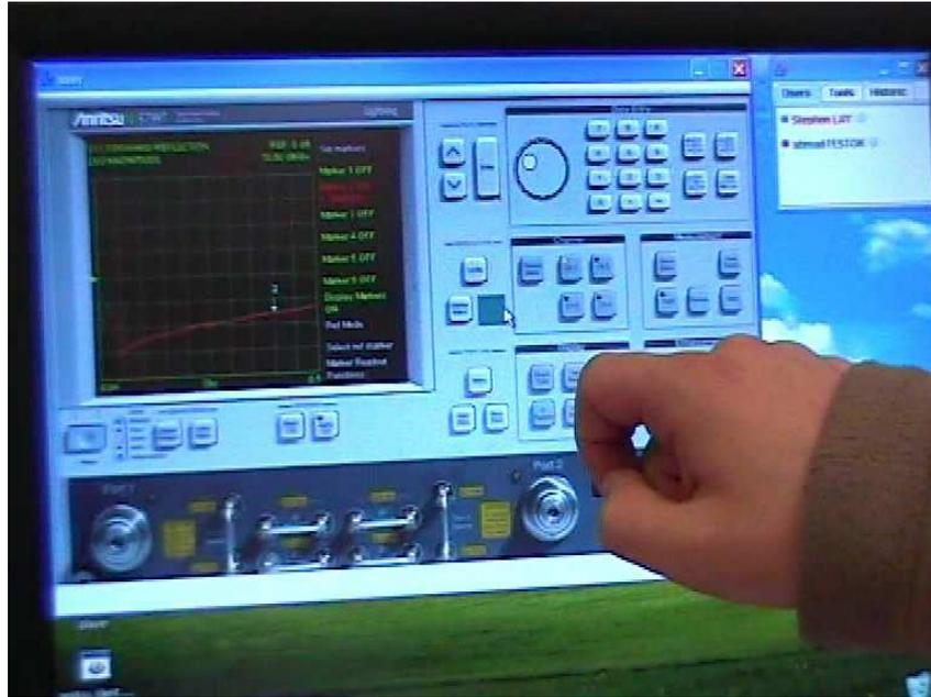
FIG. II.16 – Application résultante, permettant d'utiliser l'AVR Anritsu à distance, de manière réaliste : fidélité de la représentation et utilisation (écran tactile).
