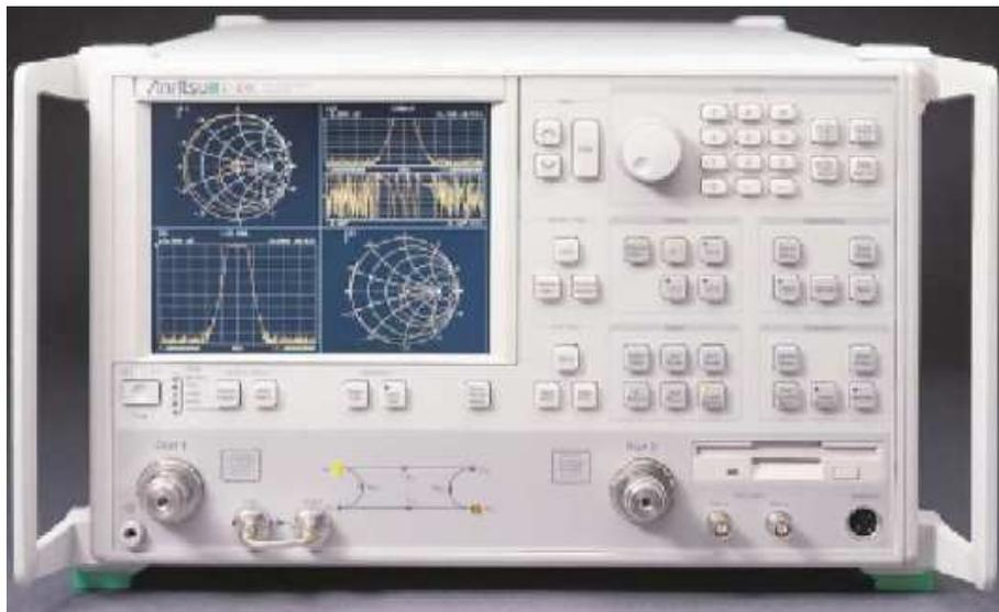
FIG. II.13 – Analyseur vectoriel de réseaux Anritsu 37397A utilisé au laboratoire DIOM.
