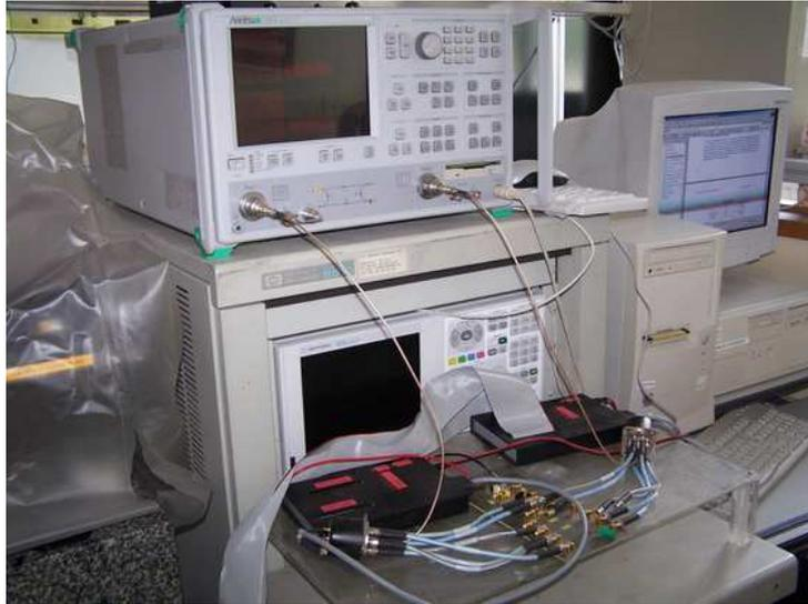
FIG. IV.2 – Le laboratoire distant avec PC local, analyseur vectoriel de réseau et composants à caractériser.
