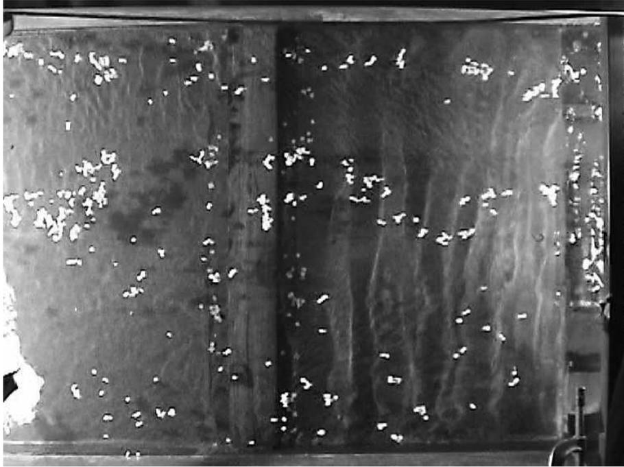
FIG. 5.12 – Image extraite d’une séquence vidéo utilisée pour l’expérience. On y voit les confettis à la surface de l’eau (point blancs) ainsi que la planche au fond du canal servant d’obstacle.
