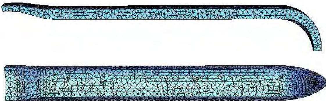
Figure 147 : Maillages de la préforme utilisée.
