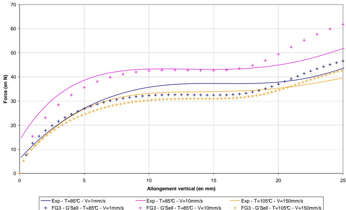
**Figure 128 : Simulation d'un essai pour différentes températures et vitesses de sollicitation. Evolution de la force en fonction de l'allongement pour le modèle de G'Sell avec les paramètres identifiés par E. Gorlier pour l'approche éprouvette entière.**
