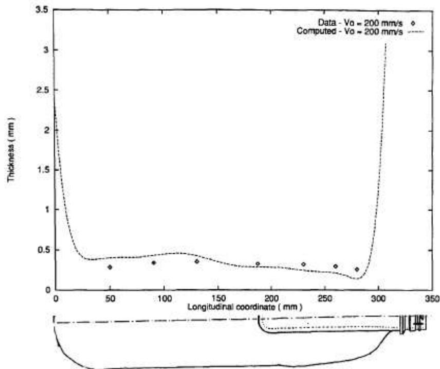
Figure 7 : Distribution d'épaisseur en fin de process [SCH-1996].
