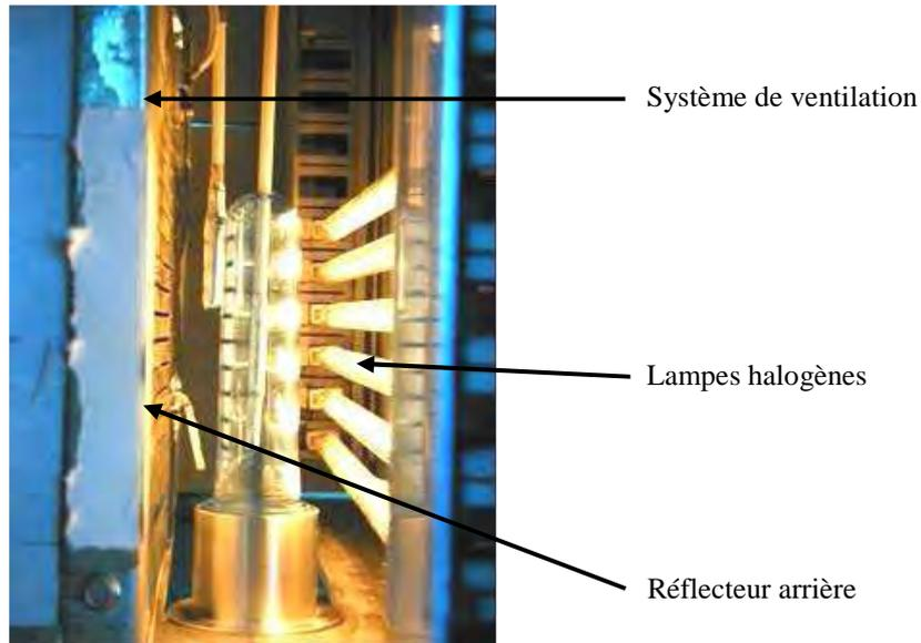
**Figure 14 :** Description d'un module de four infrarouge.
