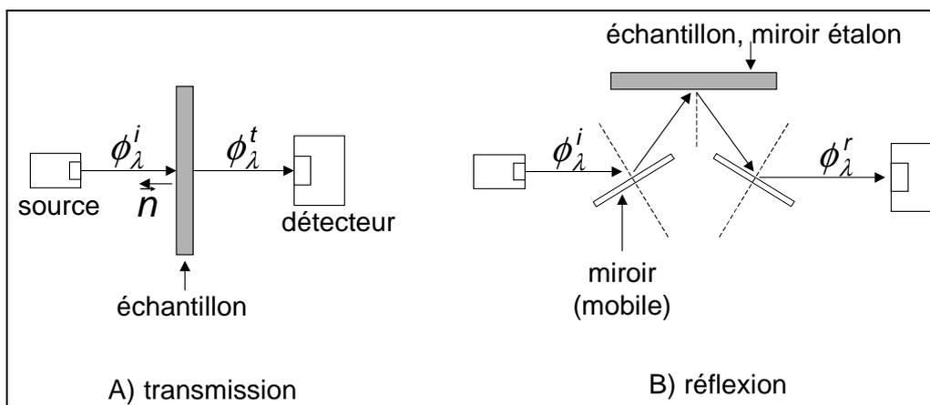
Figure 22 : Dispositifs expérimentaux en transmission et réflexion [MON-2001].
