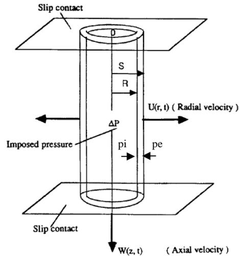
Figure 157 : Modèle de gonflage de tube.
