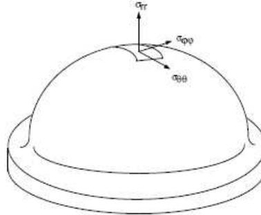
Figure 108 : Modèle de gonflage de sphère [SCH-2004].
