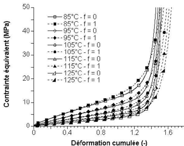
Figure 144 : Courbes contrainte-déformation en traction uniaxiale sur éprouvettes sablier [GOR-2001].
