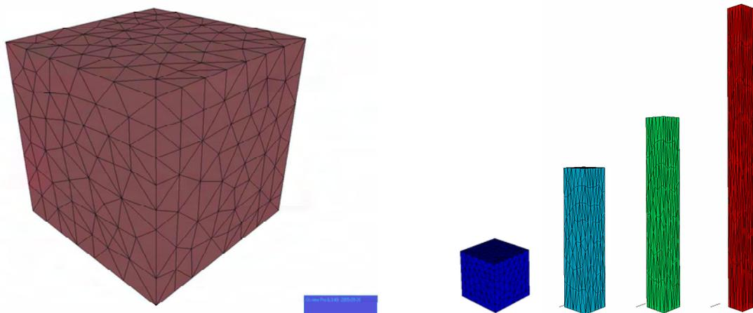
Figure 102 : Modèle numérique de l'essai de traction uniaxiale.
