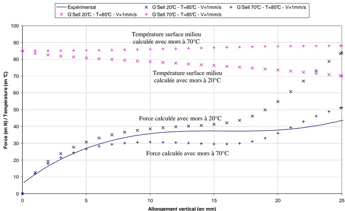
**Figure 127 :** Simulation d'un essai à  $T=85^{\circ}\text{C}$  et  $V=1\text{mm/s}$ . Evolution de la force en fonction de l'allongement pour le modèle de G'Sell avec les paramètres identifiés par E. Gorlier pour des températures de mors de  $20^{\circ}\text{C}$  et  $70^{\circ}\text{C}$ . Evolution de la température au milieu de la préforme en surface.
