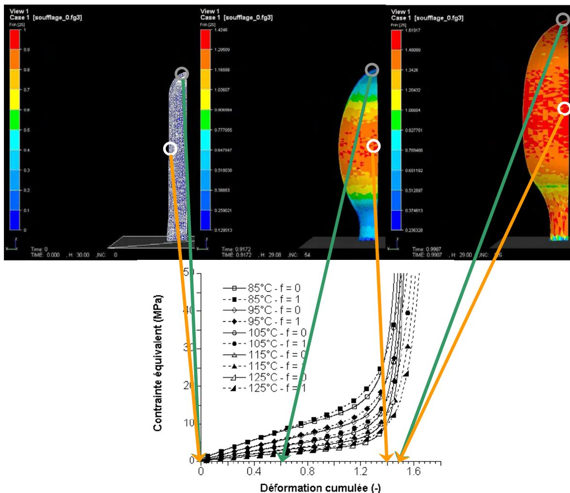
**Figure 148 :** Distributions de déformation sur la surface interne du 1/8<sup>ème</sup> de la préforme étudiée. Les déformations des points cerclés sont reportées sur l'abscisse de la courbe ( $\sigma, \epsilon$ ) du matériau pour comprendre le phénomène de gonflage de la préforme.
