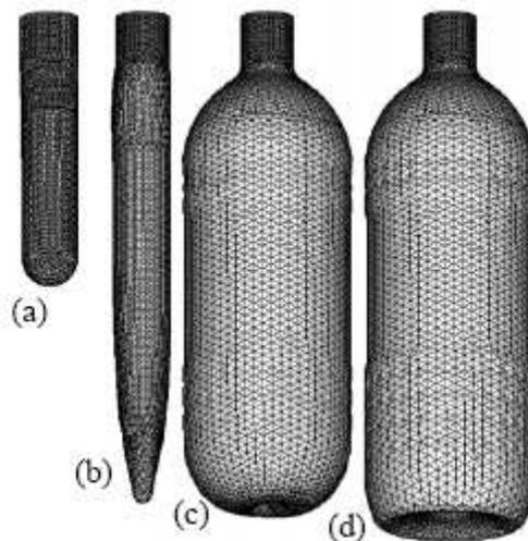
**Figure 97 : Modélisation membranaire de l'étirage soufflage avec une loi d'Ogden [MAR-1999].**
