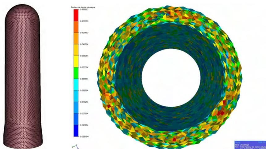
Figure 79 : Maillage extérieur d'une préforme et facteur de forme volumique des éléments sur une coupe transversale (=Constante de normalisation \* Volume de l'élément / longueur moyenne des arêtes<sup>3</sup>)
