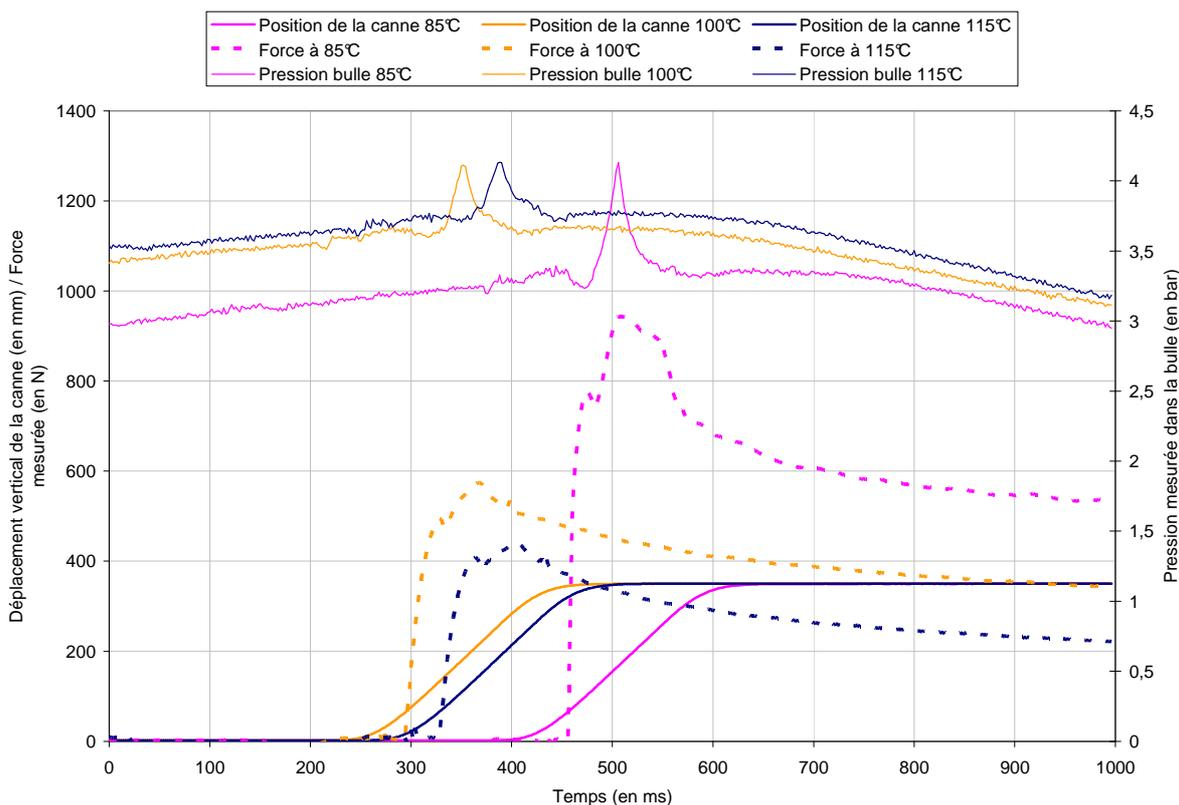
**Figure 138 : Corrélation entre force et pression.**
