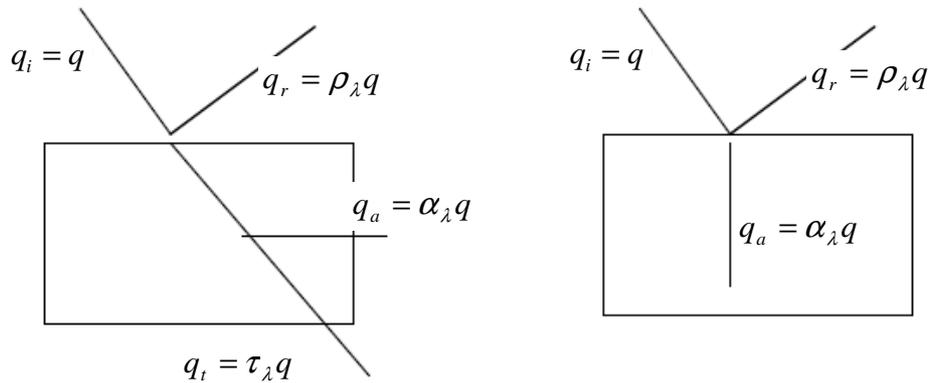
Figure 11 : Schéma de diffusion d'un rayon incident [IN2-2000].
