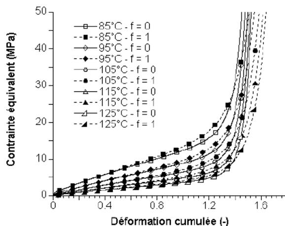
Figure 130 : Rhéologie pour une vitesse de déformation équivalente moyenne de 10/s [GOR-2001].
