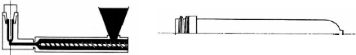
Figure 2 : Injection et stockage de la préforme [DEN-1989].
