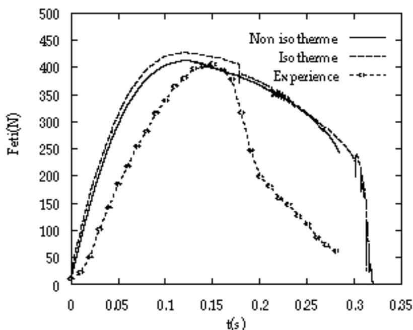
Figure 132 : Comparaison forces d'étirage mesurée / calculée [SCH-1995].
