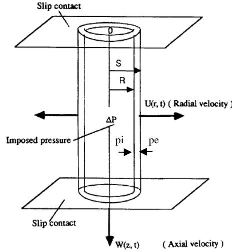
Figure 104 : Modèle de gonflage de tube [SCH-2000].
