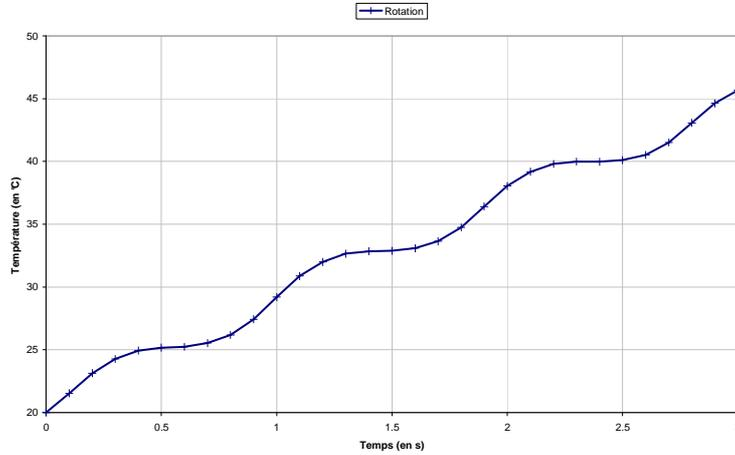
Figure 88 : Evolution à mi-hauteur de la préforme statique ou en rotation, de la température en un point situé initialement face au module.
