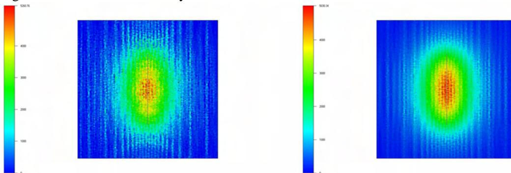
**Figure 60 : Cartographie d'éclairement d'une plaque avec une discrétisation de Niv=5 et Niv=20.**
