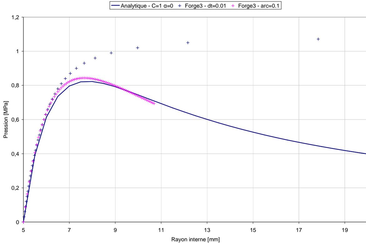
**Figure 118 : Relation entre pression appliquée et rayon interne lors du gonflement d'une sphère hyperélastique de type néo-hookéen ( $C=1\text{MPa}$ ) en fonction de la pression imposée sur sa surface interne.**
