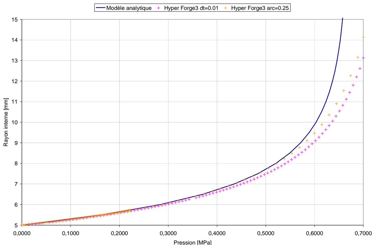
**Figure 117 :** Evolution du rayon interne d'un tube hyperélastique de type néo-hookéen ( $C=1\text{MPa}$ ) en fonction de la pression imposée sur sa surface interne tracé dans le cadre du modèle analytique, d'une résolution en contrôle d'effort et d'une résolution par longueur d'arc.
