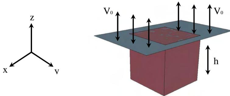
Figure 101 : Simulation de l'essai de traction/compression simple.
