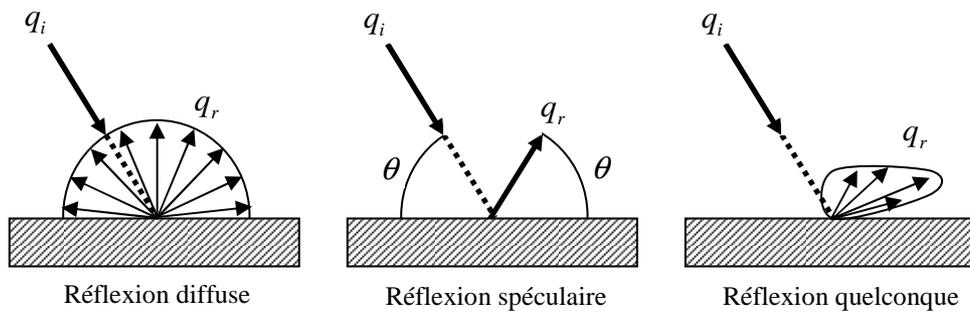
Figure 12 : Schéma de réflexion d'un rayon incident.
