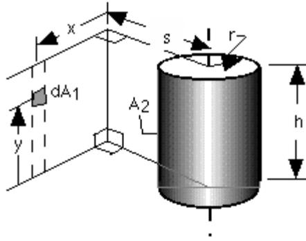
Figure 50 : Situation géométrique d'un élément de plan parallèle à un cylindre fini [SIE-1992].
