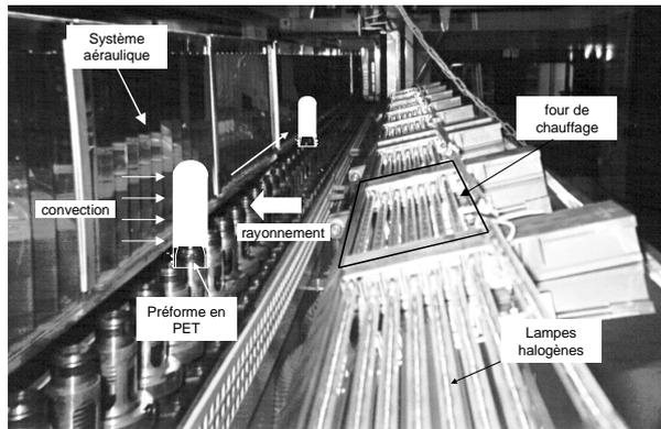
Figure 45 : Vue d'ensemble d'une installation de chauffage industrielle [MON-2001].
