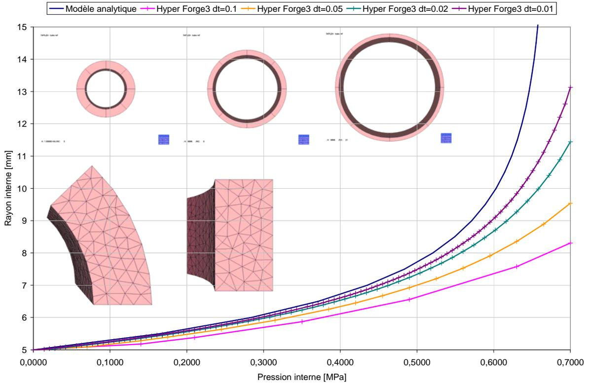
**Figure 107 :** Evolution du rayon interne d'un tube néo-hookéen ( $C=1\text{MPa}$ ) en fonction de la pression appliquée sur la face interne du tube.
