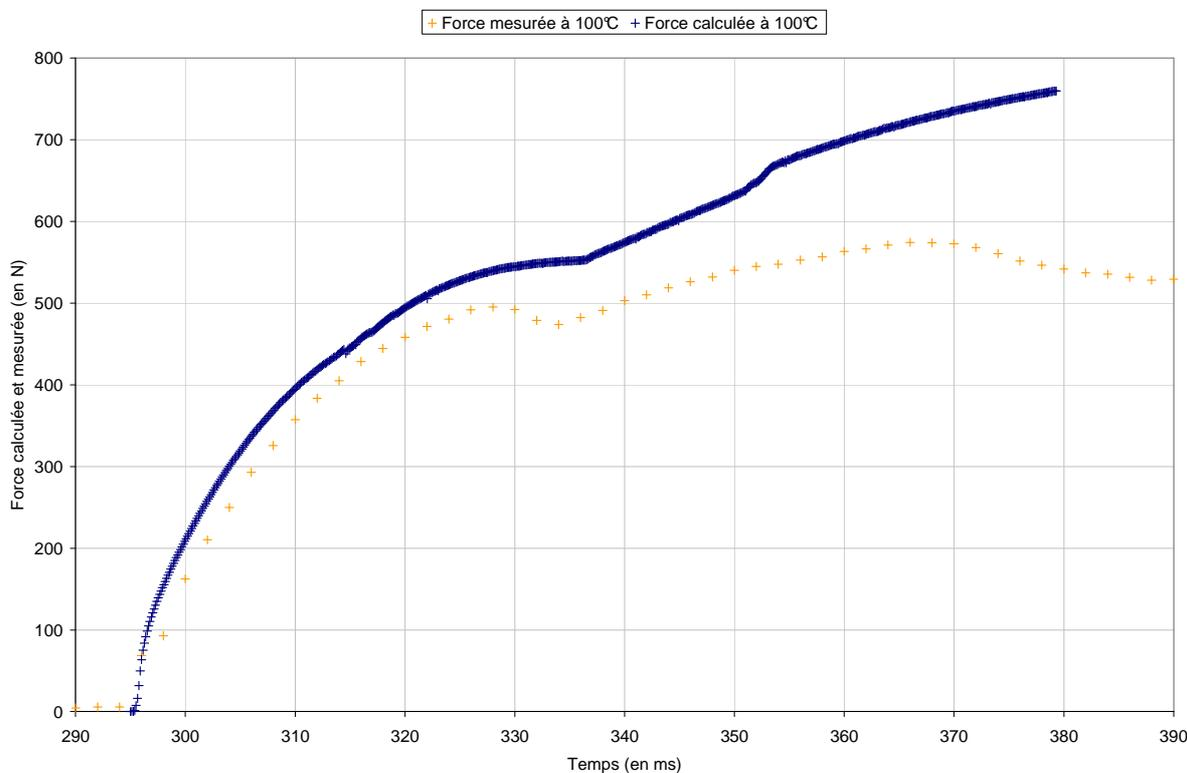
**Figure 143 : Evolution de la force mesurée en tête de canne et de la force calculée (pour une température initiale de 100°C).**
