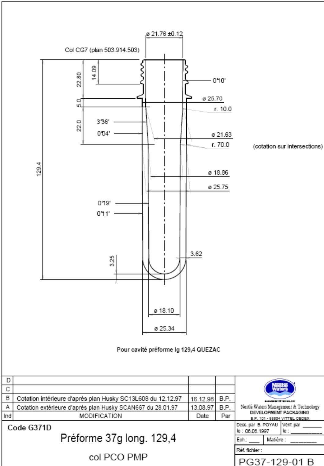
Figure 159 : Géométrie de la préforme utilisée.
