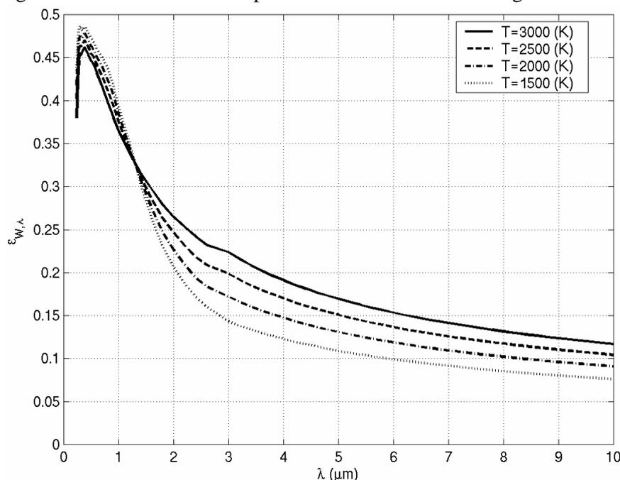
**Figure 16 : Emissivité spectrale du tungstène [MON-2001].**
