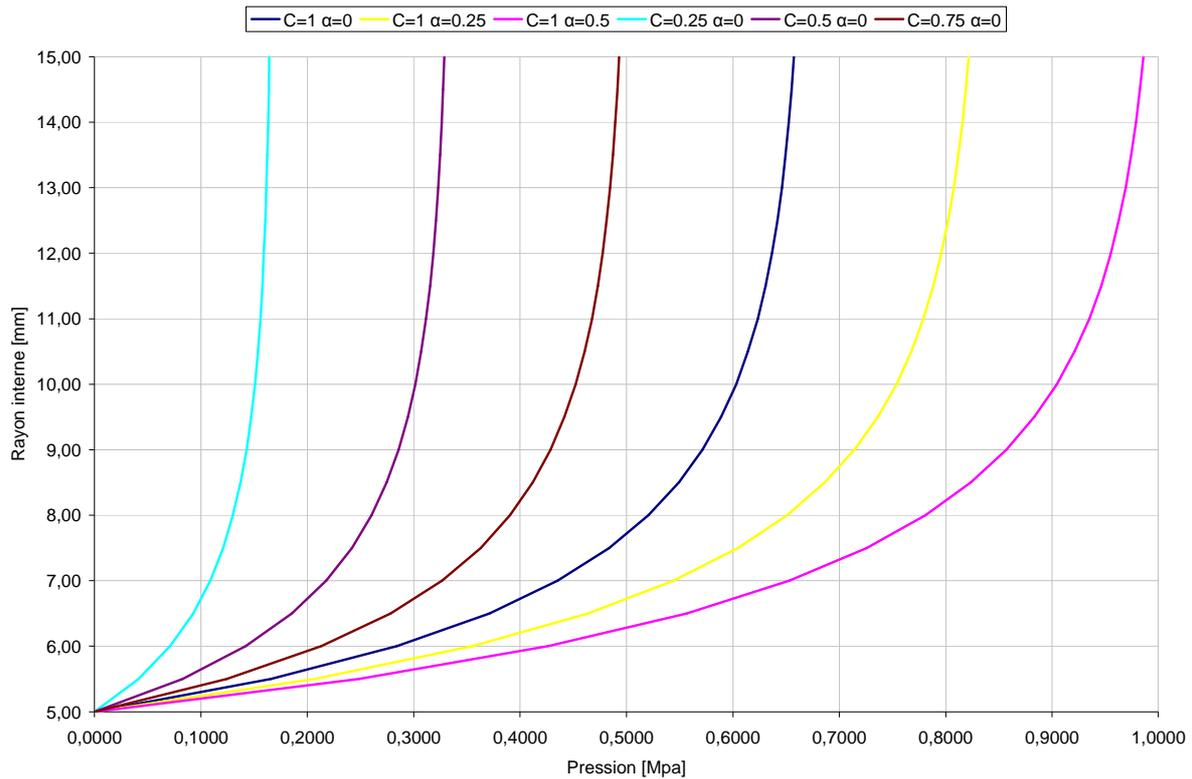
**Figure 105 :** Evolution du rayon d'un cylindre suivant le modèle analytique en fonction de la pression appliquée.
