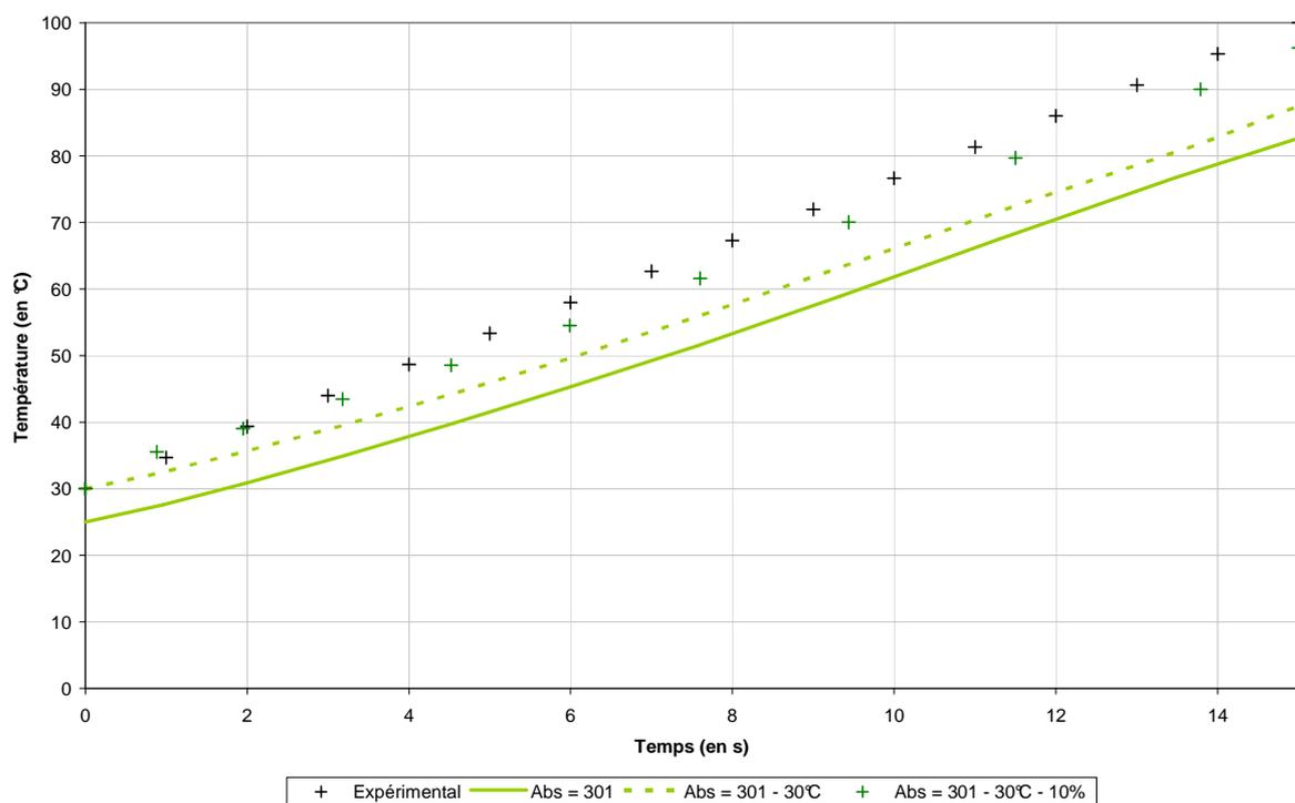
**Figure 86 :** Evolution à mi-hauteur de la préforme de la température en face interne côté lampe pour un coefficient d'absorption moyen de 300 /m et pondéré de 10% pour la réflexion.
