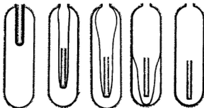
Figure 96 : Modélisation 2D de l'étirage soufflage avec une loi viscoélastique implantée dans le logiciel Forge2<sup>®</sup> [SCH-1996].
