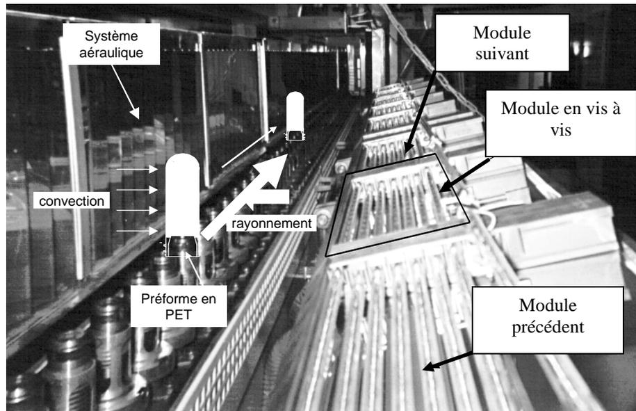
Figure 91 : Visualisation des modules successifs devant lesquels passe la préforme.
