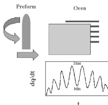
Figure 47 : Flux reçu par un point de la préforme au cours de son déplacement dans un module de four [HAB-1999].
