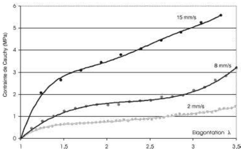
Figure 120 : Résultats caractéristiques de l'essai d'étirage à 100°C [CHE-2001].
