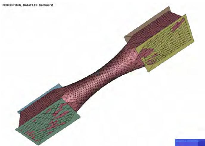
Figure 126 : Modèle complet de traction des éprouvettes sablier.
