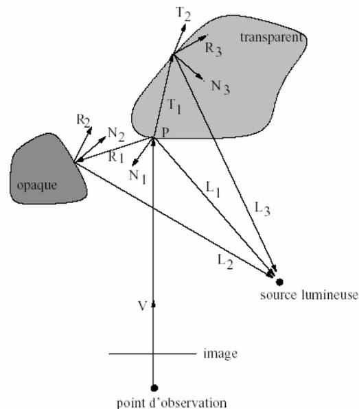
Figure 31 : Schéma de principe du lancer de rayons.
