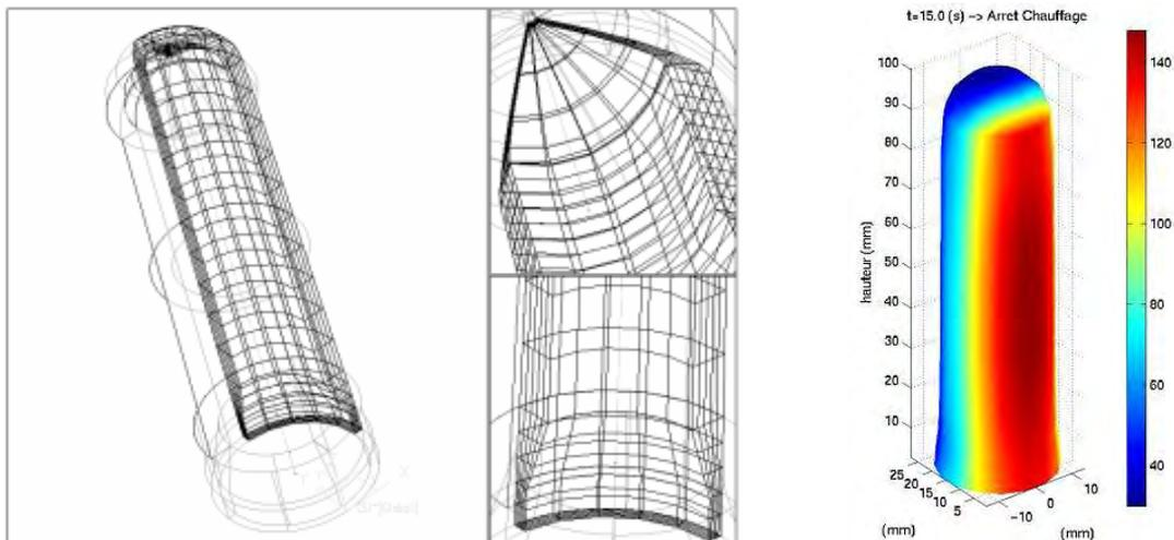
Figure 4 : Maillage et thermogramme caractéristique du chauffage d'une préforme [MON-2001].
