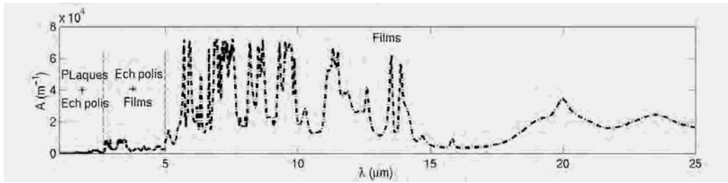
Figure 27 : Spectre d'absorption du PET [MON-2001].
