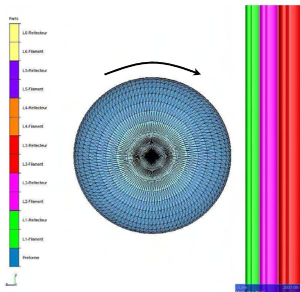
Figure 43 : Rotation de la préforme sans translation devant le four en vue de dessus.
