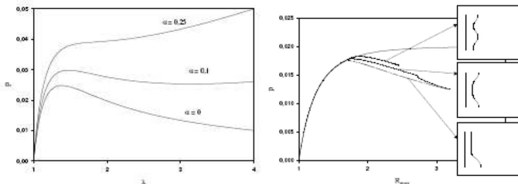
Figure 113 : Solution du soufflage d'une membrane sphérique et d'un cylindre infini [CHE-2002].
