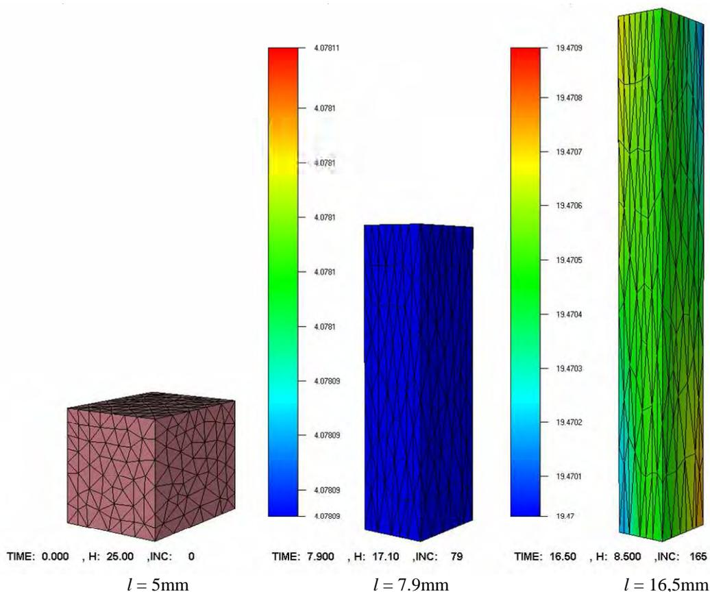
**Figure 123 : Modèle numérique de l'essai de traction uniaxiale (contrainte verticale).**
