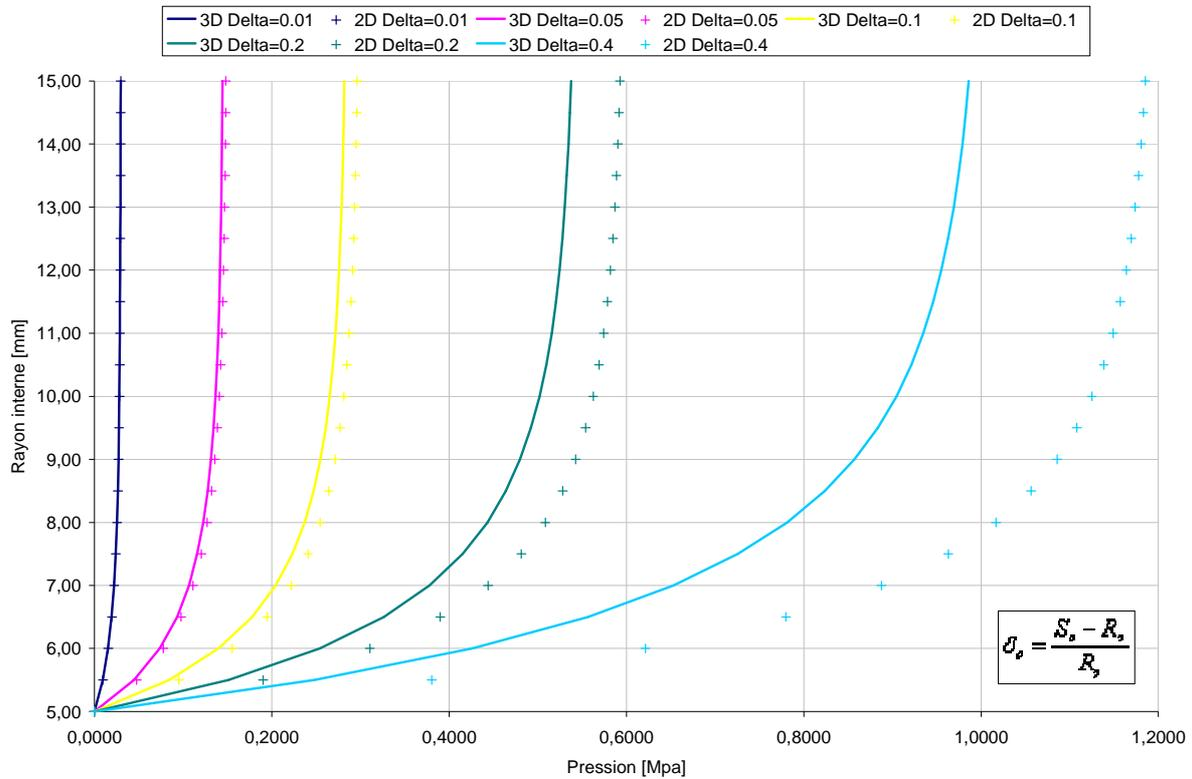
**Figure 106 :** Evolution analytique du rayon d'un cylindre en fonction de la pression appliquée pour différentes valeurs de  $\delta_0$  dans le cadre d'une loi de Mooney-Rivlin ( $C=1, \alpha=0.5$ ).
