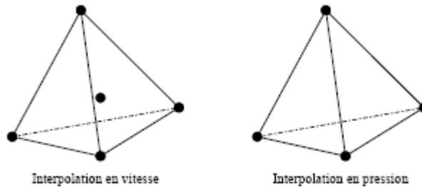
Figure 98 : Schéma de principe de l'élément P1+/P1.
