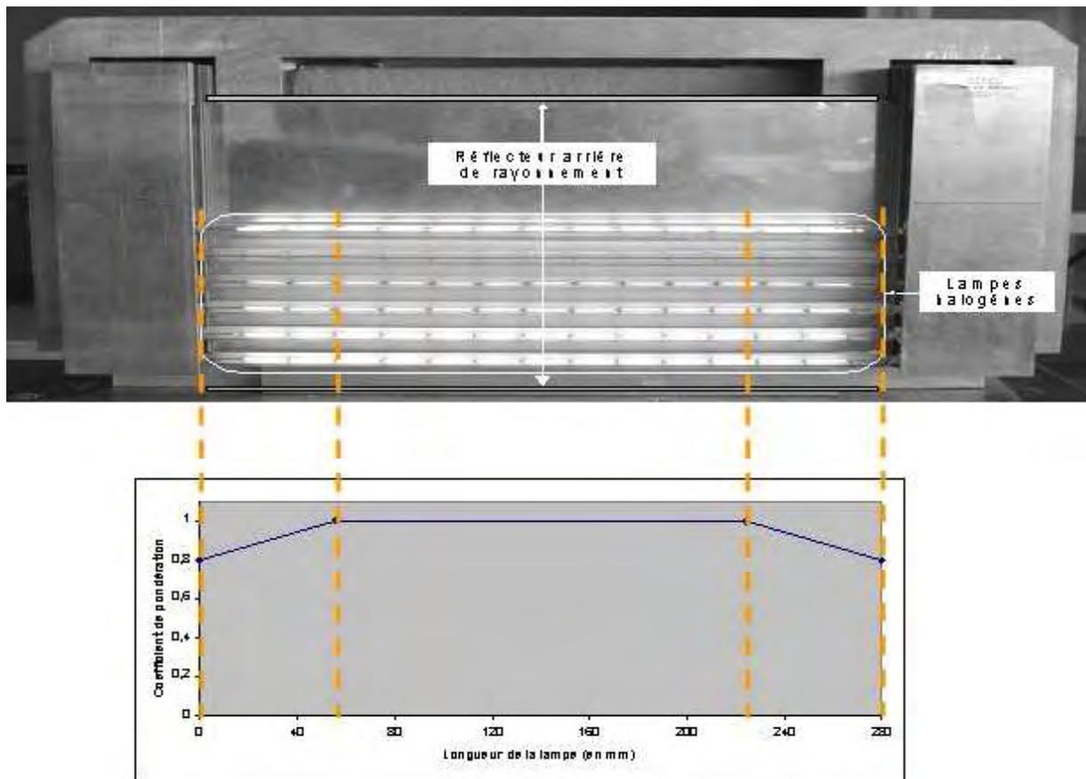
Figure 48 : Evolution du coefficient de pondération en fonction de la position de la préforme dans le four.
