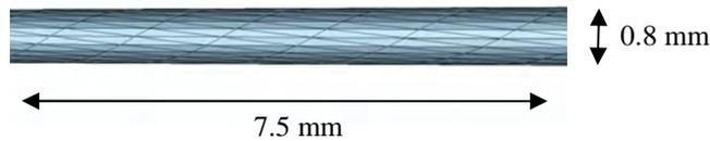
Figure 53 : Maillage du tube émetteur (représentation partielle).
