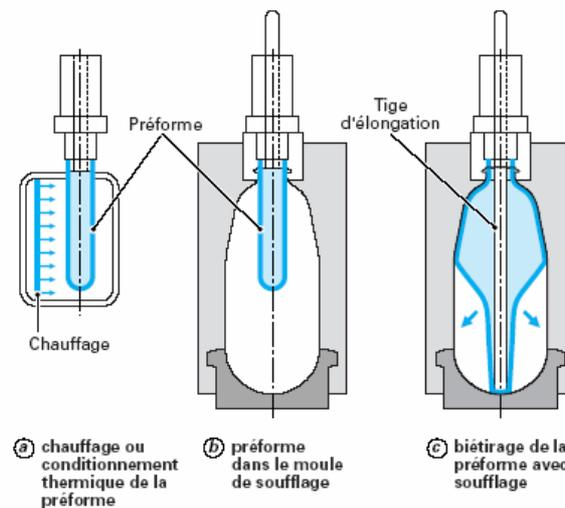
Figure 3 : Réchauffage et étirage-soufflage de la préforme [DEN-1989].
