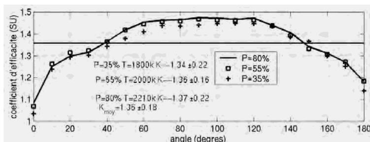
Figure 73 : Coefficient d'efficacité directionnelle des réflecteurs diffus [MON-2001].
