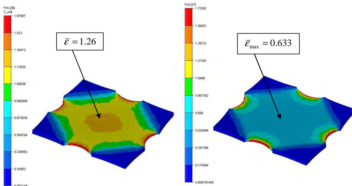
Figure 149 : Simulation d'un essai de traction biaxial [CHA-2007].
