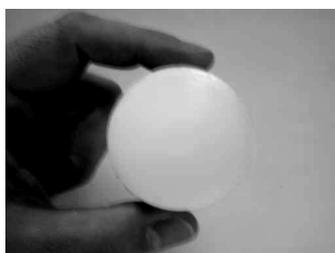
**Figure III.7** : Photographie d'un poly-HIPE de silice.
