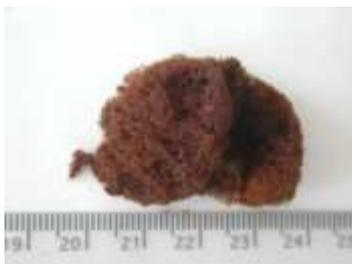
**Figure 7.6 :** Photographie d'un échantillon hybride [oxyde de vanadium-tergitol NP10] après lyophilisation.
