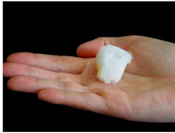
**Figure IV.12 :** Photographie d'une mousse de silice.
