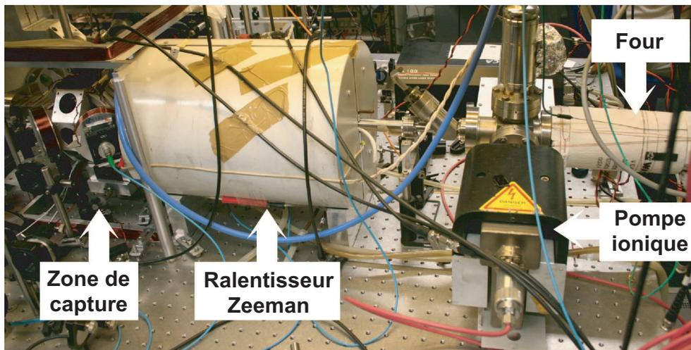
FIG. 4.3 – Photo du montage principal, comprenant le four principal, le ralentisseur Zeeman et la zone de capture et d'interrogation.
