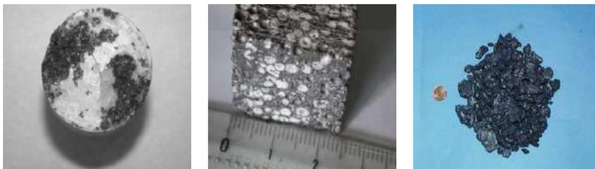
Figure 2.15 : A gauche : Vue d'un échantillon obtenu par infiltration [42] ; Centre : Echantillon élaboré par compression isostatique ; A droite : Granulés élaborés par fusion d'un mélange de graphite (GFG ou GN) et de sel en poudre.
