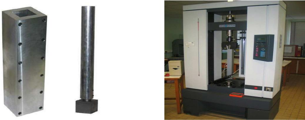
Figure 2.11 : Gauche : Moule creux et piston en aluminium (coté intérieur 50 mm, hauteur 350 mm) ; Droite : Machine de traction - compression.
