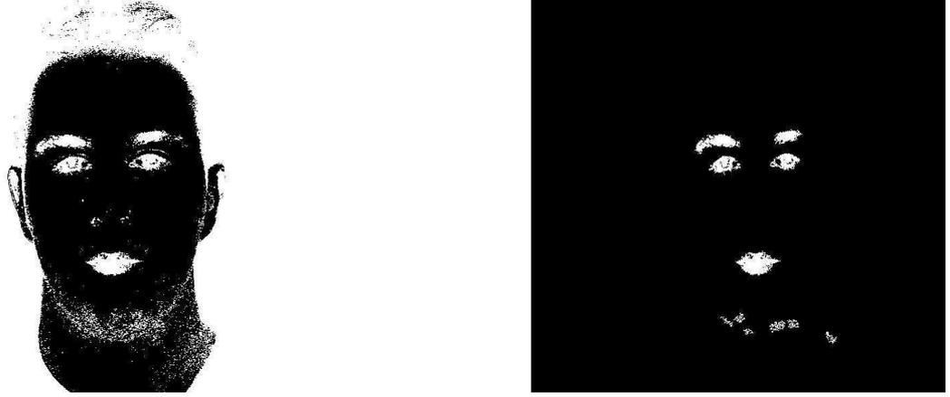
FIG. 7.3 – Recherche des yeux potentiels. De gauche à droite : résultat de la détection de la peau et les zones représentant les yeux potentiels.
