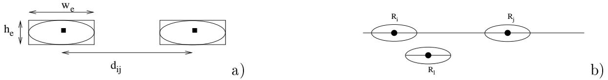
FIG. 7.4 – Règles utilisées pour la détection des yeux. (a) : la distance inter-oculaire est proportionnelle à la taille des yeux ; (b) : les axes des deux ellipses sont alignés.
