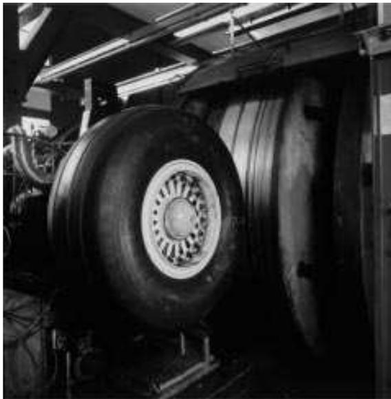
(a) Banc d'essai pour l'analyse des vibrations
