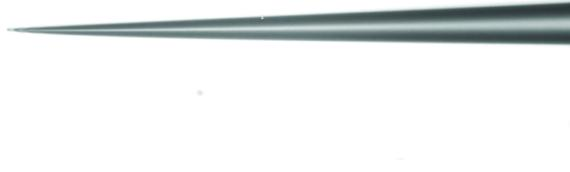
FIG. 2. Image au Microscope Reichert-Jung d'une fibre effilée.
