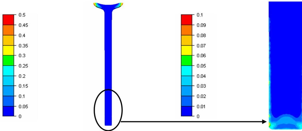
Figure 5.21 : Critère de Latham et Cockroft normalisé (OP3 - lopin de diamètre 13 mm)
