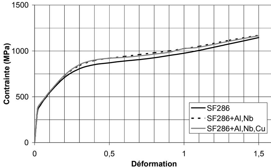
Figure 4.8 : Courbes de compression à température ambiante des trois nuances
