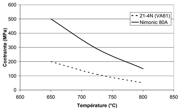
**Figure 2.8 : Caractéristiques de fluage comparées de l'alliage 21-4N (VA61) et du Nimonic Rupture à 1000 heures [KOZ]**
