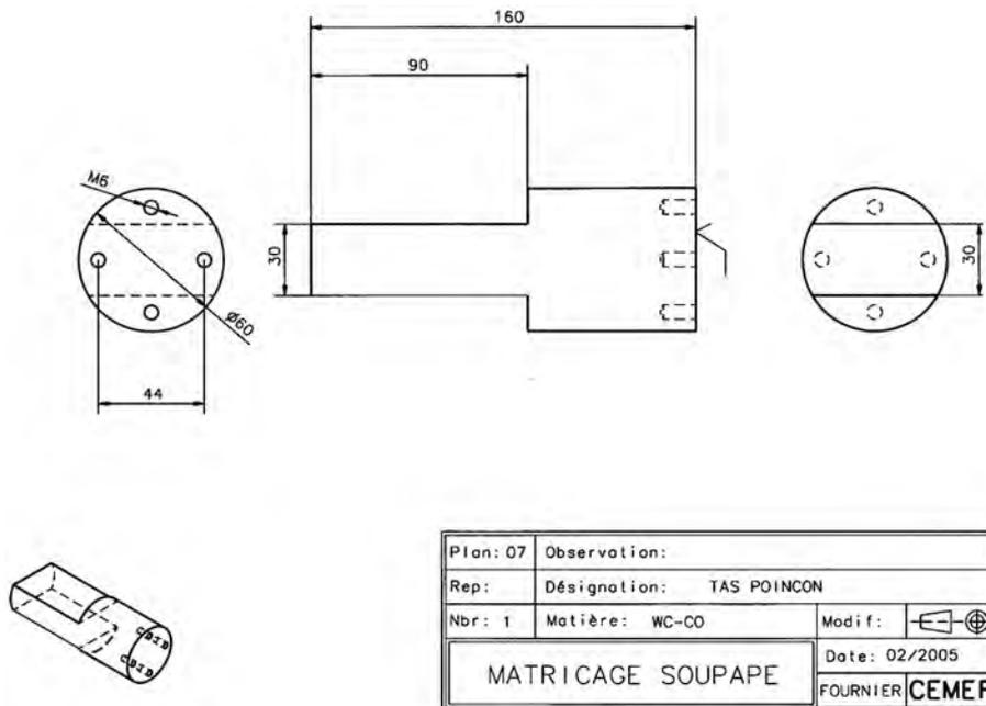
Figure 5.39 : Plan de détail de la pièce 1
