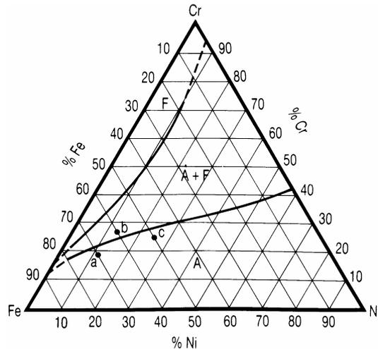
Figure 2.1 : Section à 1000 °C du diagramme ternaire Fe-Cr-Ni [BAV]
