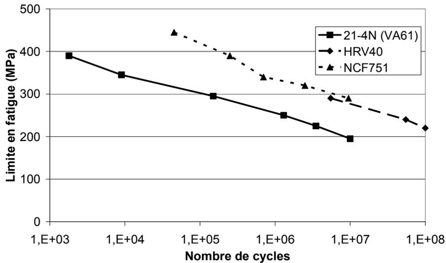
Figure 2.23 : Limite en fatigue mécanique à 800 °C des alliages 21-4N (VA61), HRV40 et NCF751 [HIT]
