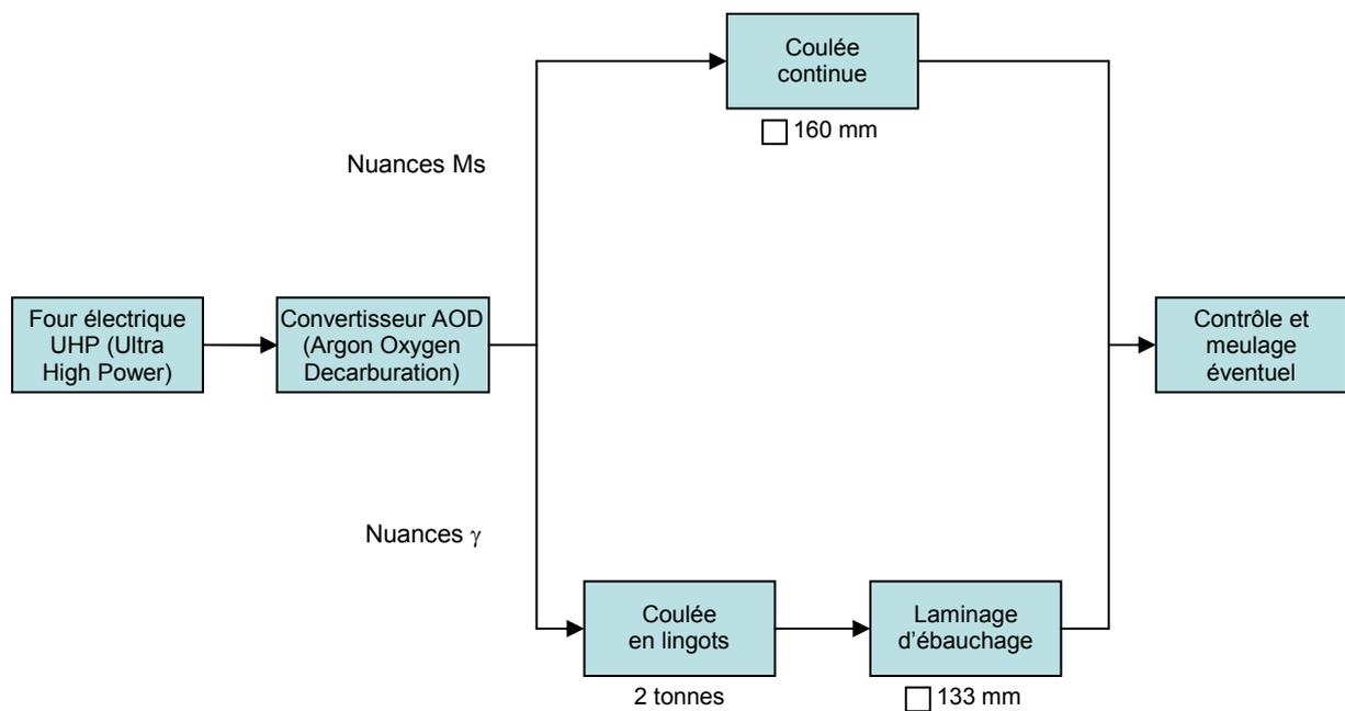
Figure 1.5 : Elaboration et pré-transformation des aciers à soupapes
