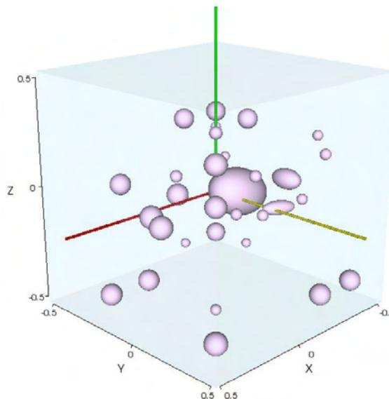
Figure 5.34 : Représentation des particules dans le VER adimensionnel
