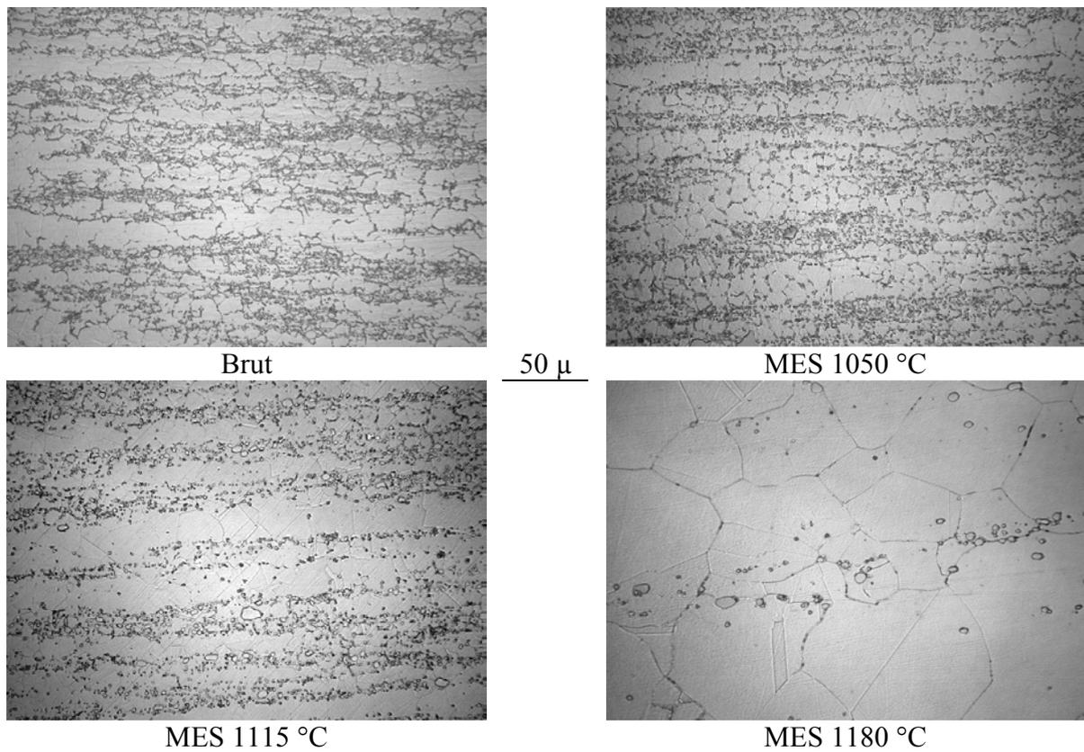
**Figure 3.6 : Structure des échantillons de VA61 (microscopie optique)**
