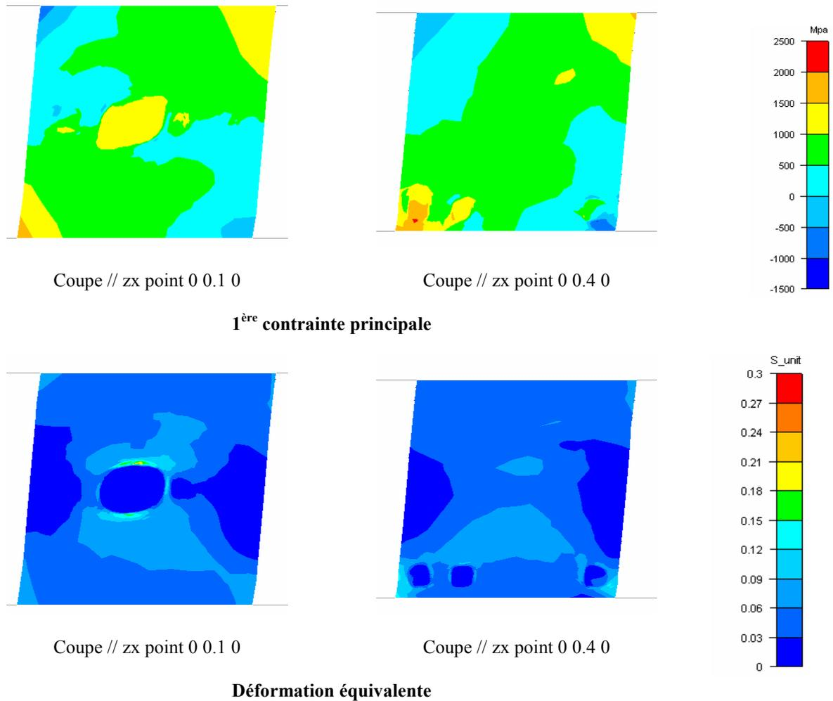
**Figure 5.37 : Simulation du cisaillement du VER adimensionnel**
