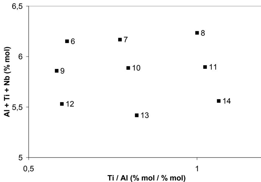
Figure 2.11 : Ratio Ti / Al et quantité Ti + Al + Nb des alliages expérimentaux [UET<sub>1</sub>]
