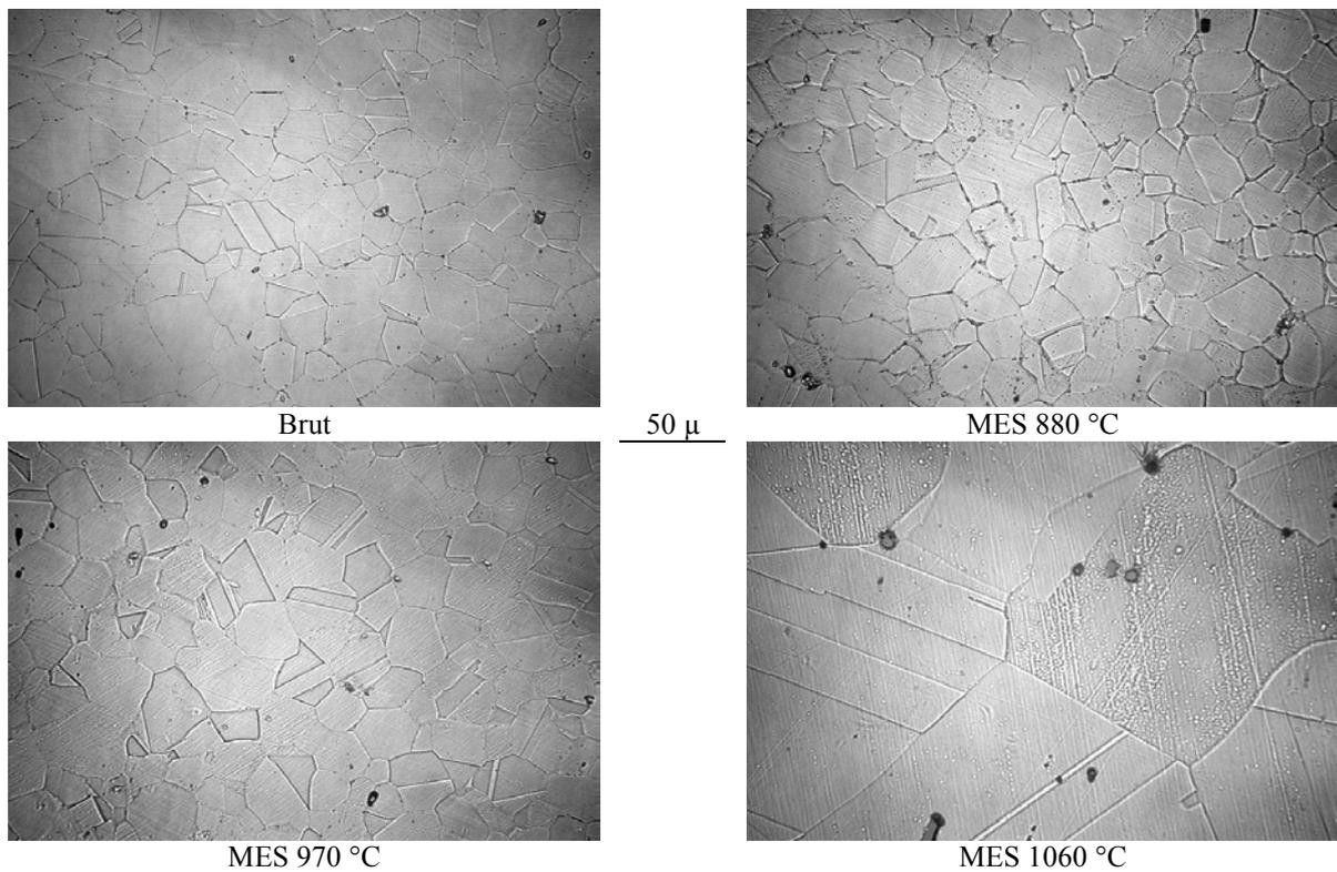
**Figure 3.8 : Structure des échantillons de SF286 (microscopie optique)**
