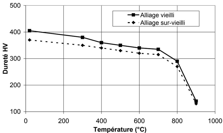
Figure 2.17 : Dureté à chaud de l'alliage NCF2415C [UET<sub>1</sub>]
