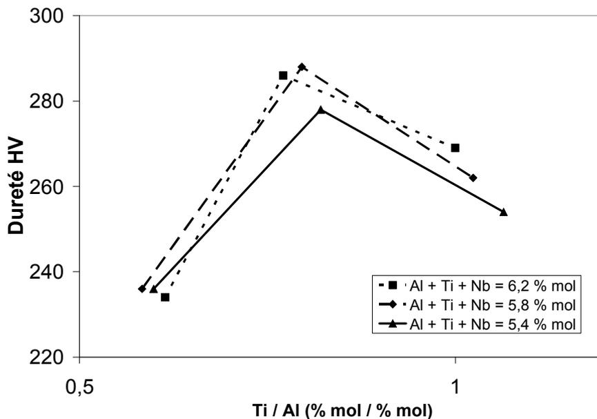
Figure 2.15 : Effet des éléments Al, Ti et Nb sur la dureté après sur-vieillissement [UET<sub>1</sub>]
