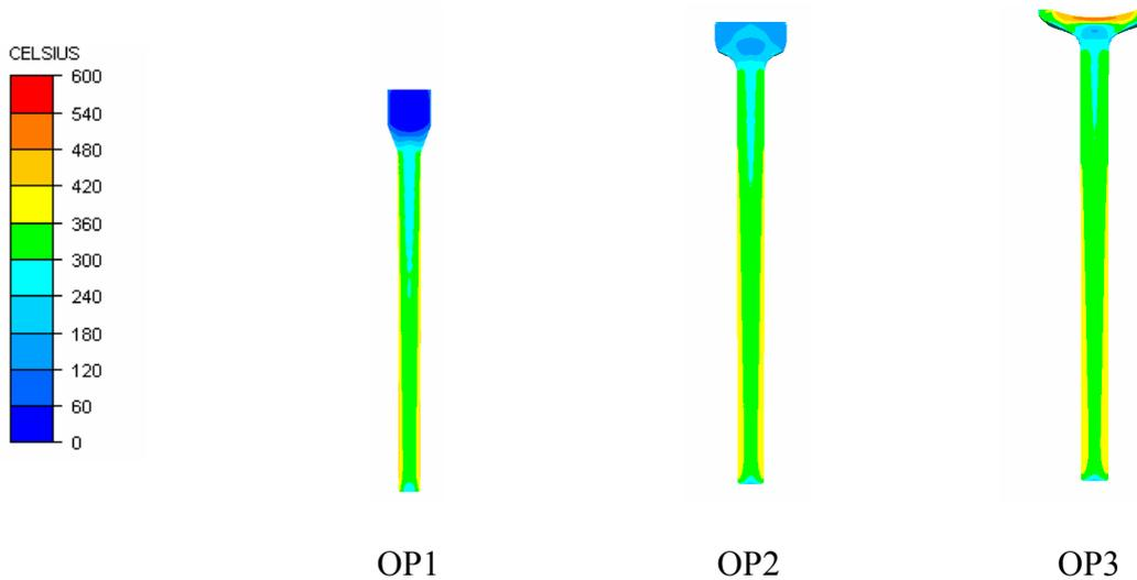
Figure 5.19 : Champs de température (lopin de diamètre 13 mm)
