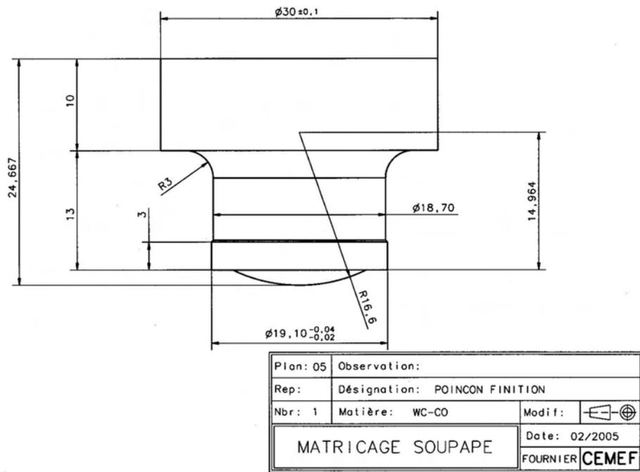
Figure 5.41 : Plan de détail de la pièce 3
