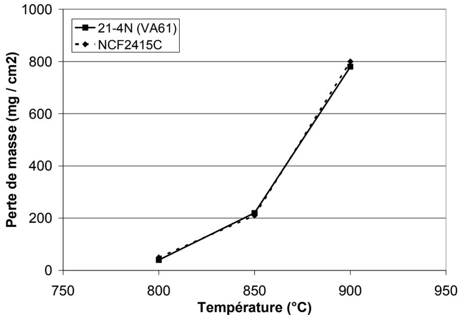
Figure 2.20 : Résistance à la corrosion par l'oxyde de plomb des alliages 21-4N (VA61) et NCF2415C
