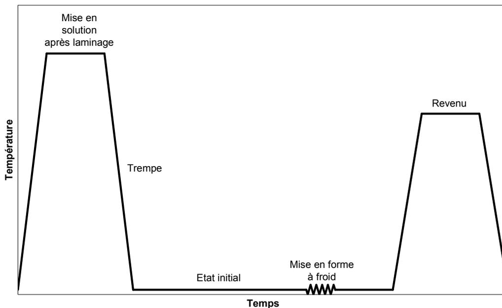
Figure 1.8 : Mise en forme à froid des soupapes
