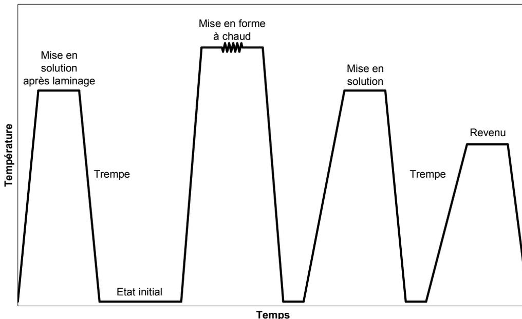
**Figure 1.7 : Mise en forme à chaud des soupapes**
