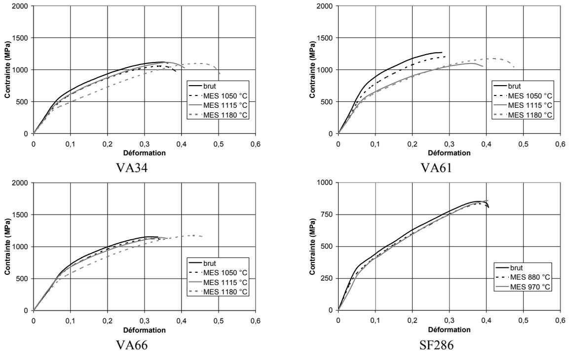
Figure 3.19 : Courbe de traction à 400 °C des différentes nuances
