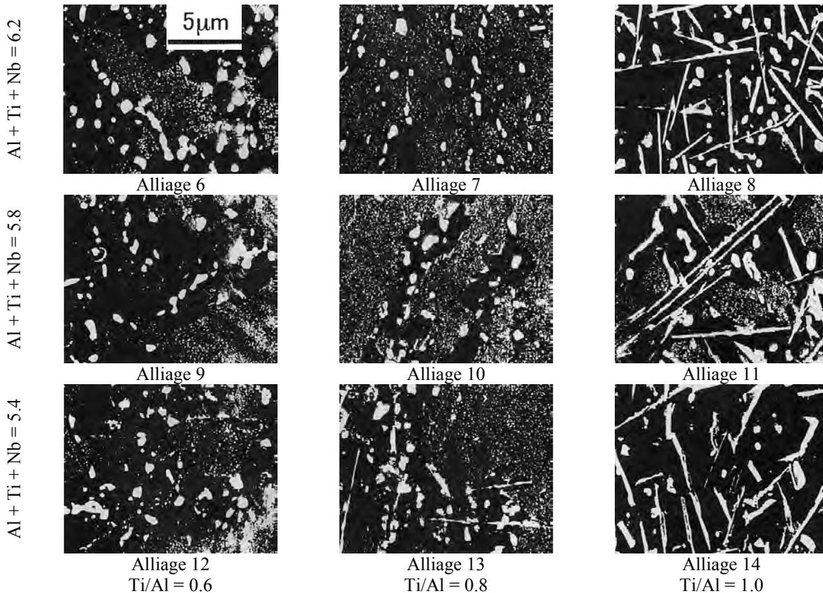
Figure 2.16 : Effet des éléments Al, Ti et Nb sur la microstructure [UET<sub>1</sub>]
