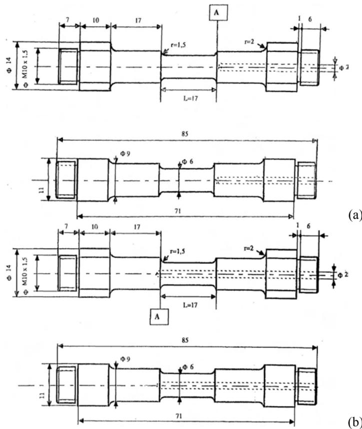
Figure 3.4 : Schéma de l'éprouvette de torsion
