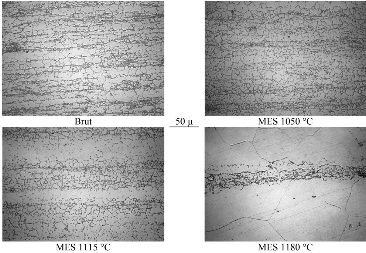
**Figure 3.5 : Structure des échantillons de VA34 (microscopie optique)**
