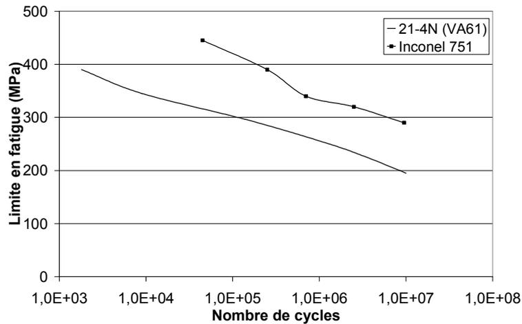
Figure 2.10 : Limite en fatigue à 800 °C des alliages 21-4N (VA61) et Inconel 751 [HIT]
