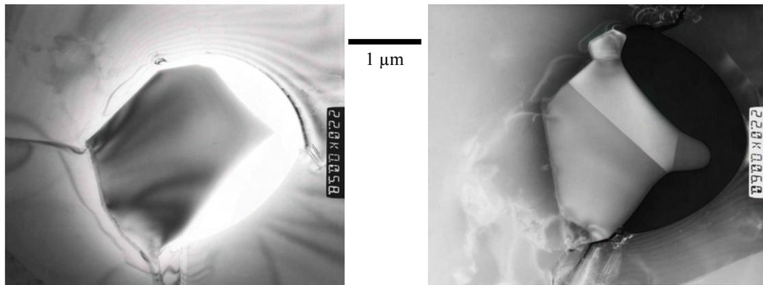
Figure 3.13 : Examen au MET de carbures dans un échantillon de VA61
