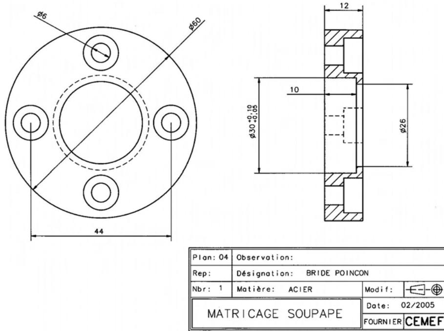
Figure 5.40 : Plan de détail de la pièce 2
