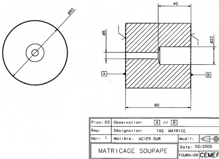
Figure 5.45 : Plan de détail de la pièce 7
