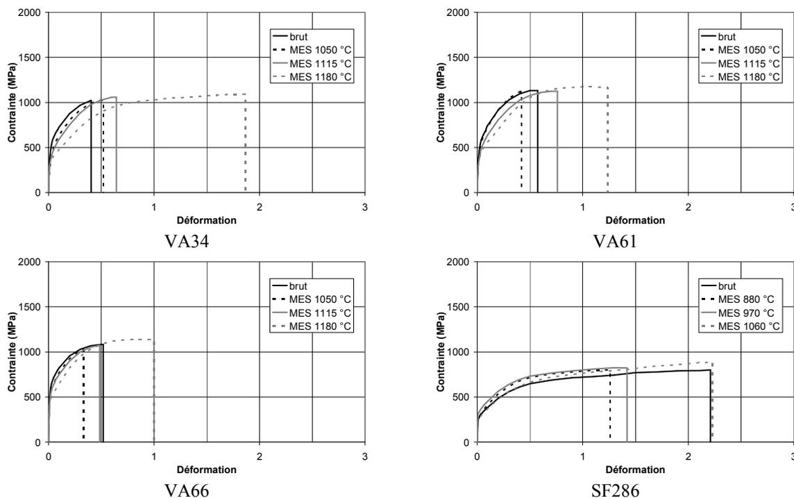
Figure 3.28 : Courbes de torsion ( $0,1 \text{ s}^{-1}$ ) à  $400 \text{ °C}$  des différentes nuances
