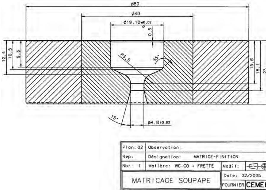
Figure 5.43 : Plan de détail de la pièce 5
