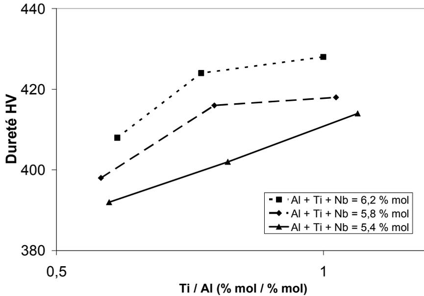
Figure 2.14 : Effet des éléments Al, Ti et Nb sur la dureté après vieillissement [UET<sub>1</sub>]
