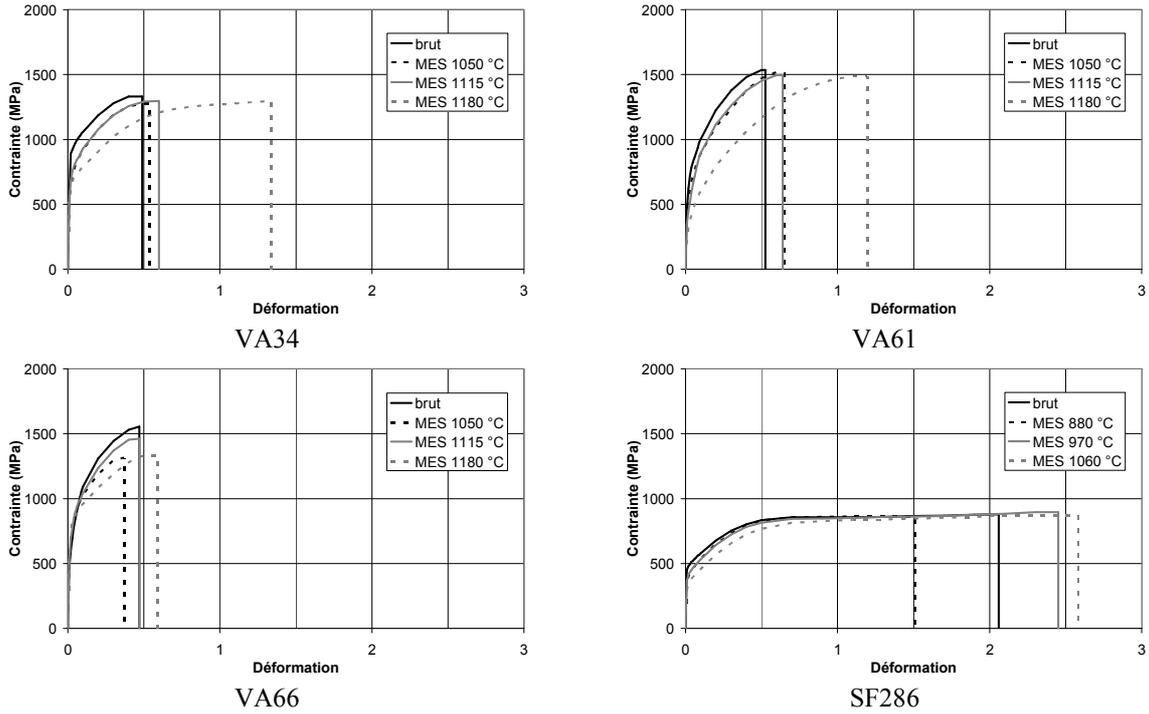
Figure 3.26 : Courbes de torsion ( $0,1 \text{ s}^{-1}$ ) à température ambiante des différentes nuances
