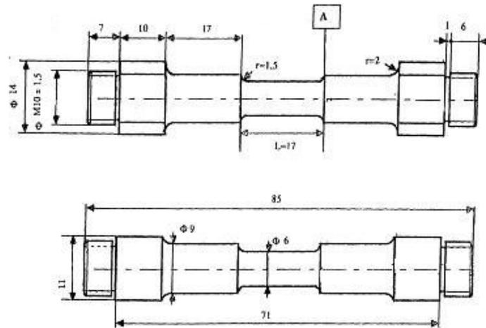
Figure 3.2 : Schéma de l'éprouvette de traction
