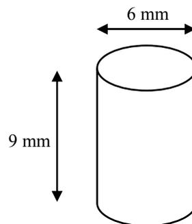
Figure 3.3 : Schéma de l'éprouvette de compression
