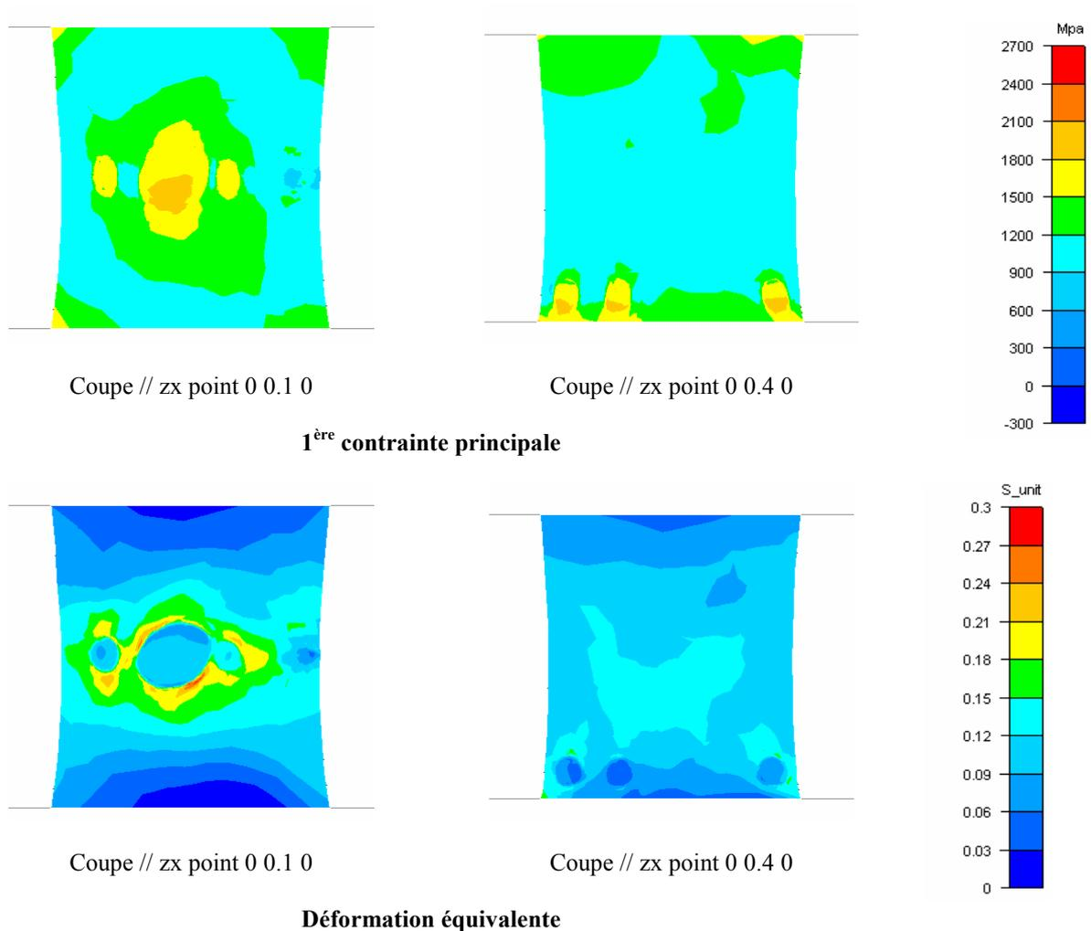
Figure 5.36 : Simulation de la traction du VER adimensionnel
