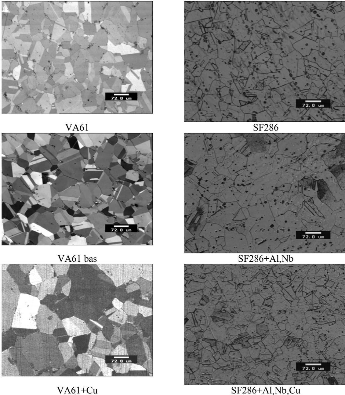
Figure 4.9 : Microstructure des différents échantillons
