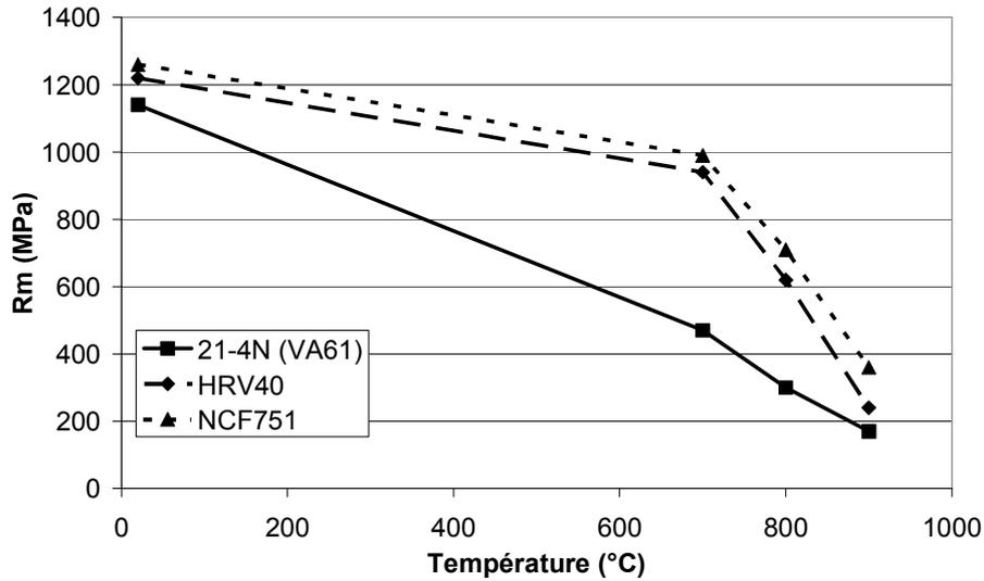
Figure 2.22 : Limite à rupture Rm des alliages 21-4N (VA61), HRV40 et NCF751 [HIT]
