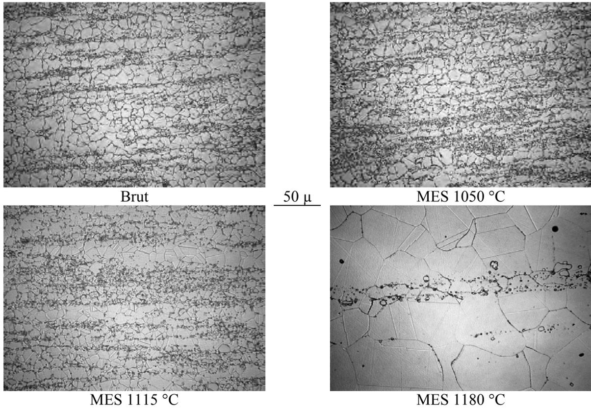
**Figure 3.7 : Structure des échantillons de VA66 (microscopie optique)**
