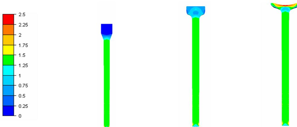
Figure 5.18 : Champs de déformation (lopin de diamètre 13 mm)
