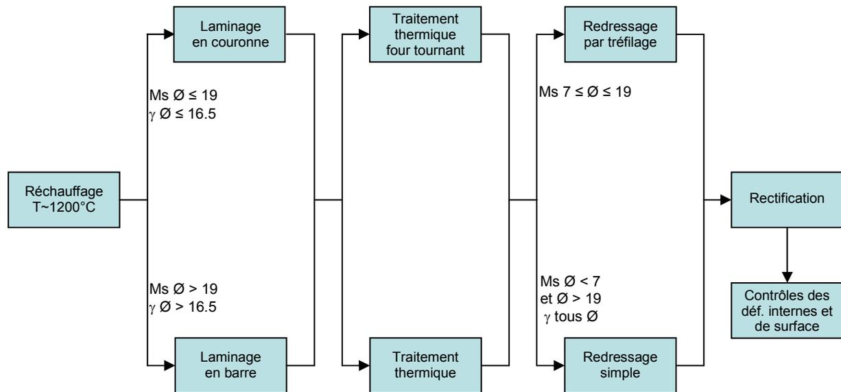
Figure 1.6 : Elaboration et pré-transformation des aciers à soupapes
