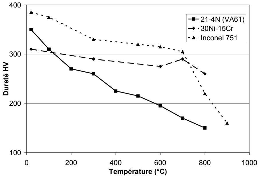
Figure 2.24 : Dureté HV des alliages 21-4N (VA61), 30Ni-15Cr et Inconel 751
