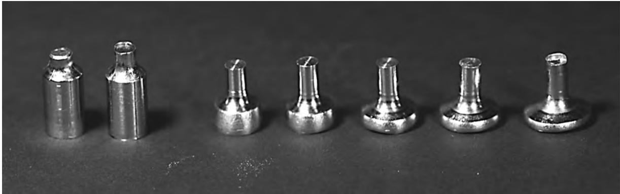
**Figure 5.46 : Gamme de mise en forme de soupapes en laboratoire**
