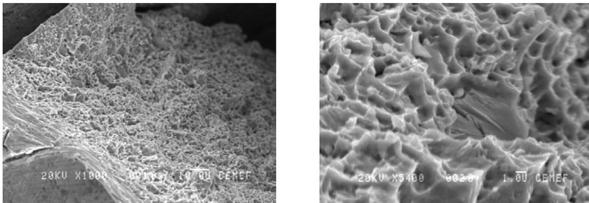
**Figure 3.24 : Observation des faciès de rupture d'un échantillon de VA61 au MEB**
