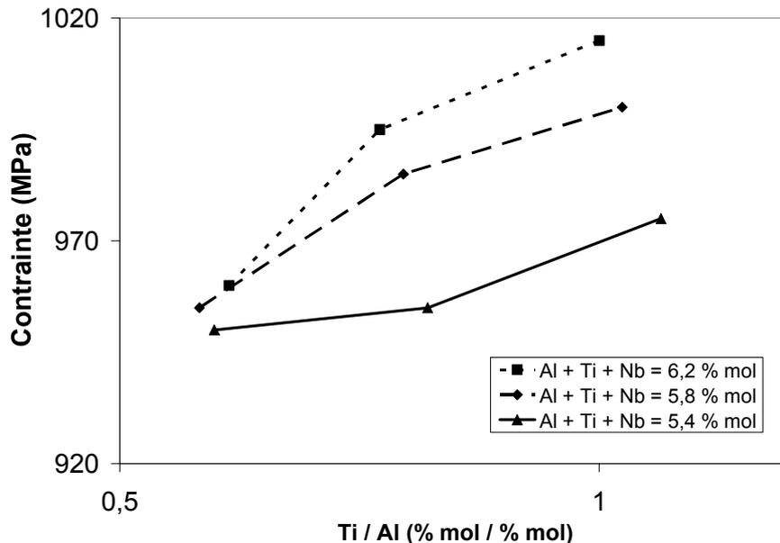
**Figure 2.13 : Effet des éléments Al, Ti et Nb sur les niveaux de contrainte correspondant à une déformation  $\varepsilon = 1$  [UET<sub>1</sub>]**
