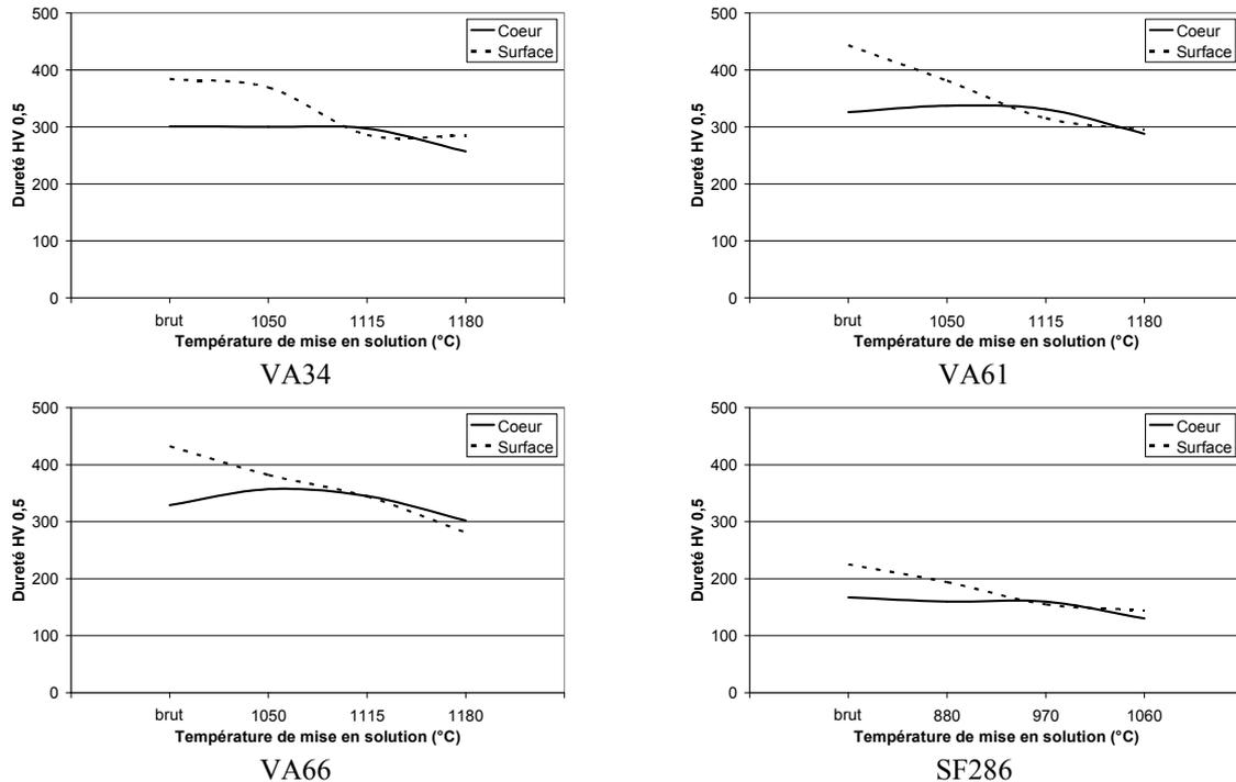
Figure 3.34 : Courbes de dureté des différentes nuances
