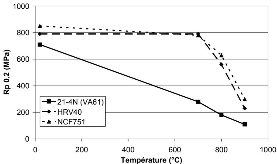
**Figure 2.21 : Limite élastique Rp 0,2 des alliages 21-4N (VA61), HRV40 et NCF751 [HIT]**
