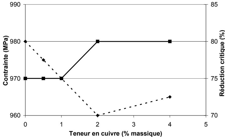
Figure 2.12 : Effet de l'addition de cuivre sur la déformabilité à froid [UET<sub>1</sub>]
