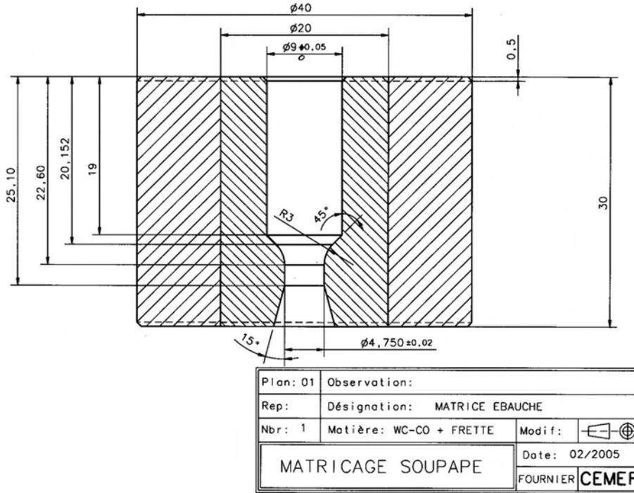
Figure 5.44 : Plan de détail de la pièce 6
