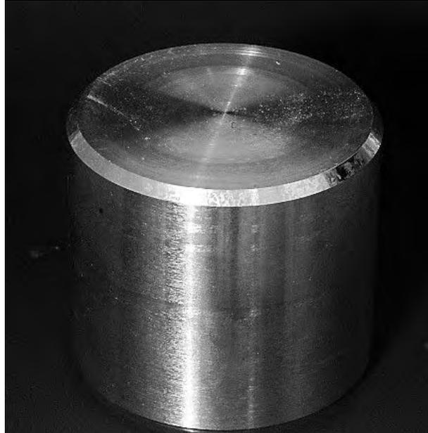
Figure 4.5 : Vue du lopin après usinage
