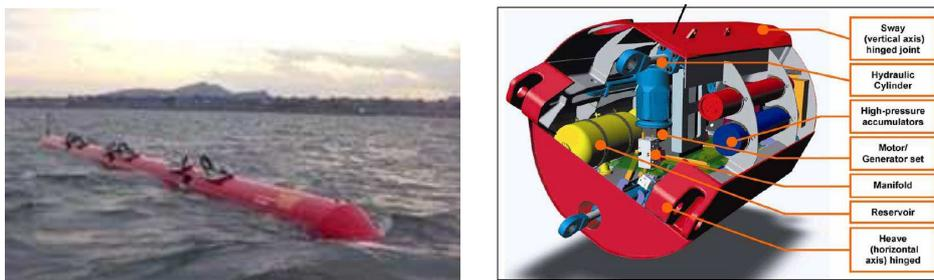
FIG. 1.16 – Photo du système Pelamis et schéma de l'articulation
