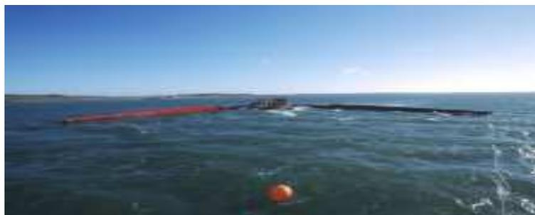
FIG. 1.9 – Photographie du Wave Dragon à échelle réduite (58 x 33 m), courtesy of Wave Dragon [Soe05]
