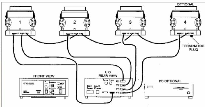
Figure 5.1: Système STACIS 2000 Figure 5.2: Contrôleur communiquant avec 4 isolateurs
