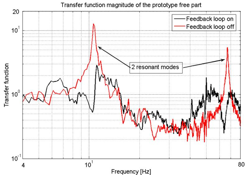
Figure 5.30: Fonction de transfert des vibrations de la poutre encastrée-libre avec la combinaison du système STACIS et de l'algorithme de contrôle actif
