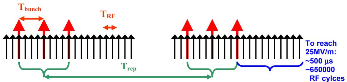
Figure 2.6: Faisceau composé de deux trains eux-mêmes composés de plusieurs paquets
