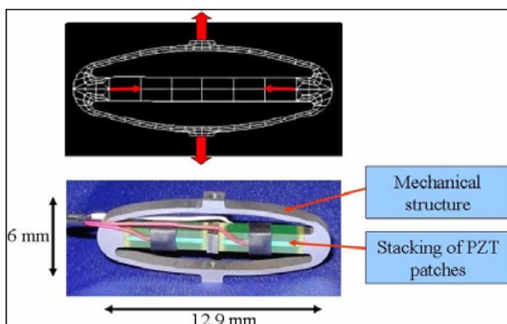
Figure 5.17: Schéma et photographie de l'actionneur APA 25XS
