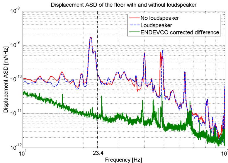
Figure 4.25: DSA du mouvement du sol avec et sans haut-parleur et Différence Corrigée des accéléromètres ENDEVCO 86
