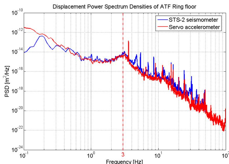
Figure 6.18: DSP du mouvement du sol à ATF mesurées avec un sismomètre de type STS-2 et un accéléromètre servo
