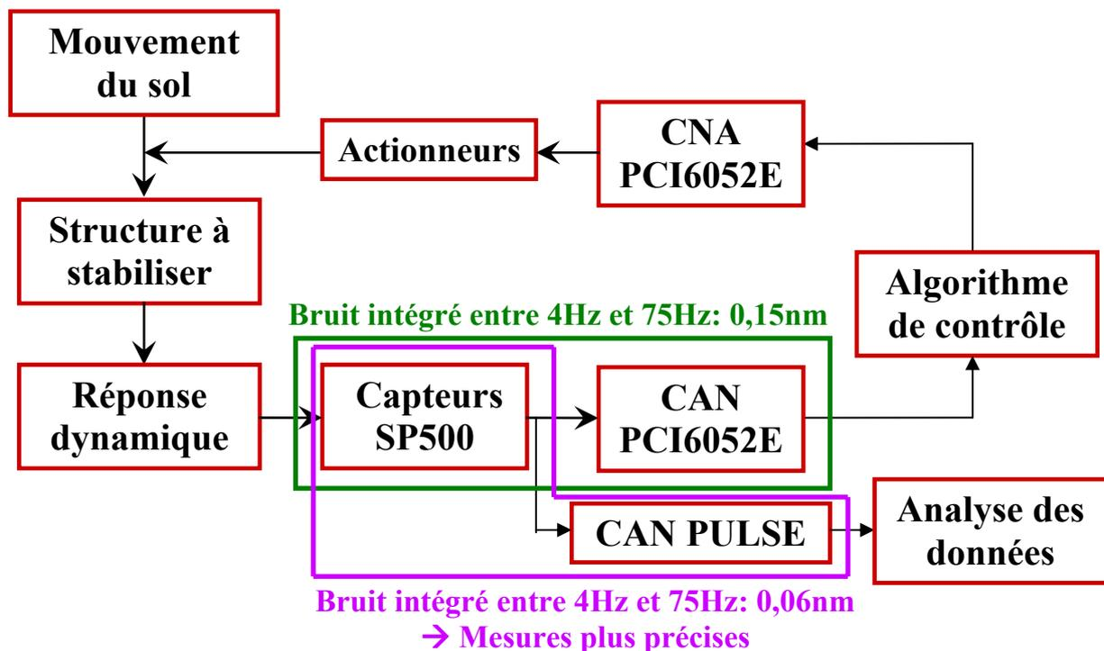
Figure 5.23: Schéma de l'instrumentation utilisée pour le rejet actif et l'analyse des données
