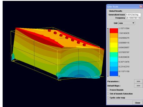
Figure 6.7: Bloc avec masses de 1400kg fixé à un point pour chaque angle
