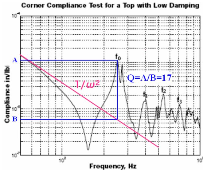
Figure B.2: Courbe de compliance mesurée par la société TMC pour une table en configuration libre ayant un amortissement faible et calcul du facteur Q d'amplification
