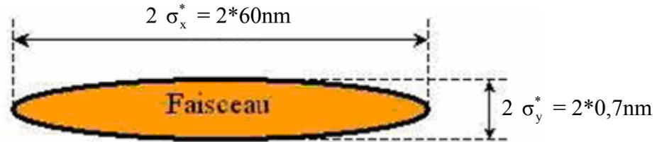
Figure 2.4: Coupe transversale du faisceau du projet CLIC
