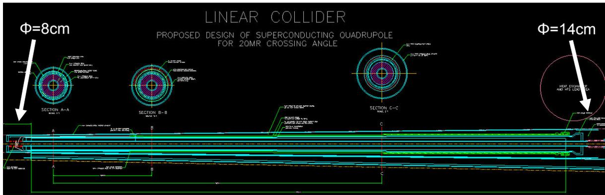
Figure 5.12: Conception d'un des deux derniers quadripôles du futur collisionneur linéaire réalisée par l'équipe de Brookhaven
