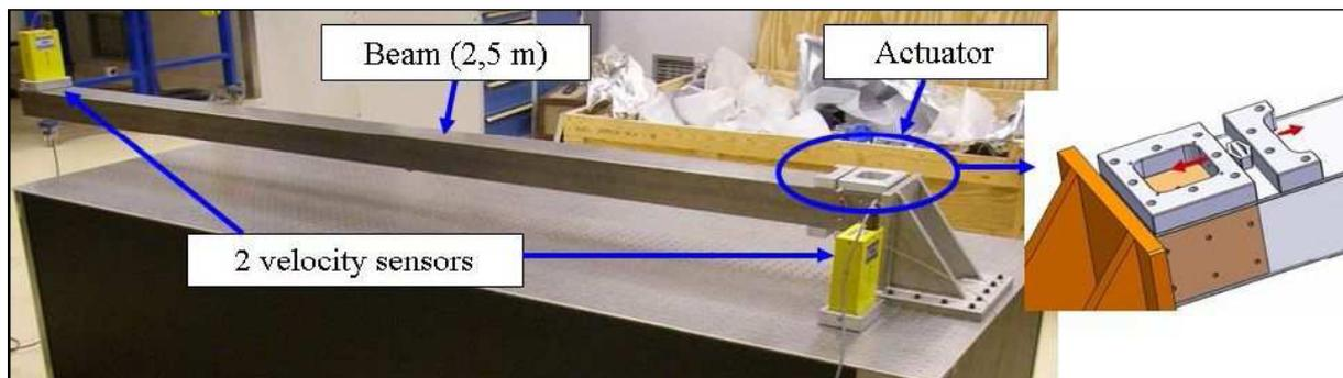
Figure 5.22: Prototype développé au LAPP composé de la poutre encastree-libre, de capteurs de vitesse SP500 et d'APAs 25XS en mode de flexion et en mode « proof mass »
