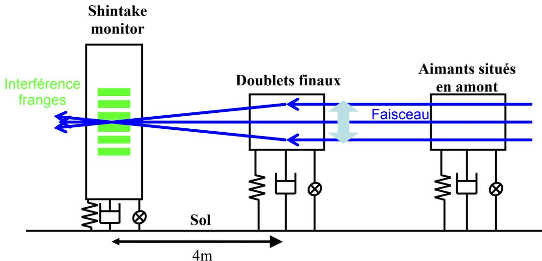
Figure 2.2: Schéma de la focalisation finale d'ATF2
