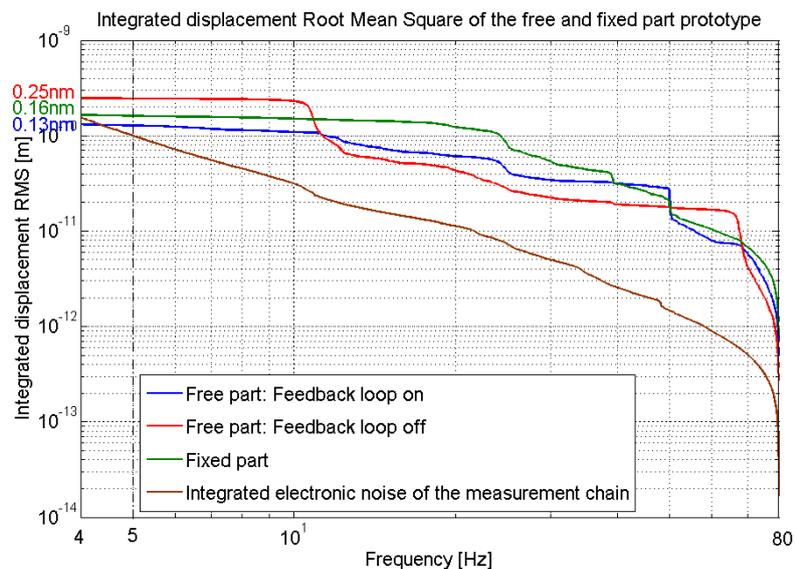
Figure 5.31: RMS intégré de déplacement de l'encastrement et de la partie libre de la poutre avec la combinaison du système STACIS et de l'algorithme de contrôle actif
