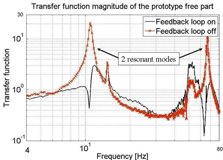
Figure 5.28: Fonction de transfert des vibrations de la poutre encastrée-libre avec et sans rejet actif de vibrations appliqué sur les deux premières résonances
