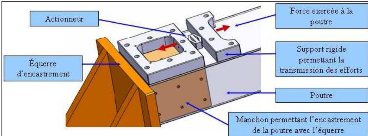
Figure 5.15: Principe d'application d'une force de flexion sur la poutre encastree-libre avec un APA
