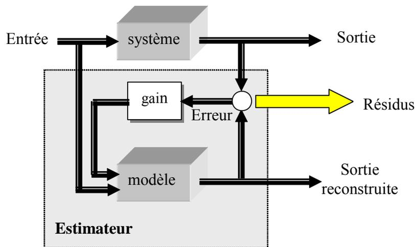
**Figure 2.4** : Principe général d'un estimateur de sortie
