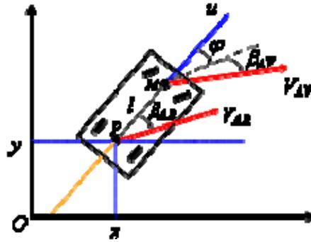
Figure 3.7 : Véhicule dérapant des quatre roues
