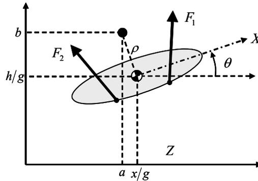
**Figure 3.3 :** Position du centre de poussée
