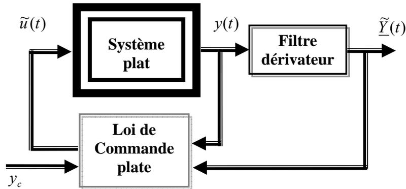
**Figure 5.1** : Mise en œuvre de la commande plate
