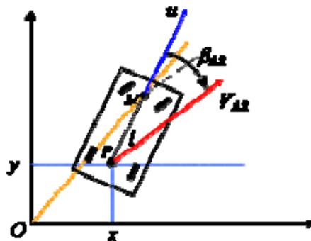
**Figure 3.6 :** Véhicule roulant avec roues arrière dérapant
