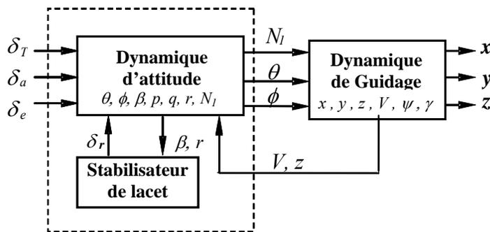
Figure 4.9 : Structure dynamique du vol d'un avion
