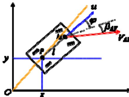
Figure 3.5 : Véhicule roulant avec roues avant dérapant
