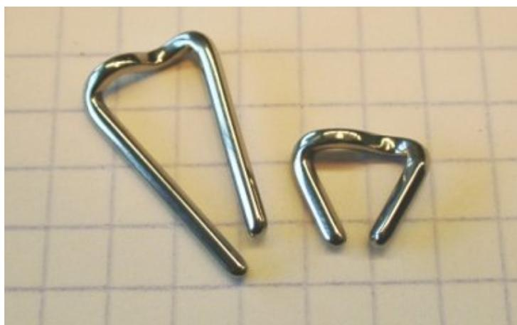
**FIG. 1.17:** Agrafes d'ostéosynthèse en Ni-Ti. (source : <http://www.nitifrance.com/>)
