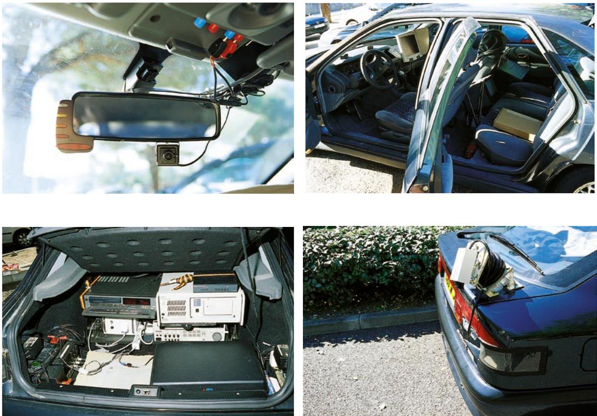
Figure 1-2: Equipement du Véhicule.
