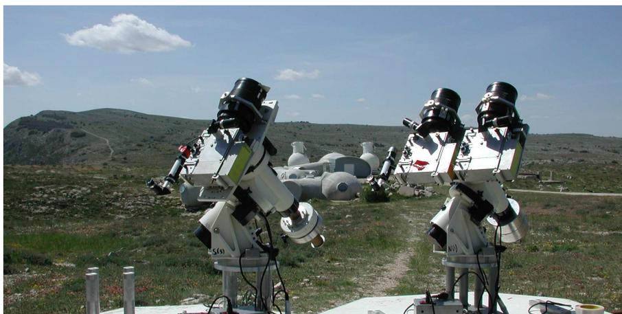
FIG. 2.1 – Trois modules de l'instrument Generalized Seeing Monitor (GSM) en premier plan et le Grand Interféromètre à 2 télescopes (GI2T) en arrière plan.
