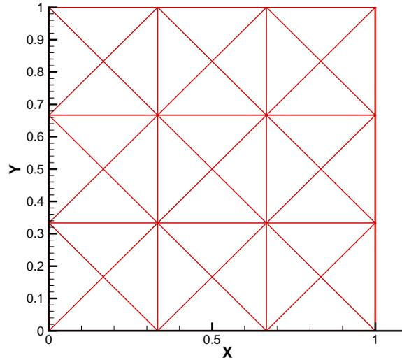
FIG. 6.1 – Maillage structuré de  $3 \times 3 \times 4$  soit 36 éléments
