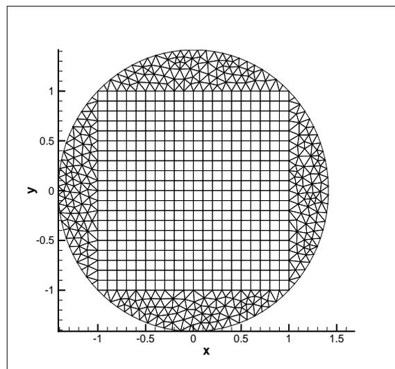
FIG. 3.8 – Un exemple de maillage hybride d'un disque.
