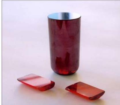
Figure 5 : Photographie d'un barreau de verre  $\text{Ge}_{20}\text{Ga}_5\text{Sb}_{10}\text{S}_{65}$
