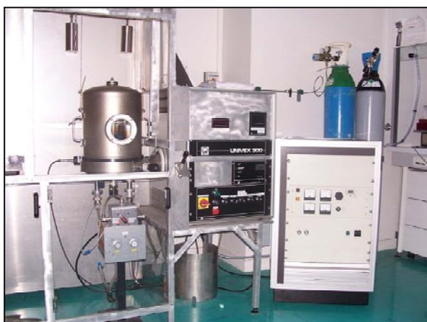
**Photographie 1 : Bâti de pulvérisation cathodique au Laboratoire**
