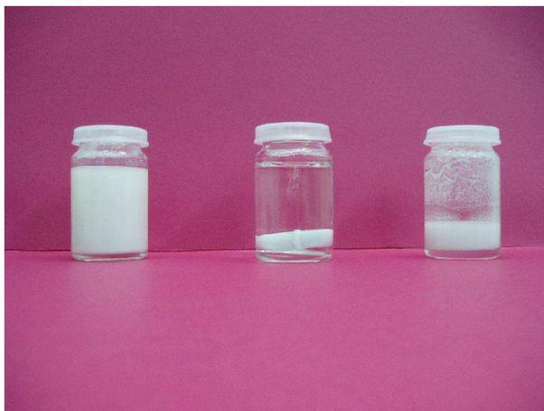
**Figure IV-2 : Evolution du sol ; (a) sol initial, (b) sol après 3h de vieillissement, (c) sol après 8 heures de vieillissement.**
