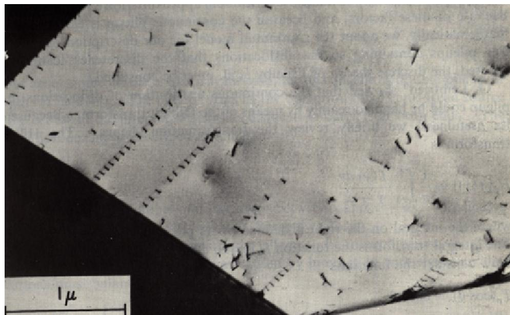
FIG. 7.1 – Empilement de dislocations à la frontière d'un grain d'alliage de cuivre et d'aluminium [Hirth et Lothe, 1968<sup>75</sup>] (microscope à transmission directe, haute résolution).
