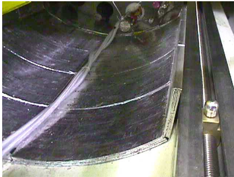
FIG. 4.3 – Photographie d'un blindage de plomb protégeant le DIRC.
