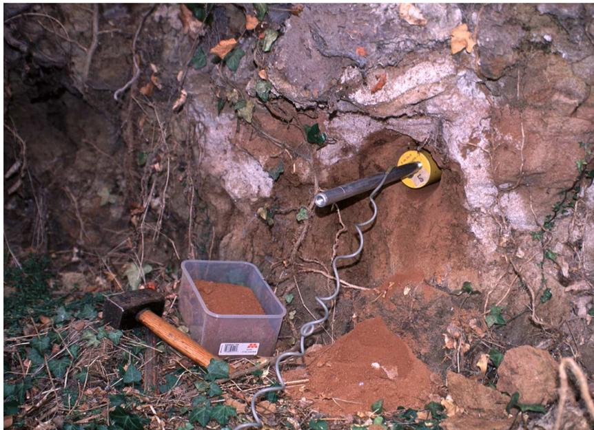
*Figure 5.8 : Photographie de l'affleurement de sédiment cuit au « Fraisse 1 ». La sonde du spectromètre de terrain a été introduite dans le trou même où a été prélevé l'échantillon C348 à dater.*
