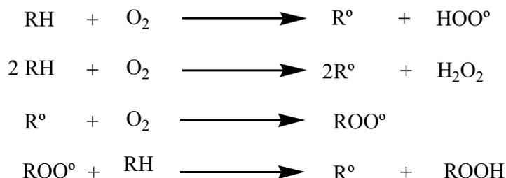
La phase d'initiation (première réaction) constitue alors l'étape limitante, défavorable thermodynamiquement à basse température. En revanche, la première étape de propagation (troisième réaction) est extrêmement rapide.
