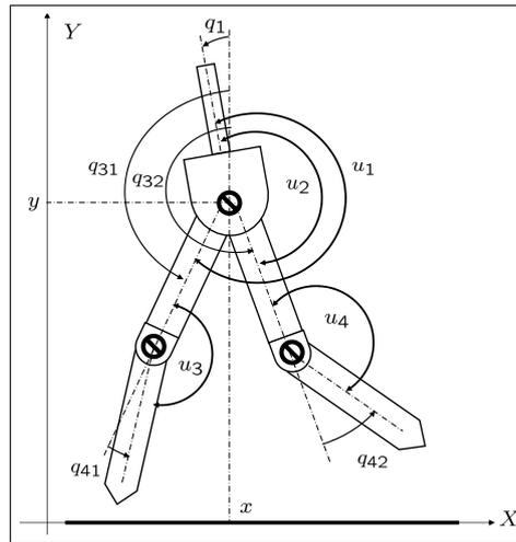
FIG. 2.6 – Définition des coordonnées généralisées et des couples
