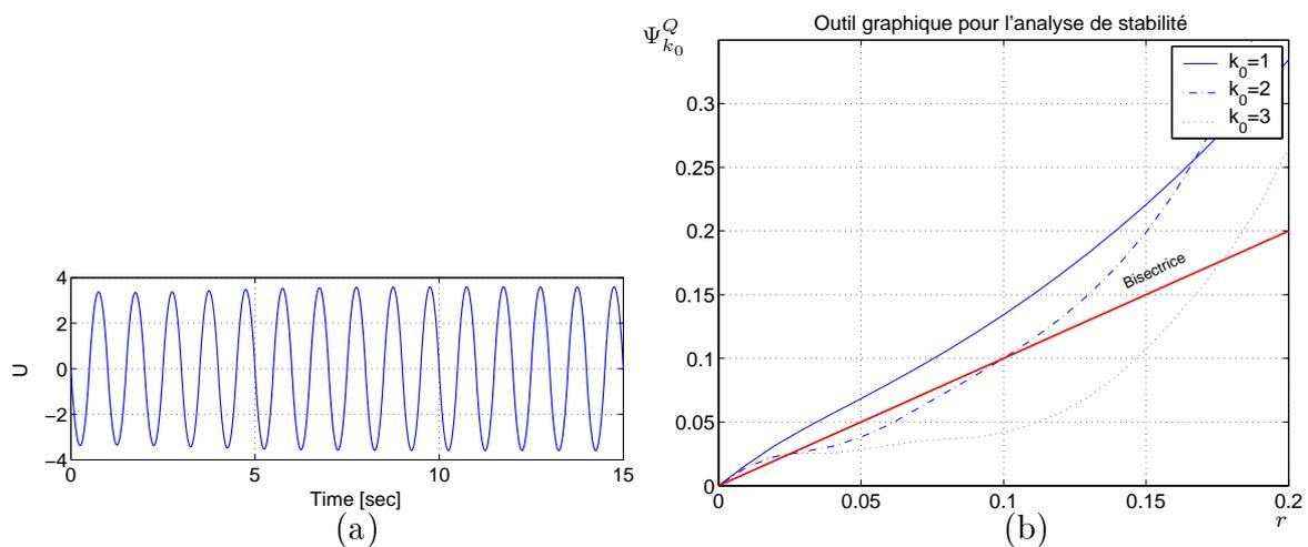
FIG. 3.11 – *Application 1 (génération de cycles limites): évolution dans le temps de l'entrée de commande (a), courbe d'analyse de stabilité (b): les condition suffisantes de stabilité du point 2 de la proposition 1 sont vérifiées pour  $k_0 = 2$  et 3*
