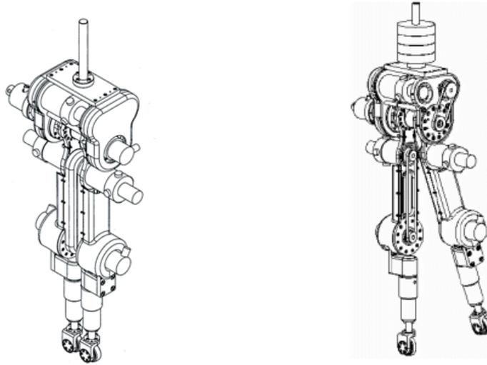
FIG. 2.2 – Schémas techniques du prototype RABBIT
