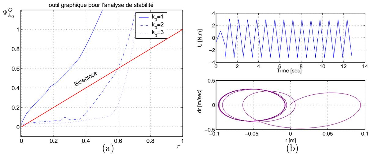
FIG. 3.19 – Application 2 (génération de cycles limites) : courbe d'analyse de stabilité (a) : les conditions suffisantes du point 2 de la proposition 1 sont vérifiées pour  $k_0 = 2,3$ , évolution de l'entrée de commande (b) haut, plan de phase de  $\eta$  (b) bas
