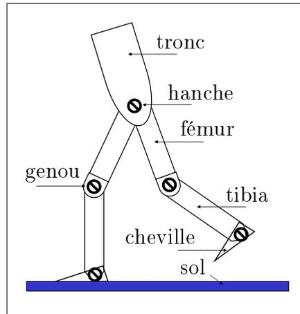
FIG. 1.4 – Structure simple d'un robot bipède
