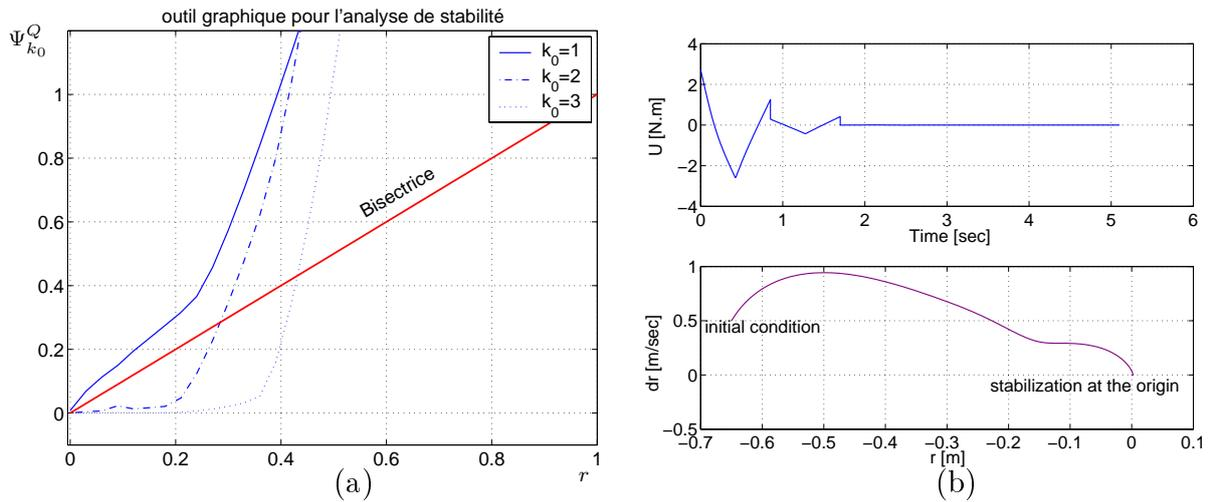
FIG. 3.16 – Application 2 (stabilisation): courbe d'analyse de stabilité: les conditions suffisantes du point 1 de la proposition 1 sont satisfaites pour  $k_0 = 2,3$  (a), évolution dans le temps de l'entrée de commande (b) haut, plan de phase de  $\eta$  (b) bas
