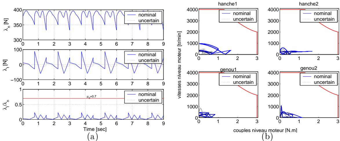
FIG. 5.41 – Scénario 5 (robustesse / incertitudes inertielles) : évolution des forces de contact avec le sol (a), admissibilité des puissances des moteurs actionneurs (b)
