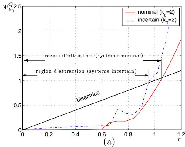
FIG. 3.29 – Application 3 (robustesse vis-à-vis des incertitudes paramétriques) : courbe d'analyse de stabilité pour le système nominal et incertain
