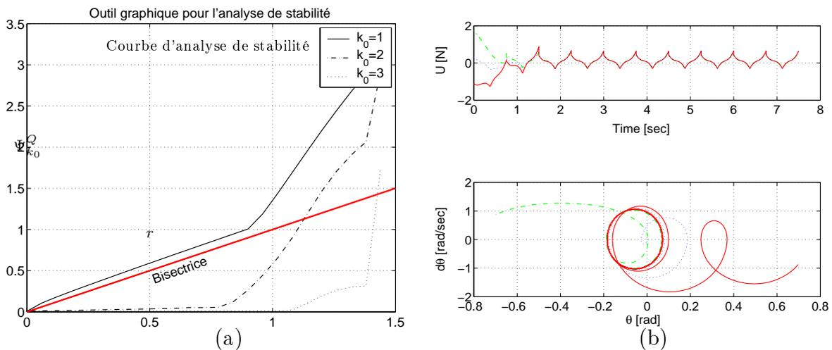
FIG. 3.30 – Application 3 (génération de cycles limites) : courbe d'analyse de stabilité (a) : les conditions suffisantes du point 2 de la proposition 1 sont vérifiées pour  $k_0 = 2,3$ , évolution de l'entrée de commande et plan de phase de  $\eta$  (b)
