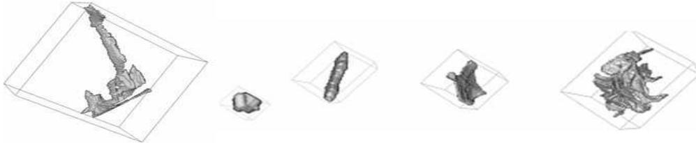
FIG. 6.33: Cinq différents types de particule de type  $Al_x(Fe,Mn)$  contenus dans AA5182 déformé à 10% de gauche à droite particules A, B, C, D, E
