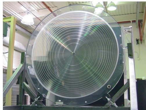
FIG. 2.3 – (*gauche*) Système optique diffractif constitué de deux lentilles de Fresnel ; (*droite*) Prototype de lentille ( $1\text{ m}$  de diamètre) [48]
