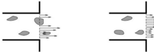
FIG. 1.6 – Influence de la cavitation sur le profil de vitesse d'injection [54]
