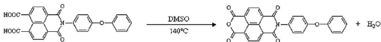
Figure 89 – 2<sup>ème</sup> étape de la synthèse du composé modèle PIs jonction : synthèse de l'anhydride-imide
