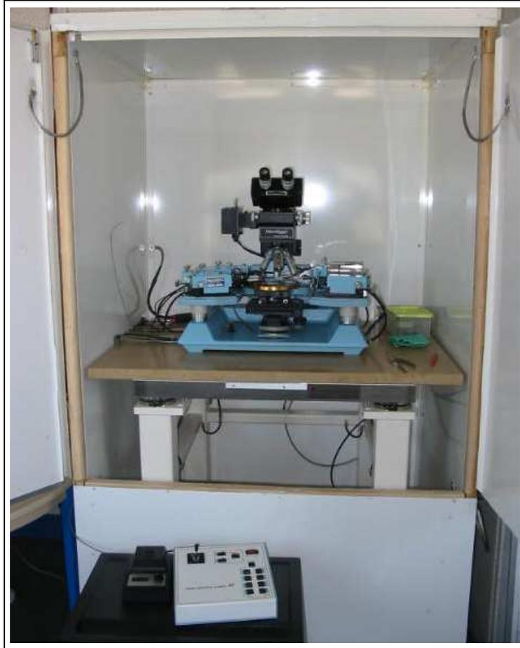
*Figure 3.5: Photographie de la cage de Faraday conçue pour le banc de mesures bas bruit.*
