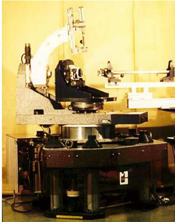
**Figure 4-17 : Goniomètre de la ligne BM32 à l'ESRF pouvant être utilisé comme réflectomètre**
