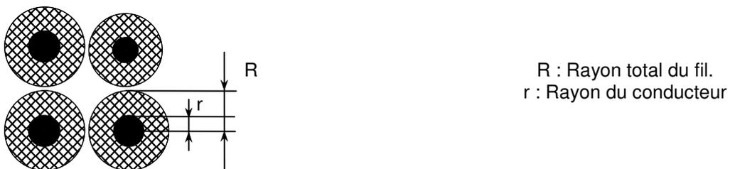
*Fig. 5-2 : Coupe transversale du câble torsadé utilisé dans le réseau BT.*
