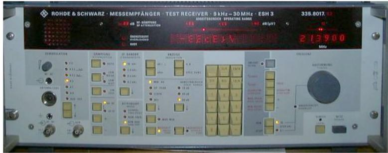
Fig. 3-4 : Test-receiver utilisé pour mesurer le transfert de signal en HF.
