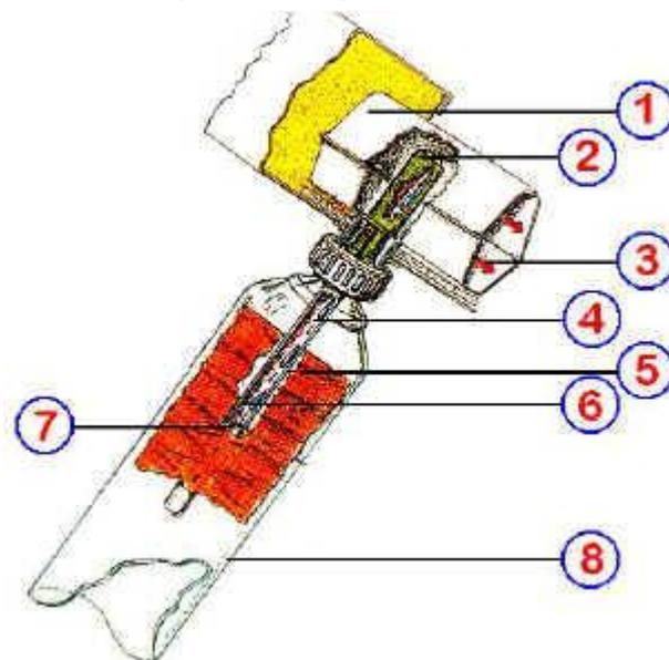
Figure A. 5: Schéma de fonctionnement du capteur sous vide à caloduc avec le collecteur d'après la documentation Thermomax (OUTILS SOLAIRES).
