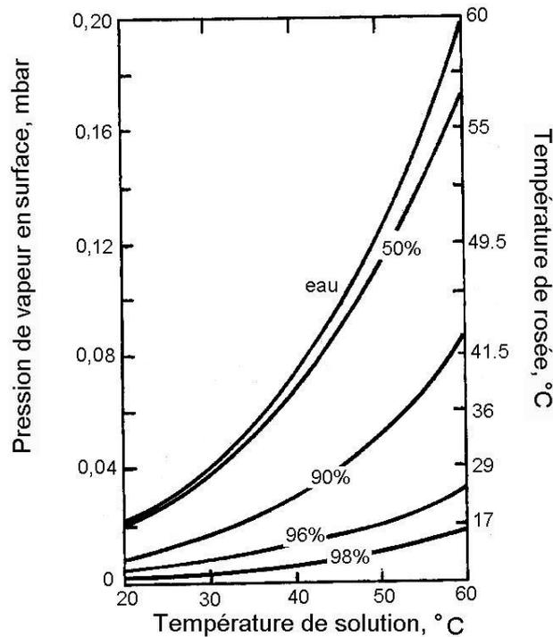
Figure 1. 15: Pression de vapeur à la surface pour différentes solutions d'eau- triéthylène glycol (ASHRAE, 1997)
