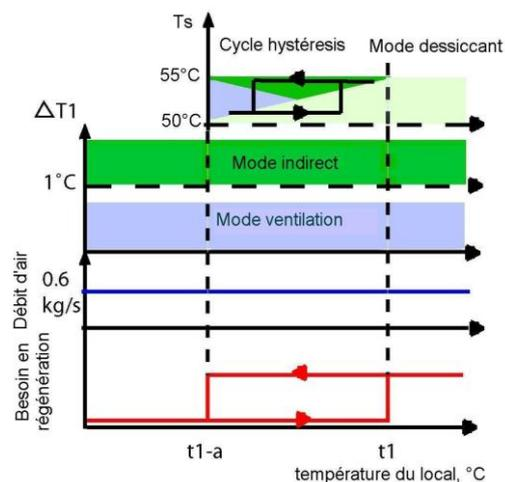
Figure 3. 50: Représentation schématique de la logique de contrôle pendant la période d'occupation,  $\Delta T_1$  est la différence de température entre l'air extérieur et l'air de retour à la sortie de l'humidificateur indirect,  $T_s$  est la température du ballon de stockage et  $a$  est une constante qui dépend de la masse thermique du bâtiment.
