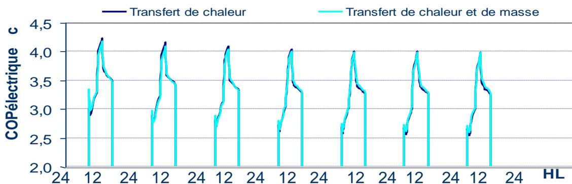
Figure 3. 19 : Comparaison de l'évolution du COP électrique entre les deux modèles avec et sans transfert de masse.
