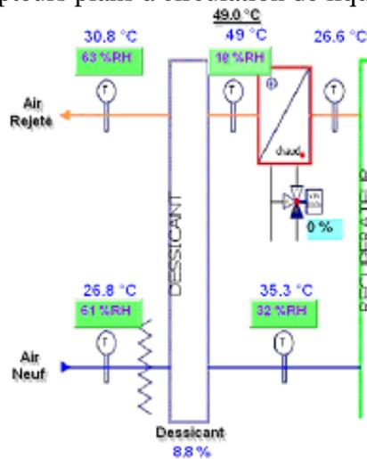
Figure 4. 19 : La roue dessiccante en fonctionnement en mode dessiccant.
