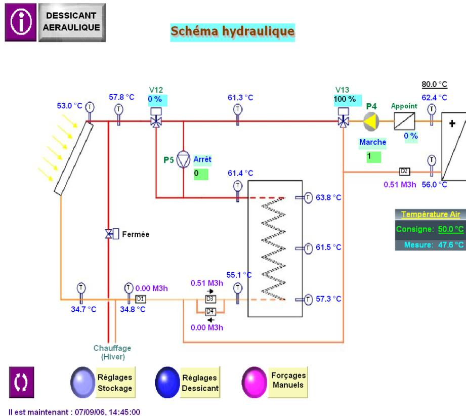
Figure 4. 35: L'installation solaire fonctionnant en mode déstockage.
