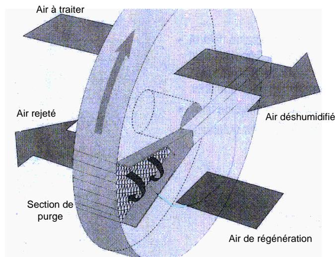
Figure 1. 25: Schéma d'une roue verticale à dessiccation (STABAT, 2003).
