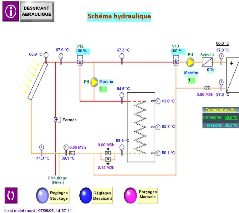
Figure 4. 13 : Visualisation de l'installation solaire.
