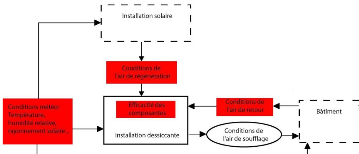
Figure 2. 14 : Diagramme schématisant des facteurs influençant directement (en rouge) et indirectement (en traits tirés) la performance de l'installation dessiccante (conditions de l'air de soufflage) et dont il semble intéressant de montrer leurs effets en utilisant la simulation dans un programme orienté objet.
