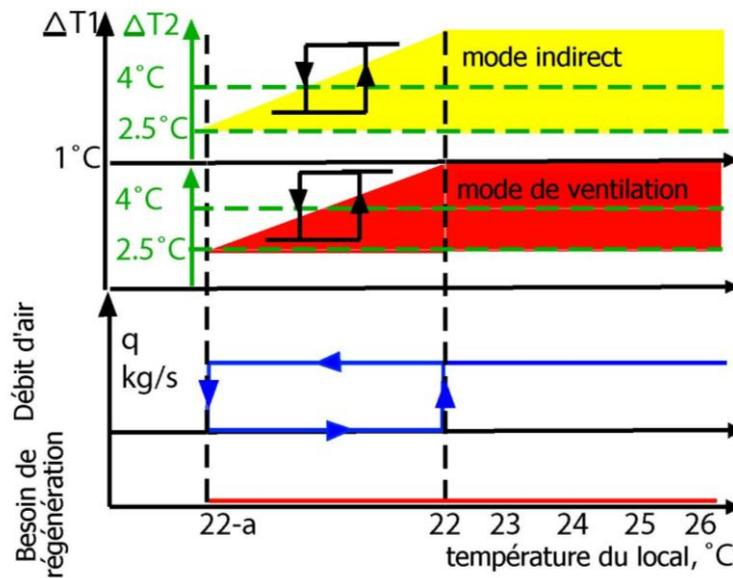
Figure 3. 36 : Schéma présentant la stratégie de contrôle pendant la période d'inoccupation utilisant la ventilation avec l'humidification indirecte.  $\Delta T_2$  est la différence entre la température du local et la température de soufflage et  $\Delta T_1$  la différence entre la température de l'air extérieur et la température de l'air à la sortie de l'humidificateur de retour.  $q$  est le débit d'air de soufflage en kg/s.
