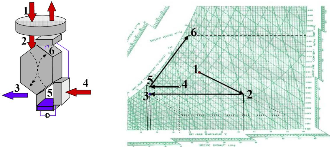
Figure 1. 12: Cycle de VanZyl 1 avec l'évolution correspondante de l'air dans le diagramme psychométrique (VAN ZYL et al., 2003).
