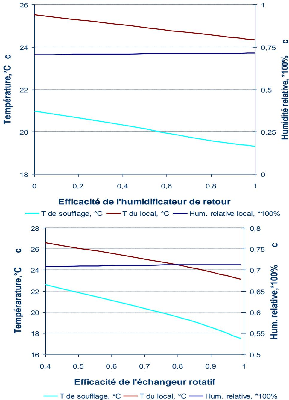
Figure 3. 9: Evolution de la température de soufflage, de la température du local et de son humidité relative en fonction des efficacités du système d'humidification indirect, l'efficacité de l'humidificateur direct étant de 0,85, le rendement des ventilateurs de 0,8 et la température de régénération de 50°C.
