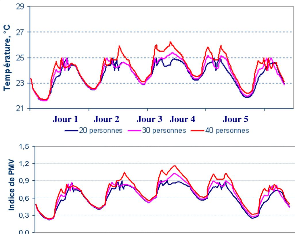
Figure 4. 4: Evolution de la température du local et de son indice de confort PMV, pour 20, 30 et 40 occupants et en supposant que l'installation à dessiccation est utilisée.
