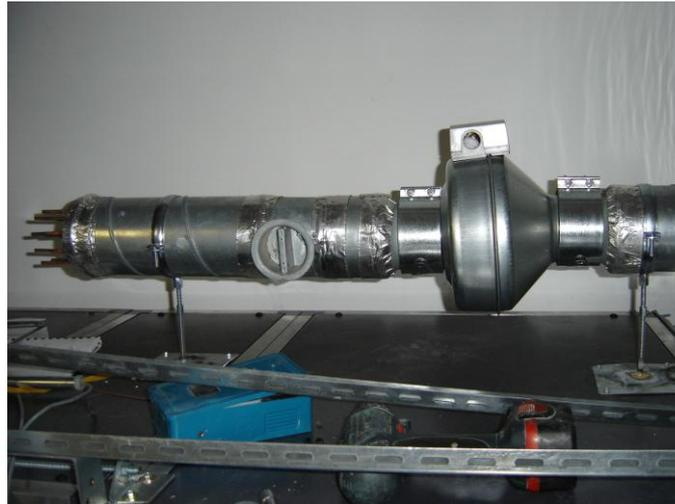
Figure 4. 24 : Ventilateur d'aspiration pour les tubes en U.
