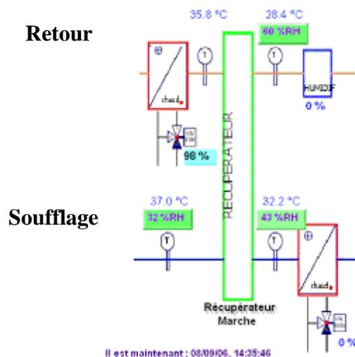
Figure 4. 17 : Fonctionnement de l'échangeur rotatif.
