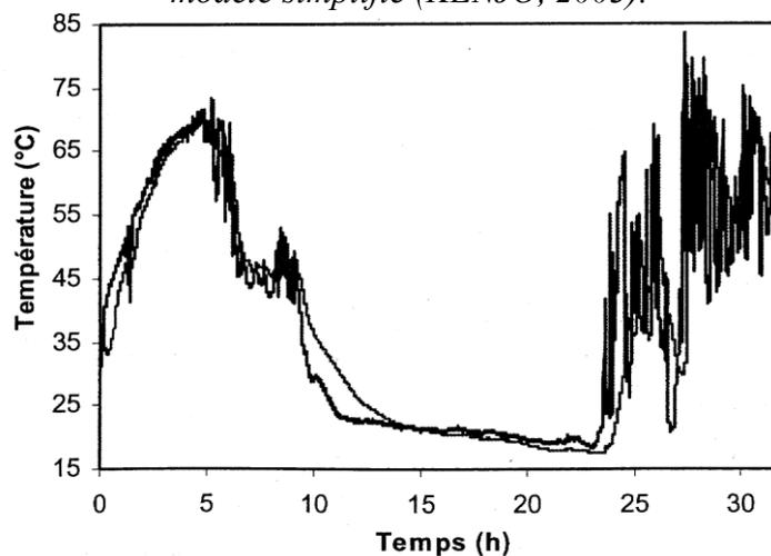
Figure 2. 11: Températures du fluide à la sortie du capteur mesurée et calculée par le modèle intermédiaire (KENJO, 2003).
