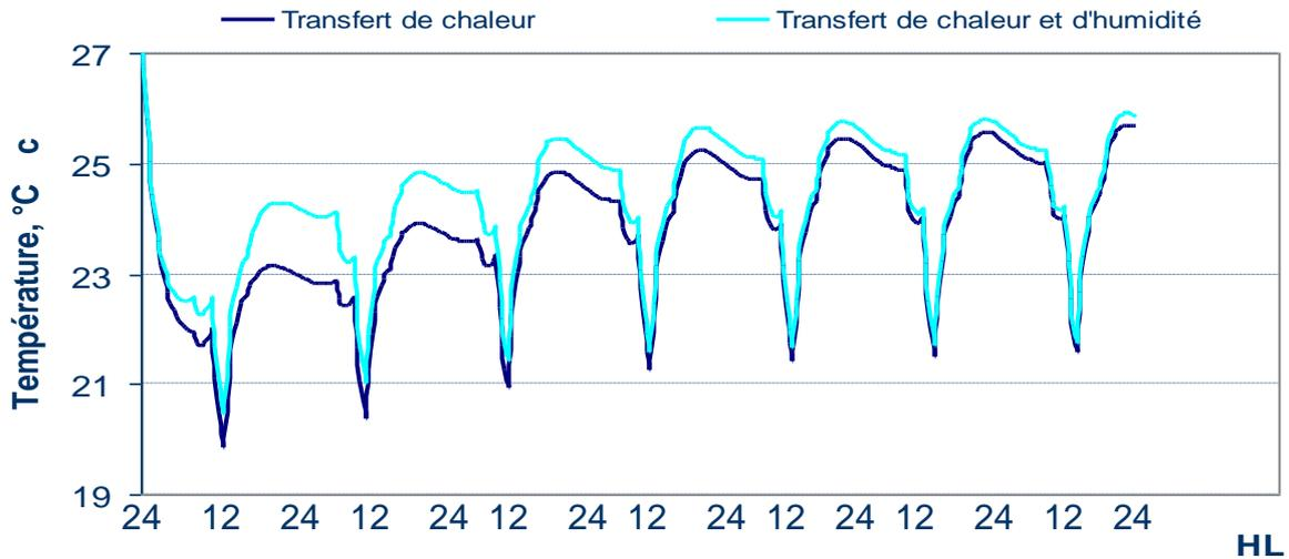
Figure 3. 16: Comparaison de l'évolution de la température du local entre les deux modèles avec et sans transfert de masse.
