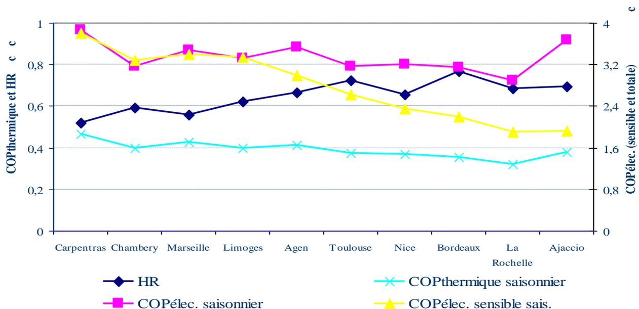
Figure 3. 45: Variation du COP électrique (total et sensible) saisonnier (avec prise en compte de la consommation électrique des ventilateurs) et du COP thermique, pour différentes villes françaises.
