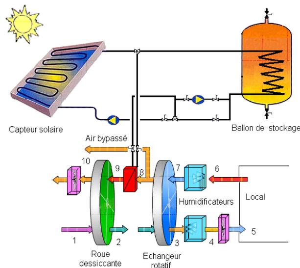
Figure 3. 47: Installation dessicante couplée à l'installation solaire
