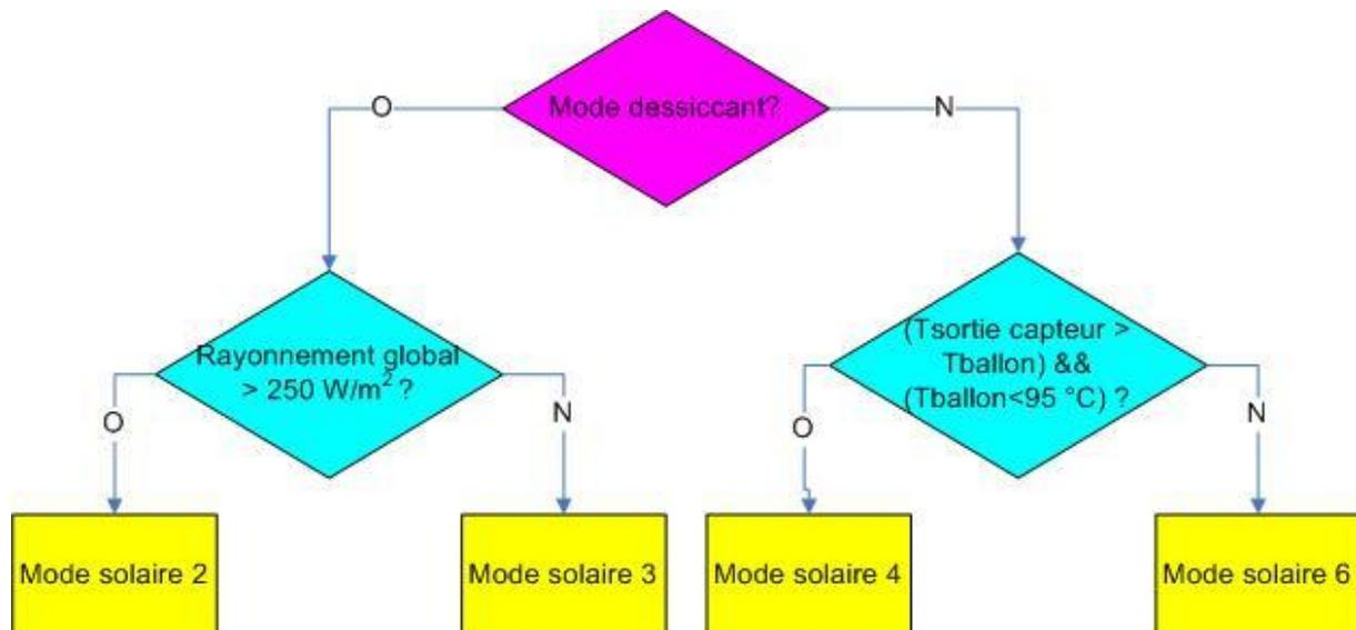
Figure 3. 49 : Logique de fonctionnement de l'installation solaire.
