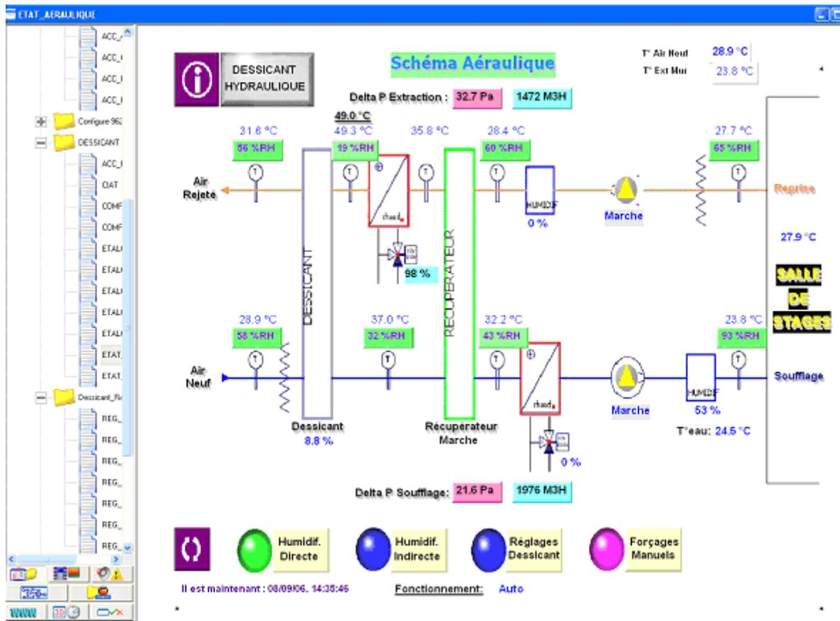
Figure 4. 22 : Visualisation des données de l'installation à air.
