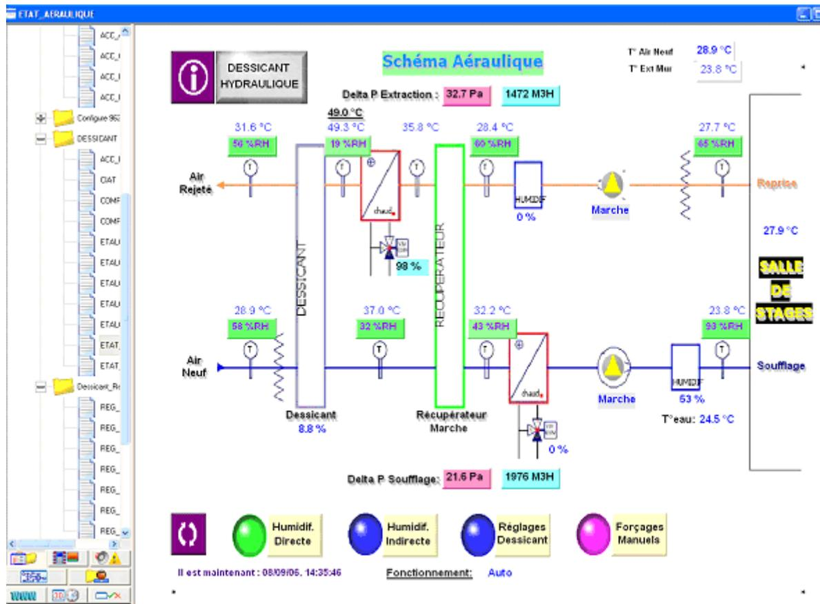
Figure 4.12 : Visualisation de l'installation dessicant
