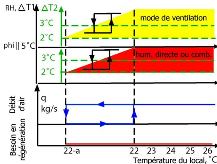
Figure 3. 35: Schéma présentant la stratégie de contrôle pendant la période d'inoccupation et utilisant la ventilation avec l'humidification directe ou combinée.  $\Delta T_2$  est la différence entre la température du local et la température de soufflage et  $\Delta T_1$  la différence entre la température intérieure du local et la température de l'air extérieur.  $q$  est le débit d'air de soufflage en kg/s,  $\phi$  est une constante égale à 0,8 ou 0,9.
