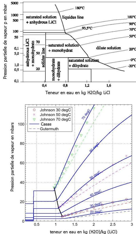
Figure 1. 18 : Diagramme de phase pour le système eau- LiCl et les isothermes de sorption correspondantes (de l'expérience) (CASAS et al., 2005)
