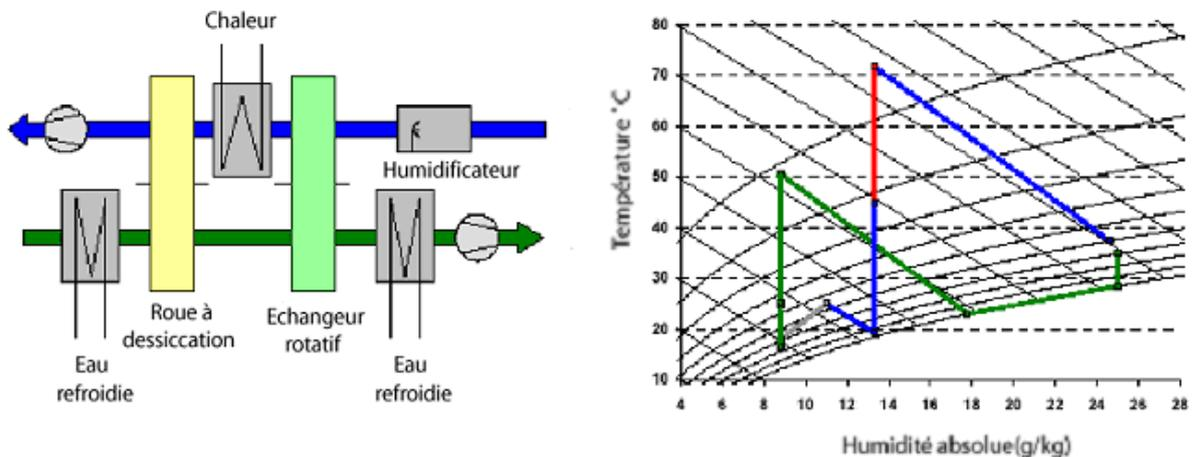
Figure 1. 9 : Schéma du cycle dessicant à refroidissement à eau pour les régions à humidité absolue très élevée. L'air extérieur a une humidité absolue de  $25\text{g}/\text{kg}$  et une température de  $35^\circ\text{C}$ . A la sortie de l'échangeur son humidité est réduite à  $18\text{g}/\text{kg}$  et sa température à  $24^\circ\text{C}$  (HENNING et al., 2004).
