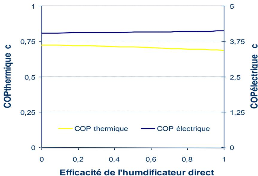
Figure 3. 8: Evolution des COP électrique et thermique instantanés en fonction de l'efficacité de l'humidificateur direct, la température de régénération étant de 50°C, l'efficacité de l'échangeur de chaleur de 0,8; celle des humidificateurs de 0,85 et le rendement des ventilateurs de 0,8.
