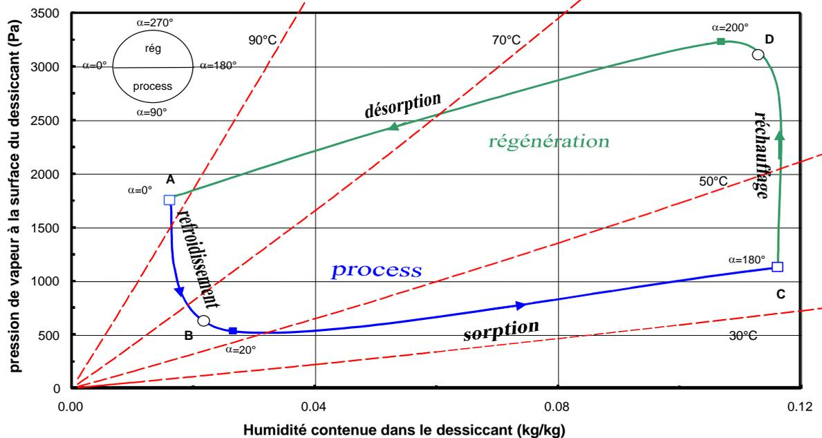
Figure 1. 26: Evolution de la pression de vapeur à la surface de la roue en fonction de l'angle de la roue (STABAT, 2003).
