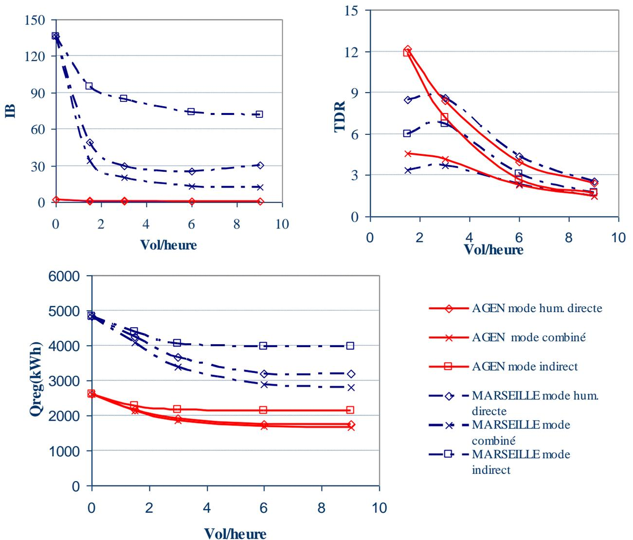
Figure 3. 38: Variation de l'IB, du TDR et de l'énergie de régénération en fonction du débit de soufflage pendant la période d'inoccupation, pour différentes techniques de régulation dans les villes de Marseille et de Agen.
