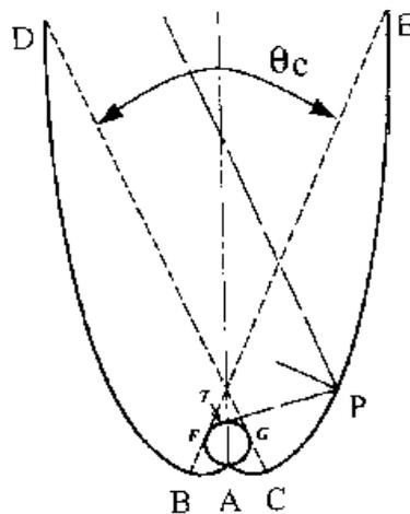
Figure A. 4: Schéma d'un collecteur à composés paraboliques (KALOGIROU et al., 2004).
