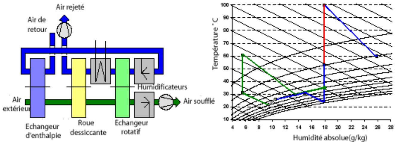
Figure 1. 8: Schéma du cycle dessicant adapté aux régions à humidité absolue élevée. L'air extérieur à l'entrée de l'échangeur a une humidité absolue de  $18\text{g}/\text{kg}$  et une température de  $35^\circ\text{C}$ . A la sortie de l'échangeur son humidité est réduite à  $14\text{g}/\text{kg}$  et sa température à  $30^\circ\text{C}$  (HENNING et al., 2004).
