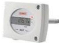
Figure 4. 21 : Hygromètre de type KIMO utilisé pour les mesures, la sonde est juste placée derrière l'écran.
