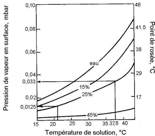
Figure 1. 16: Pression de vapeur à la surface pour différentes solutions d'eau- Chlorure de Lithium (ASHRAE, 1997).
