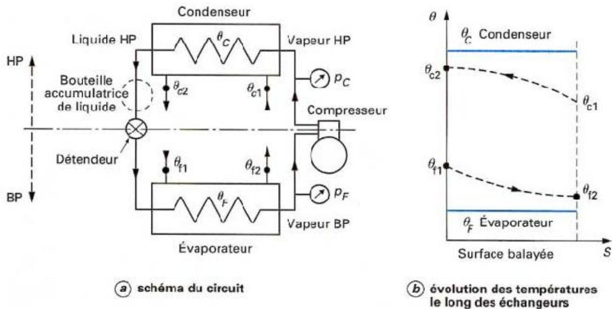
Figure 1. 2: Cycle mécanofrigorifique monoétage conventionnel (DUMINIL, 2002) .
