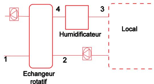
Figure 3. 26: Schéma du système indirect étudié.
