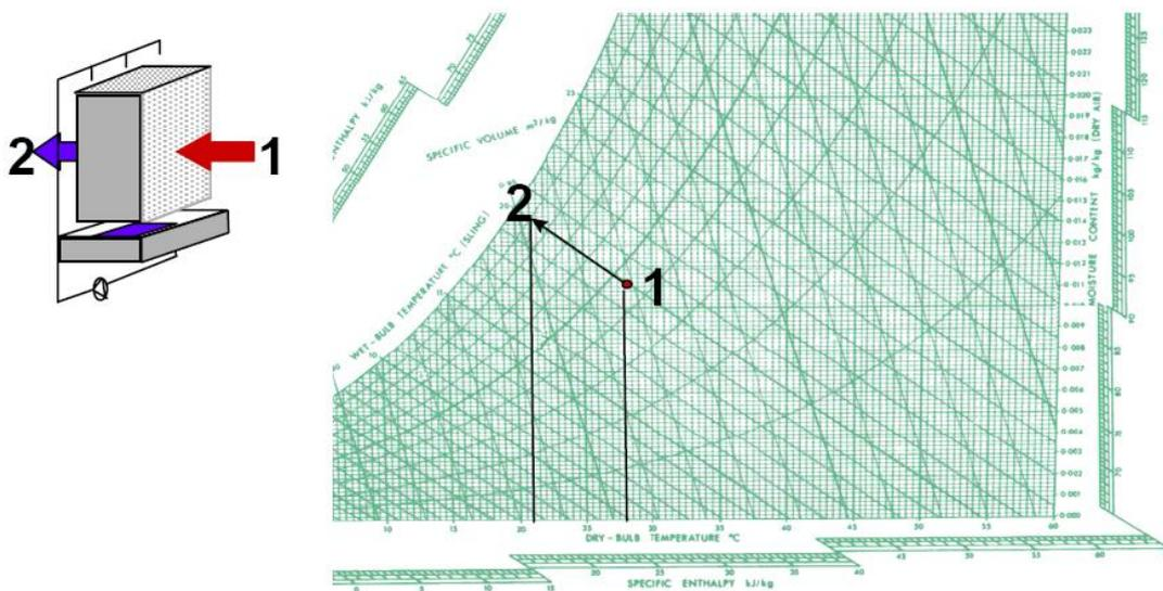
Figure 1. 3 : Système à humidification directe avec l'évolution correspondante de l'air sur le diagramme de l'air humide (VAN ZYL et al., 2003).
