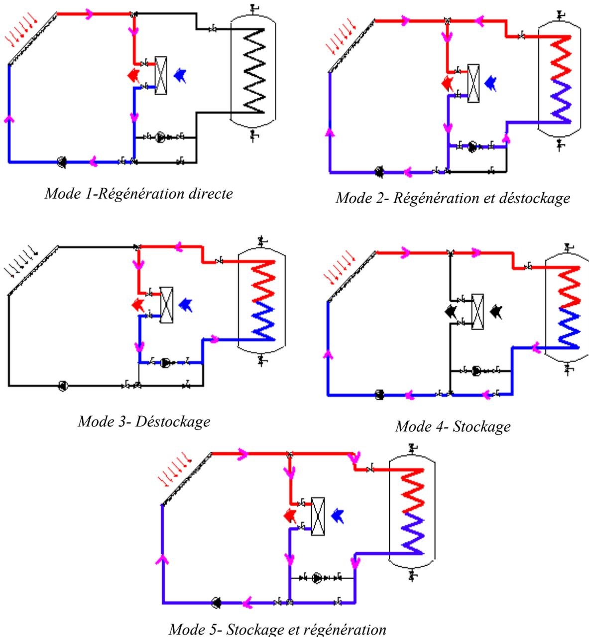
Figure 4. 32 : Schéma montrant les différents modes de fonctionnement de l'installation solaire (FILFLI, 2004)
