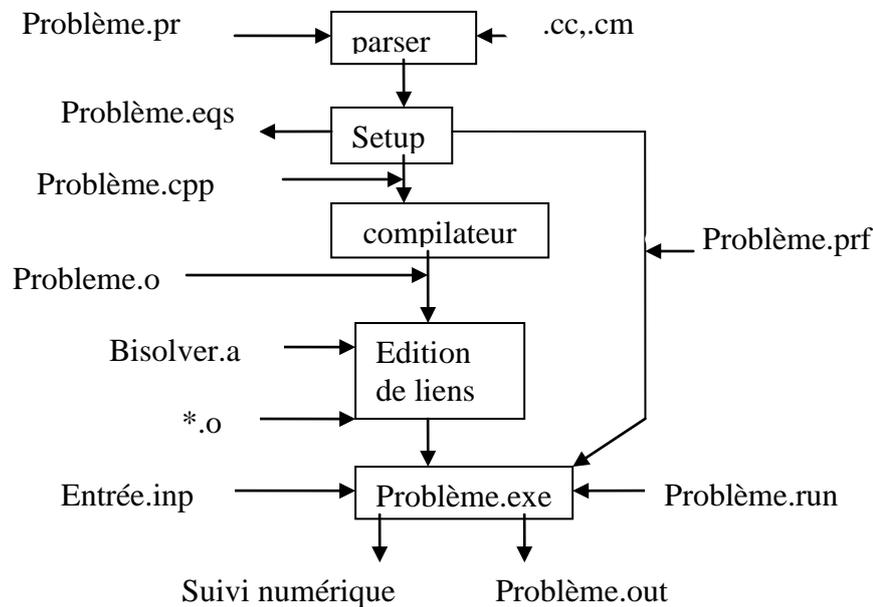
Figure 2. 15: La construction d'un problème SPARK
