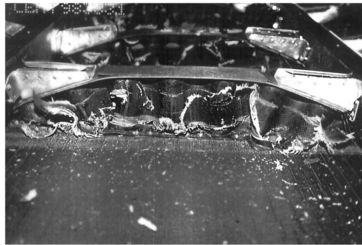
Figure 1.2 – Poutre sinus après un essai de crash
