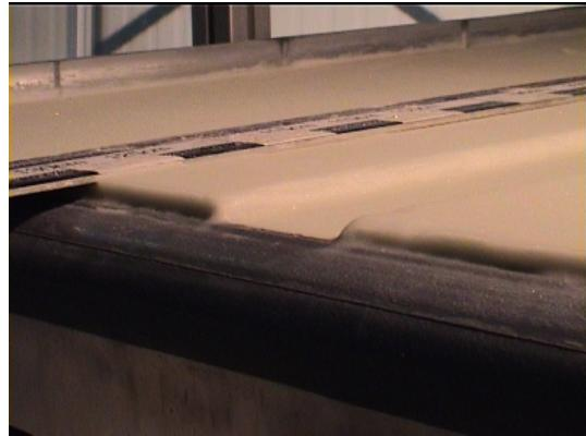
FIG. 2.8 – Préparation du chenal. (a) Photo du racloir permettant de préparer le chenal initial de section rectangulaire. La pièce centrale est interchangeable pour permettre de varier la largeur initiale (ici 6 cm). (b) Photo en gros plan de l'exutoire de la rivière montrant la hauteur des berges de 1 cm et la limite de la plaine alluviale.
