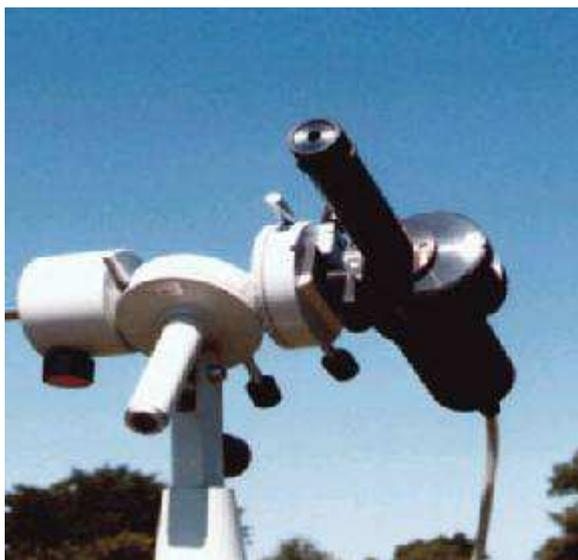
Figure III.1 Sunphotomètre SP2H
