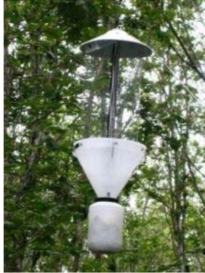
**Figure 11 : Illustration du piège lumineux utilisé (photo P. Bonneil).**
