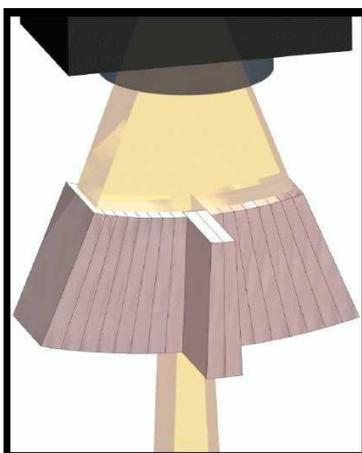
Figure II.11 : Schéma d'un collimateur multi-lames binaire avec une géométrie « en tranche » [Dyk2001].
