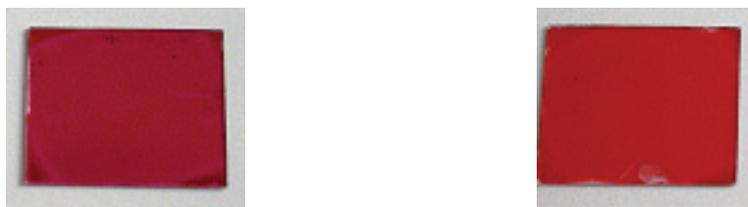
Fig.78. Photo d'un échantillon non-réticulé (à gauche, couleur rose intense) et réticulé (à droite, rouge).
