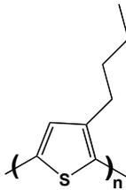
Fig.155. Structure chimique du polybutylthiophène (P3BT).
