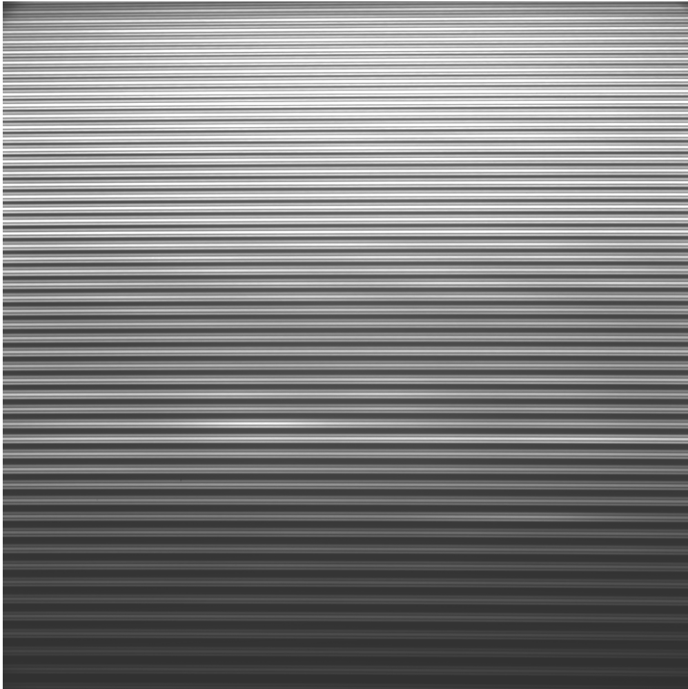
FIG. 7.15 – Image brute du spectre de la lampe source au xénon. Temps de pose : 500 ms, gain 1. La température de l'arc électrique ne forme qu'un continuum spectral sans raie fine d'émission ou d'absorption.
