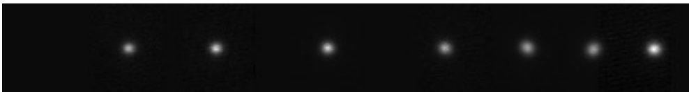
FIG. 4.17 – Reconstitution d'une bande CCD de 384 pixels (pleine largeur) \times 50 pixels à partir d'enregistrements en mode fenêtre de 40 \times 50 pixels, marquant les positions du faisceau synchrotron à (de droite à gauche) 121,6 nm, 140,0 nm, 160,0 nm, 184,9 nm, 220,0 nm, 253,7 nm et 280,0 nm pour le capteur UV MV_1 . L'intensité des taches est normalisée pour être chaque fois la même.
