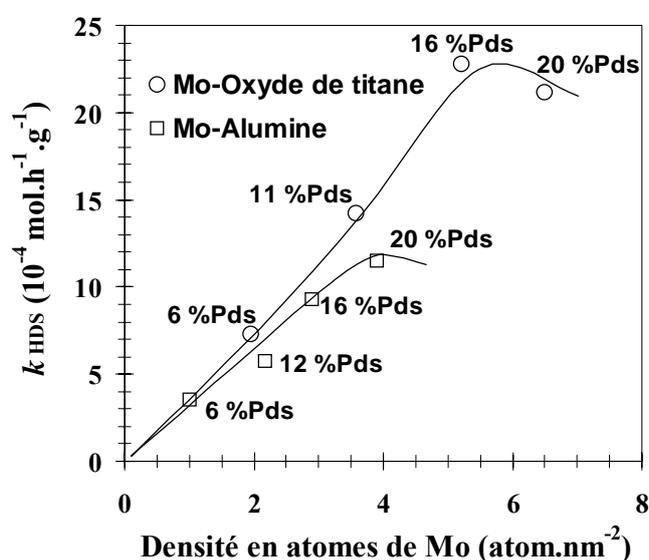
Figure IV-1. Activité en HDS du DBT à 320 °C en fonction de la teneur en Mo pour des catalyseurs non-promus supportés sur  $\gamma$ -alumine [89] ainsi que sur oxyde de titane de grande aire spécifique. Aires spécifiques : TiO<sub>2</sub> : 134 m<sup>2</sup>.g<sup>-1</sup> ; Al<sub>2</sub>O<sub>3</sub> : 256 m<sup>2</sup>.g<sup>-1</sup>.
