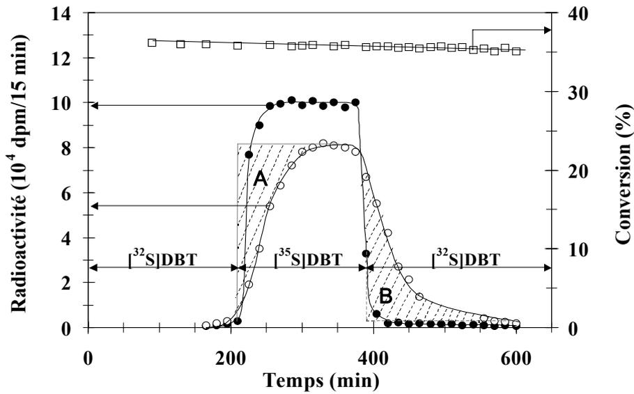
Figure I-4. Exemple de résultat obtenu en utilisant la procédure I. (●) Radioactivité due au  $[^{35}\text{S}]\text{DBT}$  non-réagi dans la phase liquide ; (○) radioactivité due au  $[^{35}\text{S}]\text{H}_2\text{S}$  libéré dans la phase gaz ; (□) taux de conversion du DBT.
