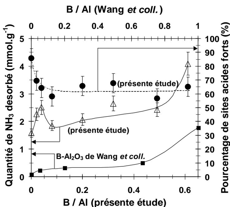
Figure II-4. Quantité de NH<sub>3</sub> désorbé (■) et contribution relative des espèces NH<sub>3</sub> fortement adsorbées (●) sur les poudres de B-Al<sub>2</sub>O<sub>3</sub> calcinées en fonction du rapport B / Al; quantité de NH<sub>3</sub> désorbé sur les B-Al<sub>2</sub>O<sub>3</sub> coprécipités de Wang *et coll.* (▲) [46] en fonction de B / Al.
