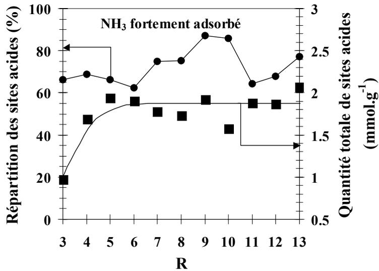
Figure I-4. Quantité totale de sites acides et contribution relative de NH<sub>3</sub> fortement adsorbé pour toute la gamme des rapports d'hydrolyse  $R$  utilisés [39\*].
