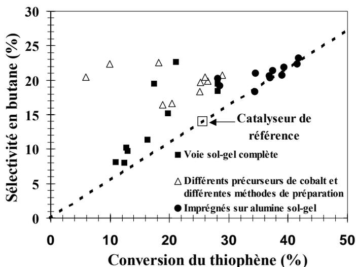
Figure I-5. Sélectivité en butane en fonction de la conversion du thiophène pour différents modes de préparation de catalyseurs CoMo/Al<sub>2</sub>O<sub>3</sub> à base d'alumine sol-gel.
