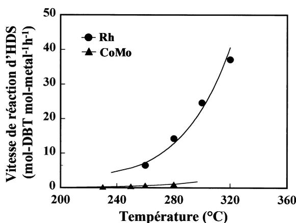
**Figure II-1. Activité spécifique (par nombre de moles de métal) d'un catalyseur contenant 0,25 % de Rh avec Cs/Rh = 1 supporté sur alumine et d'un catalyseur conventionnel CoMo/Al<sub>2</sub>O<sub>3</sub> (contenant 5 %Pds de CoO et 16 %Pds de MoO<sub>3</sub>).**
