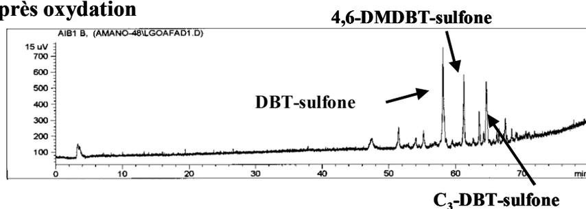
Figure II-1. Exemple de chromatogramme SCD obtenu avant et après oxydation du gazole léger.
