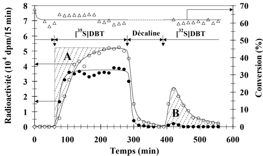
Figure I-5. Exemple de résultat obtenu en utilisant la procédure II. (●) Radioactivité due au  $[^{35}\text{S}]\text{DBT}$  non-réagi dans la phase liquide ; (○) radioactivité due au  $[^{35}\text{S}]\text{H}_2\text{S}$  libéré ; (Δ) conversion du DBT.
