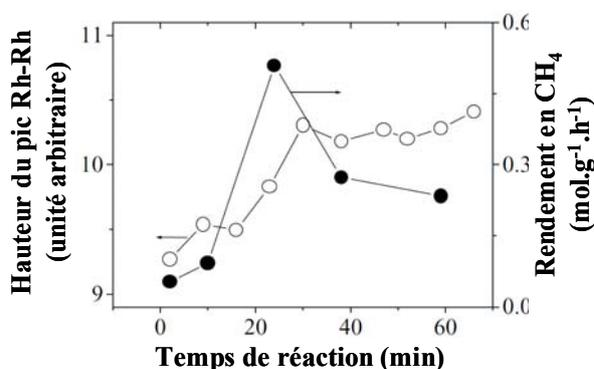
**Figure II-3. Evolution de la hauteur du pic attribué à la diffusion Rh-Rh dans la transformée de Fourier de l'oscillation EXAFS et du rendement en  $\text{CH}_4$  en fonction du temps de réaction.**
