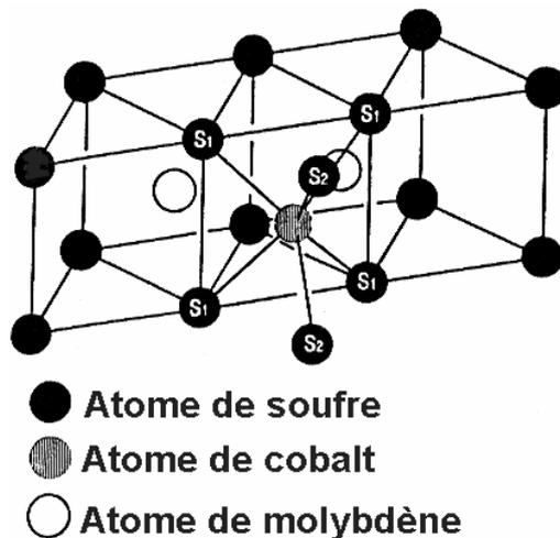
**Figure I-7. Localisation précise du promoteur sur le bord d'un feuillet de MoS<sub>2</sub> déterminée par EXAFS [228].**
