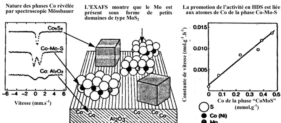
Figure I-6. Différentes localisations du promoteur dans les catalyseurs Co - Mo / Al<sub>2</sub>O<sub>3</sub> [220].
