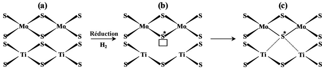
**Figure IV-2. Représentation schématique de la formation et de la structure de la phase TiMoS (promotion de la phase active MoS<sub>2</sub> par des atomes de Ti) sur les catalyseurs Mo/TiO<sub>2</sub>. (a) Catalyseur sulfuré ; (b) catalyseur après réduction ; (c) phase TiMoS. (□ : vacance anionique contenant un électron piégé).**
