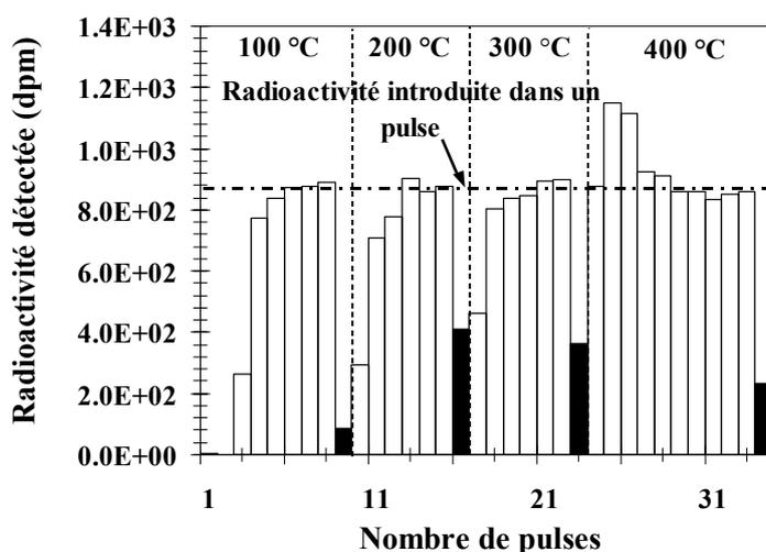
Figure I-2. Résultat de l'expérience de sulfuration d'un solide contenant 16,6 %pds de  $\text{CrO}_3$  supporté sur alumine avec des pulses de  $^{35}\text{S}]\text{H}_2\text{S}$ .
