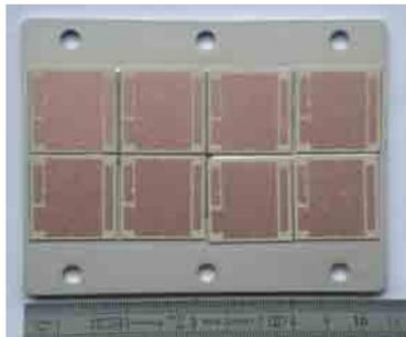
a) VT10 (Cu de 200 $\mu\text{m}$  sur Al<sub>2</sub>O<sub>3</sub> de 380 $\mu\text{m}$ )
