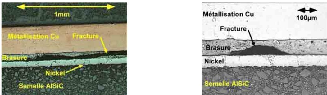
a) Fissure de la brasure semelle – DCB (vue longitudinale)      b) Fissure de la brasure semelle – DCB (vue transversale)
