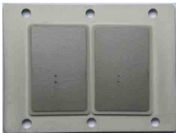
VT06 : Substrats AlN 635μm, Al 400μm.
