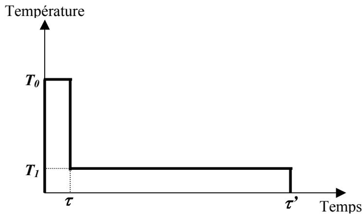
Figure VII-12 : Profil de température typique utilisé dans nos simulations thermiques.
