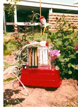
**Figure 21 : Technique de collecte des effluves par 'headspace' dynamique (schéma d'après P. Hugueney). 1, filtre de charbon actif ; 2, chambre ; 3, piège (fibre de Tenax) ; 4, pompes. La photographie représente le dispositif lors d'une expérimentation.**
