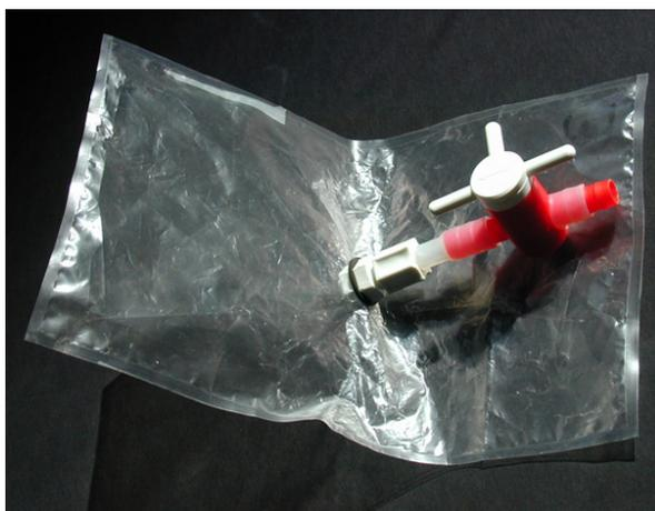
Figure 1-13 Photos du sac contenant le gaz hyperpolarisé et du robinet utilisé pour le fermer lors du transport vers l'imageur.
