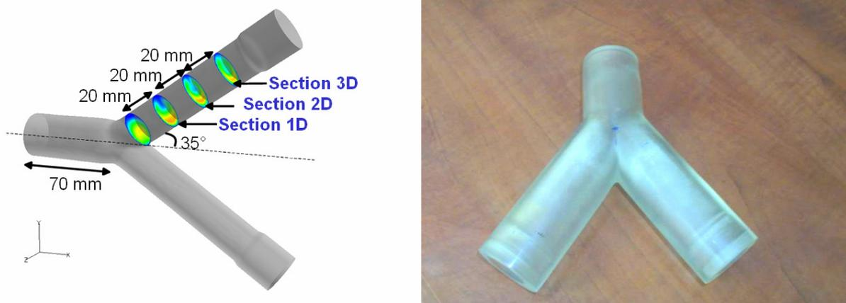
Figure 3-26 Représentation de la surface intérieure de la bifurcation (gauche). Photographie du fantôme matériel (droite).
