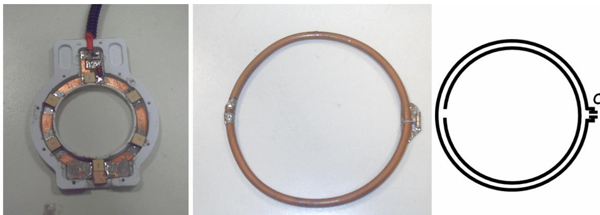
Figure 3-4 Antennes de surface 8 cm (gauche) et 13 cm (milieu). L'antenne de 13 cm est basée sur le principe de la structure auto-résonante des lignes de transmission (gauche). Le système est accordé grâce à l'ajout d'une capacité réglable (C).
