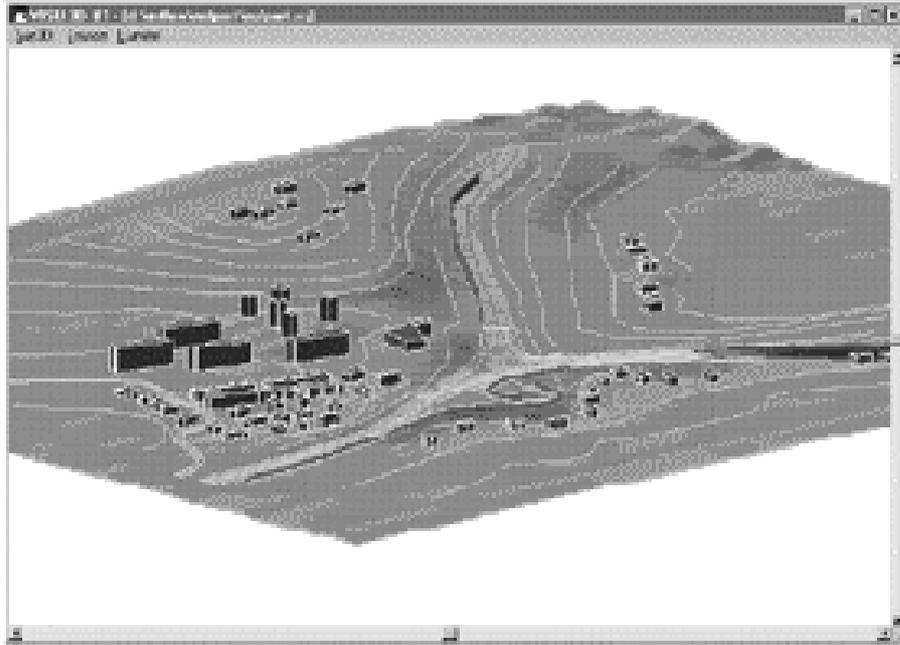
Figure 49 - Exemple de saisie informatique d'un site avec le logiciel Mithra - source CSTB
