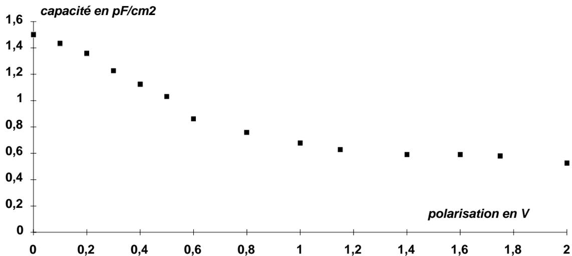
Figure II.11: Evolution de la capacité avec la polarisation pour une diode de  $30 \times 30 \mu\text{m}^2$
