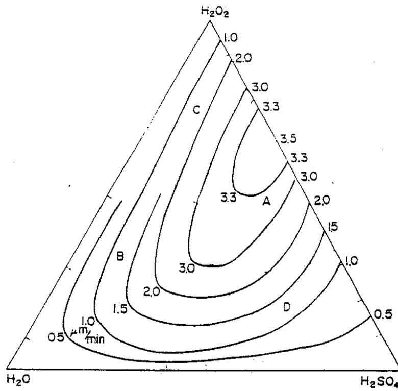
Figure I.15: Courbes d'iso-vitesse pour les mélanges H<sub>2</sub>SO<sub>4</sub>/H<sub>2</sub>O<sub>2</sub>/H<sub>2</sub>O
