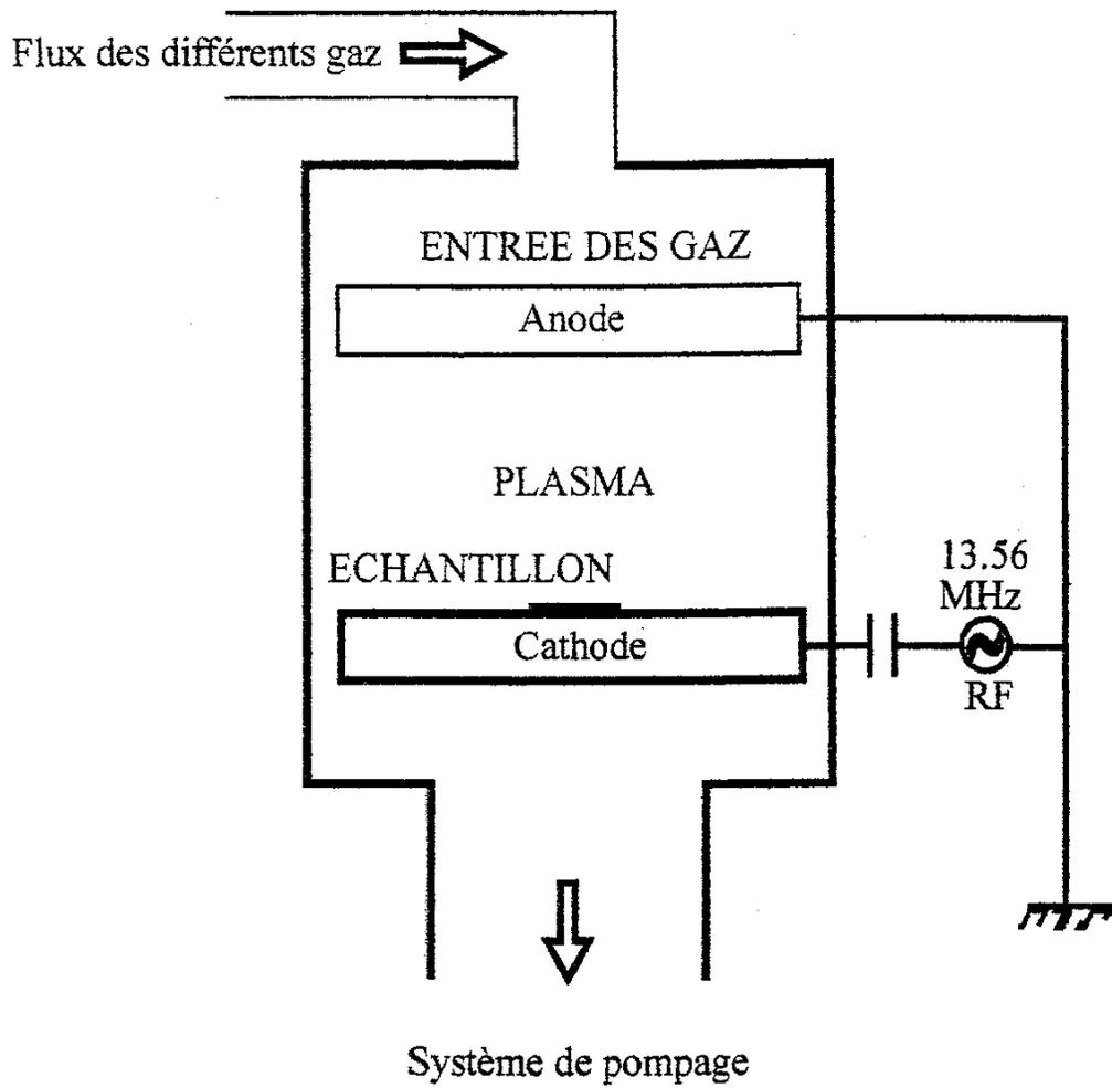
Figure I.19: Schéma d'un bâti G.I.R.
