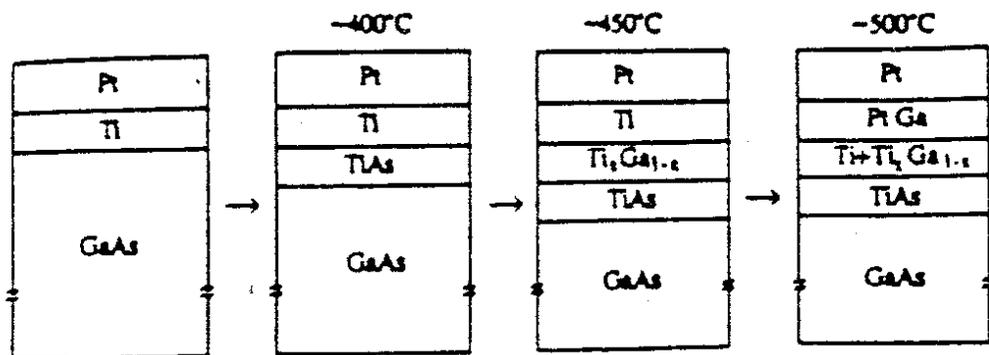
Figure 1.8: Evolution de la séquence Ti/Pt/Au déposée sur du GaAs de type p avec la température
