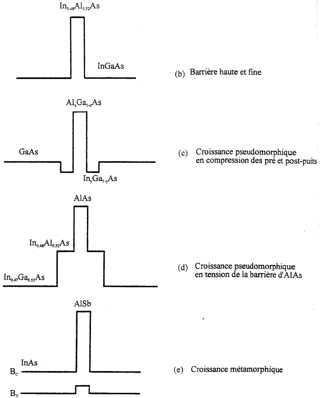
Figure II.4: Illustration des différentes possibilités de croissances épitaxiales
