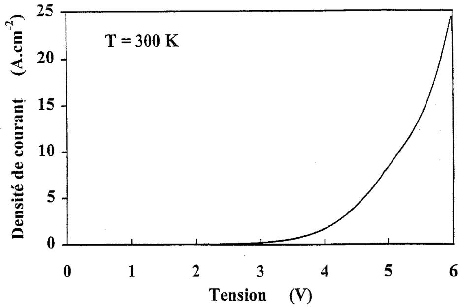
Figure II.25: Caractéristique  $I(V)$  théorique calculée pour une structure GaInAs/AlInAs/AlAs/AlInAs/GaInAs
