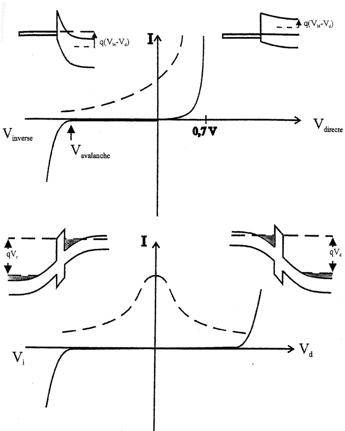
Figure II.1: Caractéristiques courant-tension et capacité-tension pour une structure métal-semiconducteur et pour une hétérostructure
