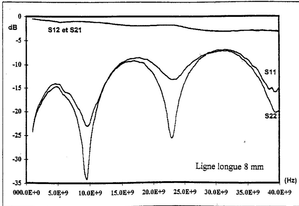
Fig.III.13: Couple de lignes 50 Ohm sur une membrane en Nitrure de Silicium
