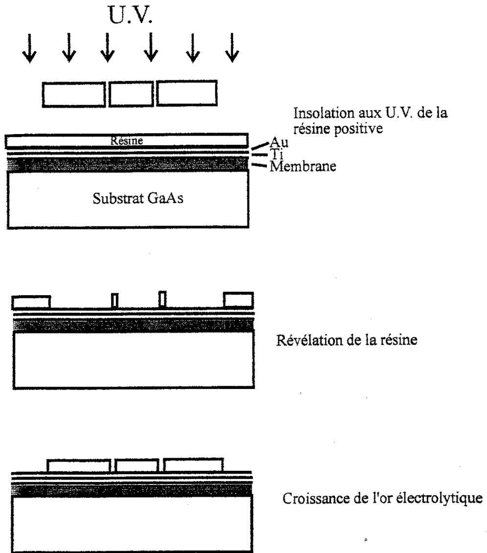
Figure III.5.a: Procédé de résinage positif
