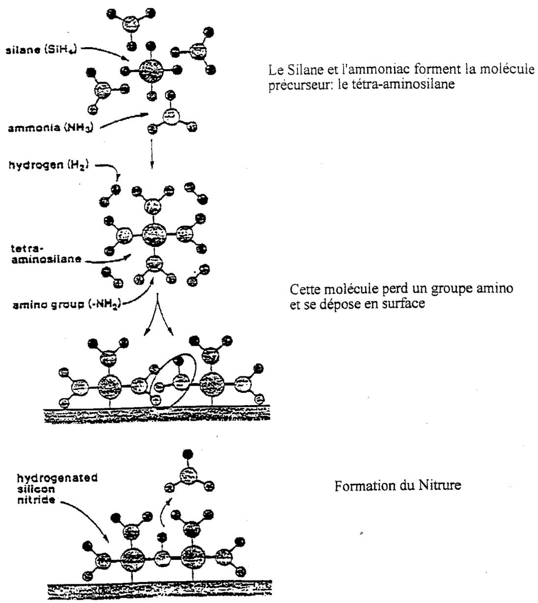
Figure III.3: Principe du dépôt de Nitrure de Silicium
