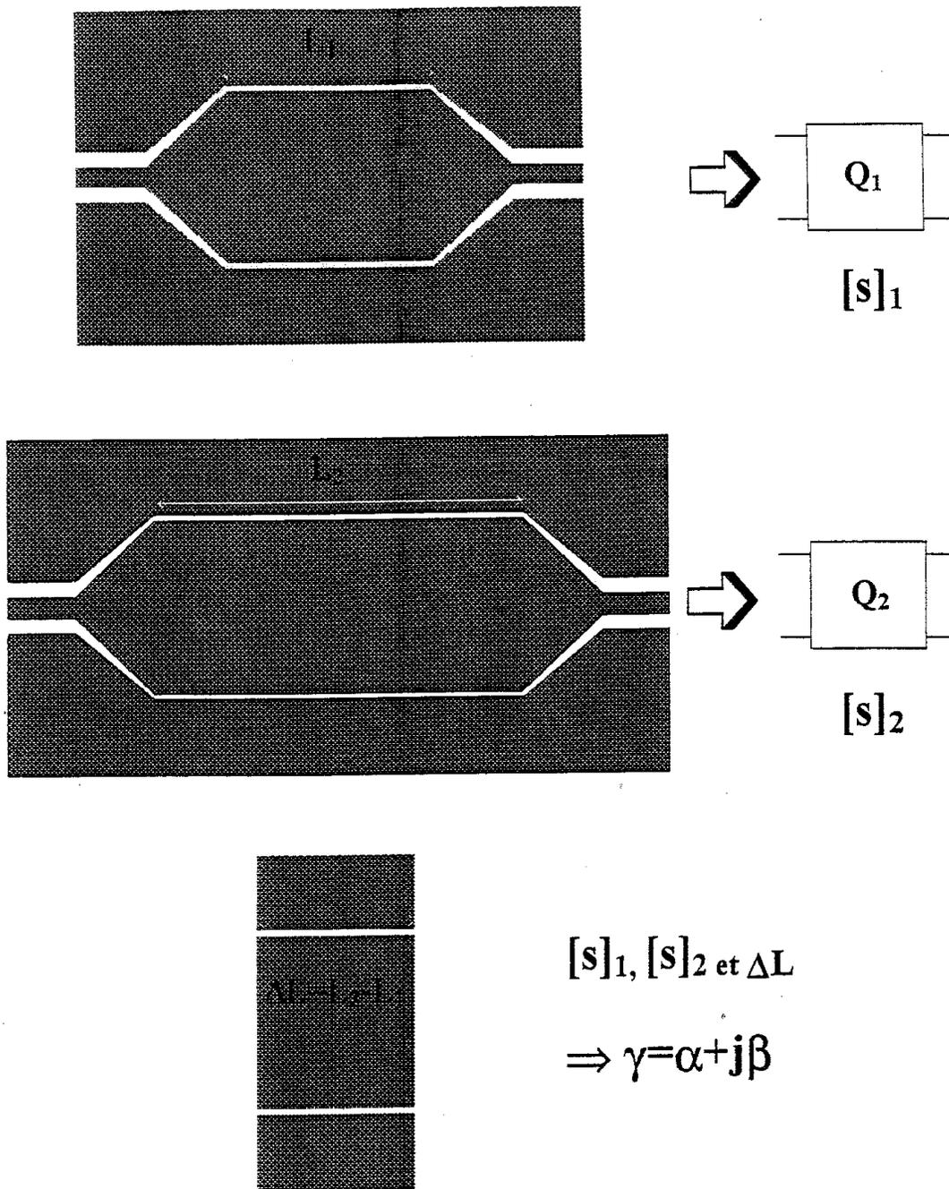
Fig.III.12: Principe de détermination des caractéristiques de propagation d'une ligne coplanaire sur membrane
