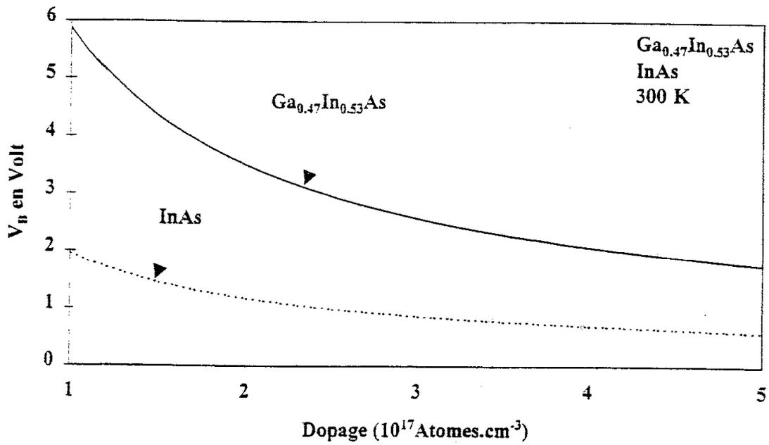
Figure IV.4: Variation de la tension d'avalanche des deux matériaux pour des dopages compris entre  $1.10^{17}$  et  $5.10^{17} \text{ cm}^{-3}$
