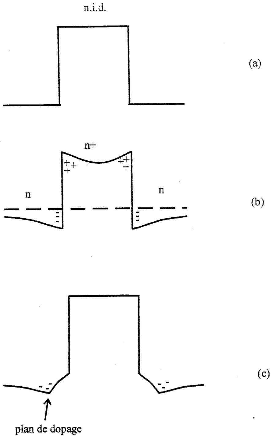
Figure II.6: Barrière d'AlInAs non dopée (fig.a), dopée (fig.b) et non dopée avec insertion d'un plan de dopage dans le GaInAs (fig.c).
