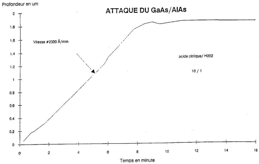
*Figure I.17: Profondeur gravée lors de l'attaque du GaAs par la solution {acide citrique:10, H<sub>2</sub>O<sub>2</sub>:1} en fonction du temps.*
