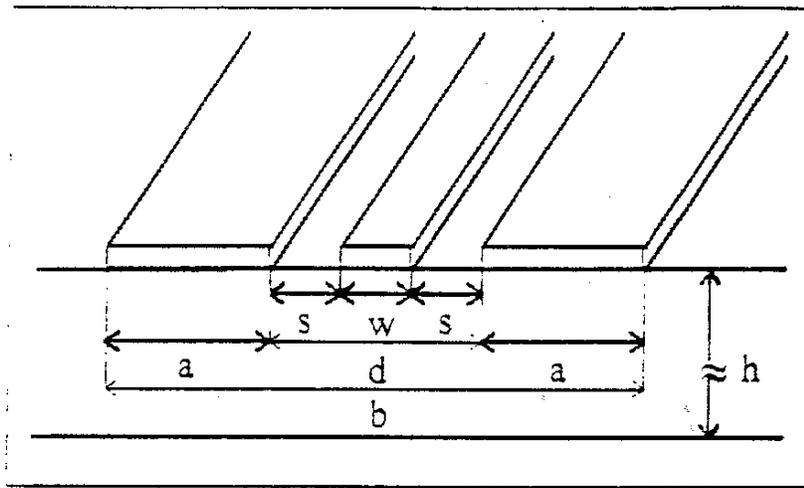
Figure III.7: Topologie de la ligne coplanaire infinie sur un substrat d'épaisseur  $h$
