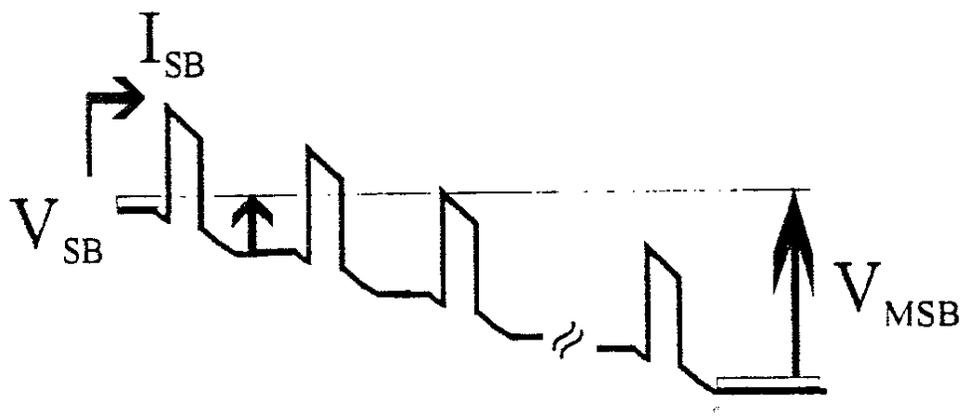
Figure IV.7: Allure du profil de potentiel d'une structure Multiple SB (notée MSB) mettant en jeu plusieurs Simples Barrières (SBV)
