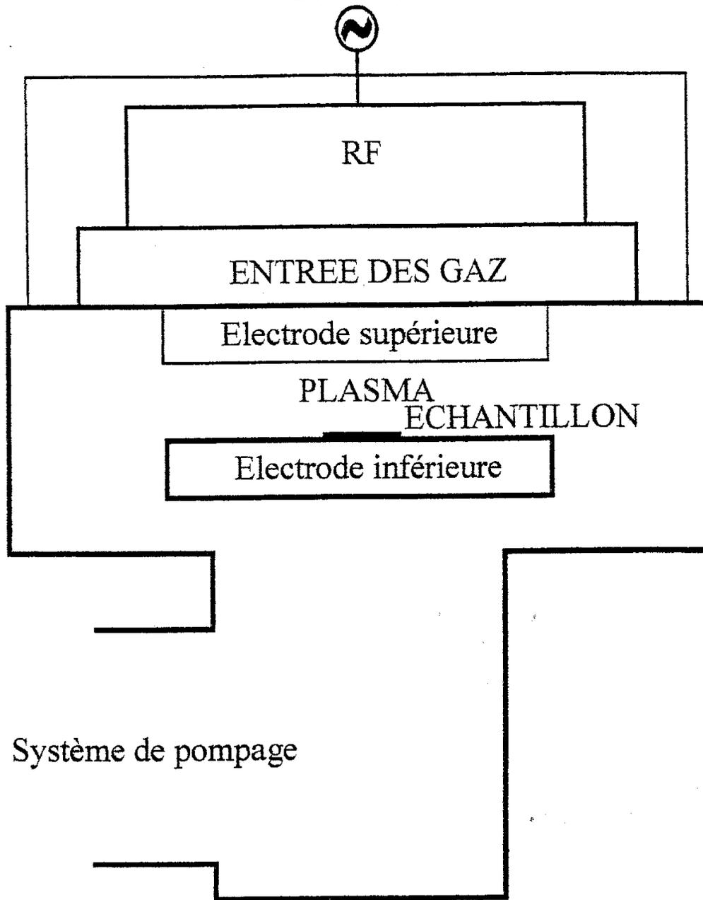
Figure III.4: Schéma du système de dépôt par PECVD
