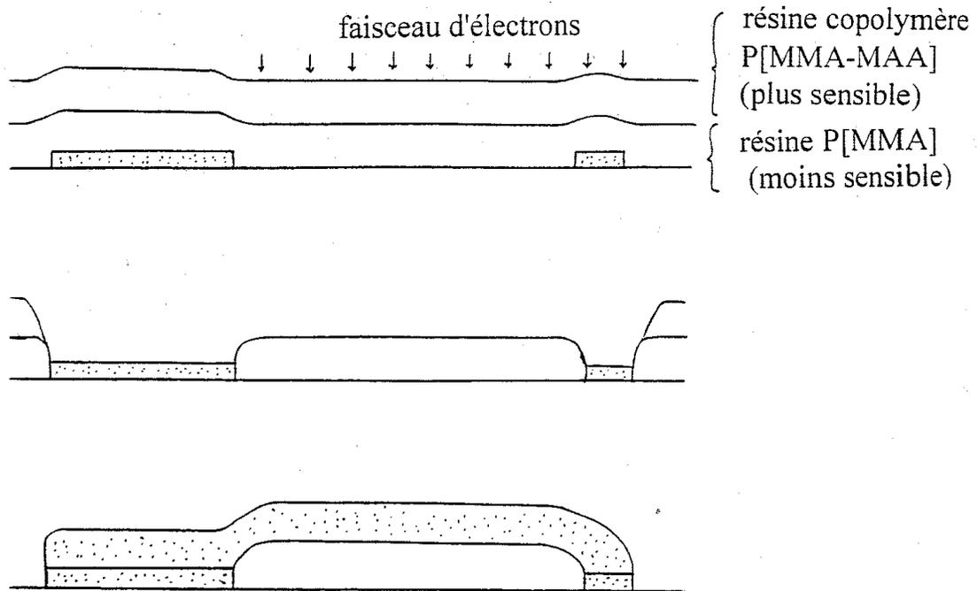
Figure 1.24: Procédé de réalisation d'un pont à air par faisceau d'électron
