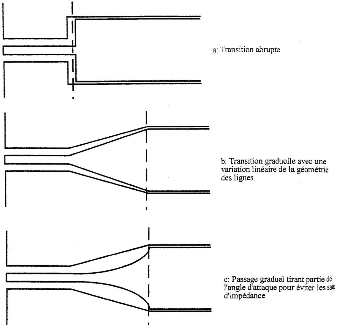
Figure III.9 Différents types de transition substrat-membrane envisageables
