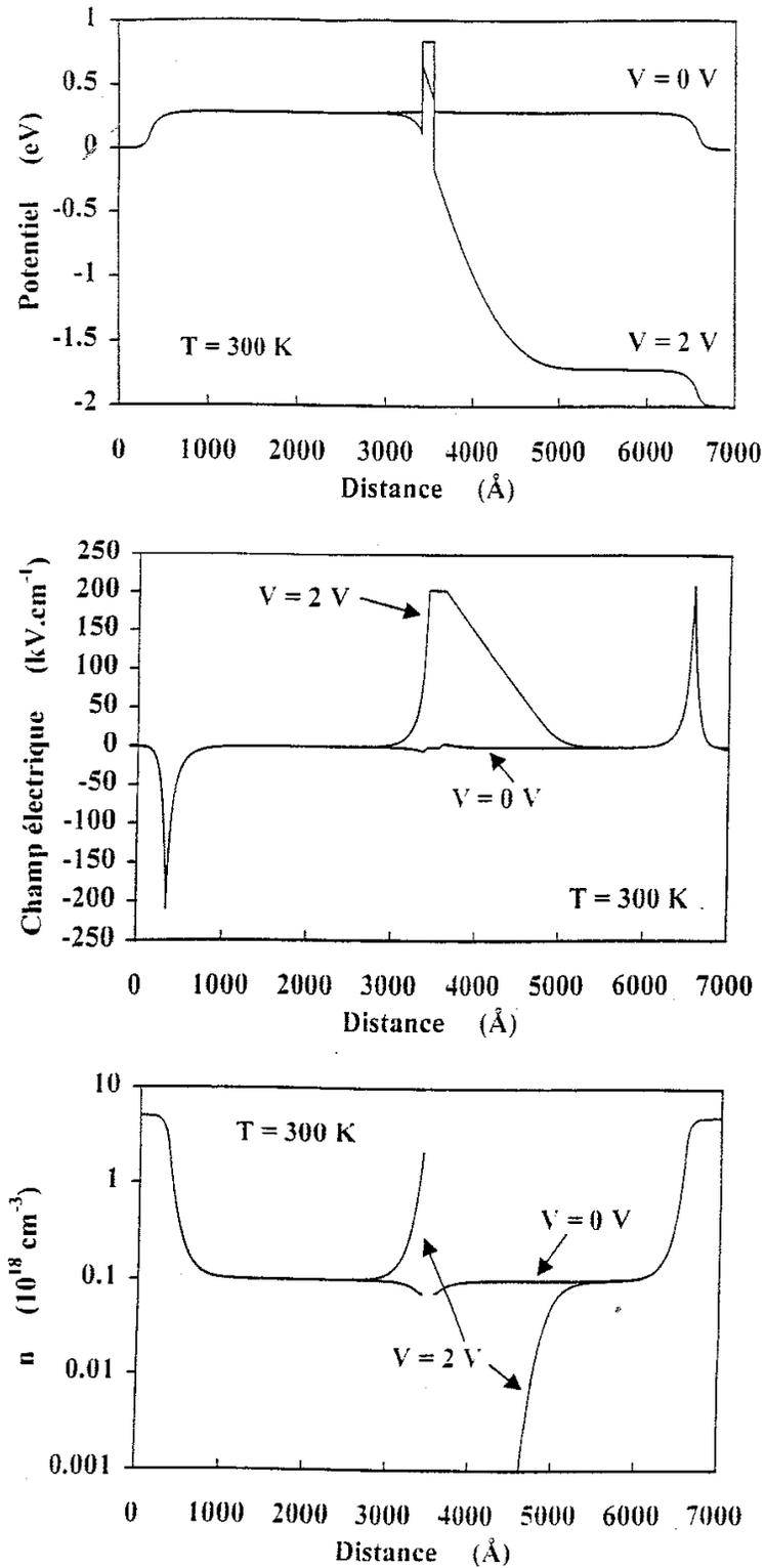
Figure II.19: Profil de potentiel, carte du champ électrique et profil de la concentration des porteurs libres calculés pour une structure GaInAs/AlInAs/GaInAs à l'équilibre ( $V=0$  Volt) et sous une polarisation de 2 Volt
