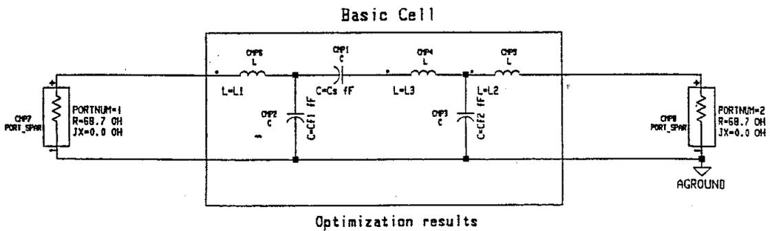
Figure IV.15: Circuit équivalent d'un stub ouvert simulé par HFSS
