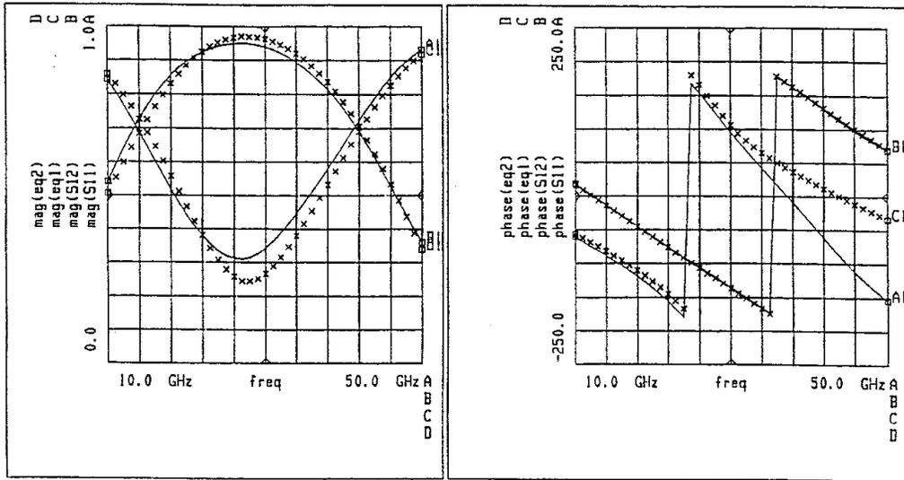
Figure IV.16: Comparaison des paramètres  $S_{ij}$  calculés par HFSS (Croix) et par MDS (traits continus). Les modules et les phases de  $S_{12}$  et de  $S_{11}$  sont représentés respectivement à gauche et à droite
