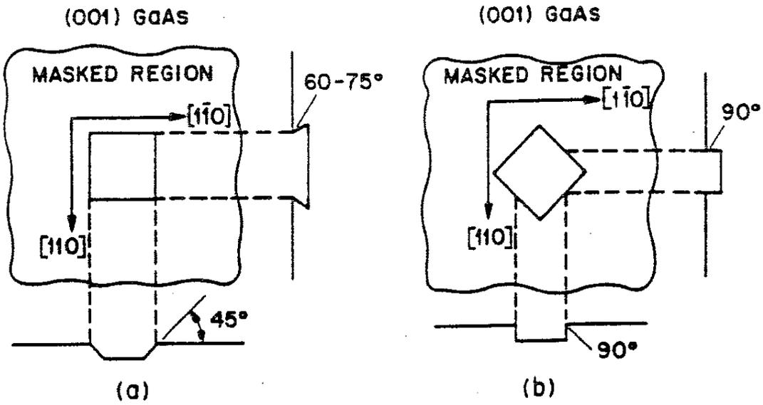
Figure I.11: Profil de gravure du GaAs de type (001)
