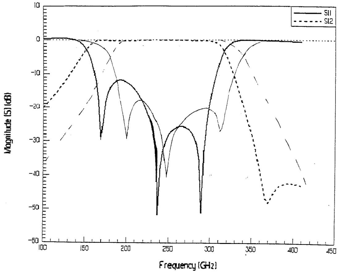
Figure IV.20: Réponse fréquentielle du filtre (Calcul par le logiciel HFSS avec  $S_{11}$  traits continus et  $S_{12}$  en traits pointillés) et comparaison avec les résultats calculés à l'Université du Michigan (en traits fins)
