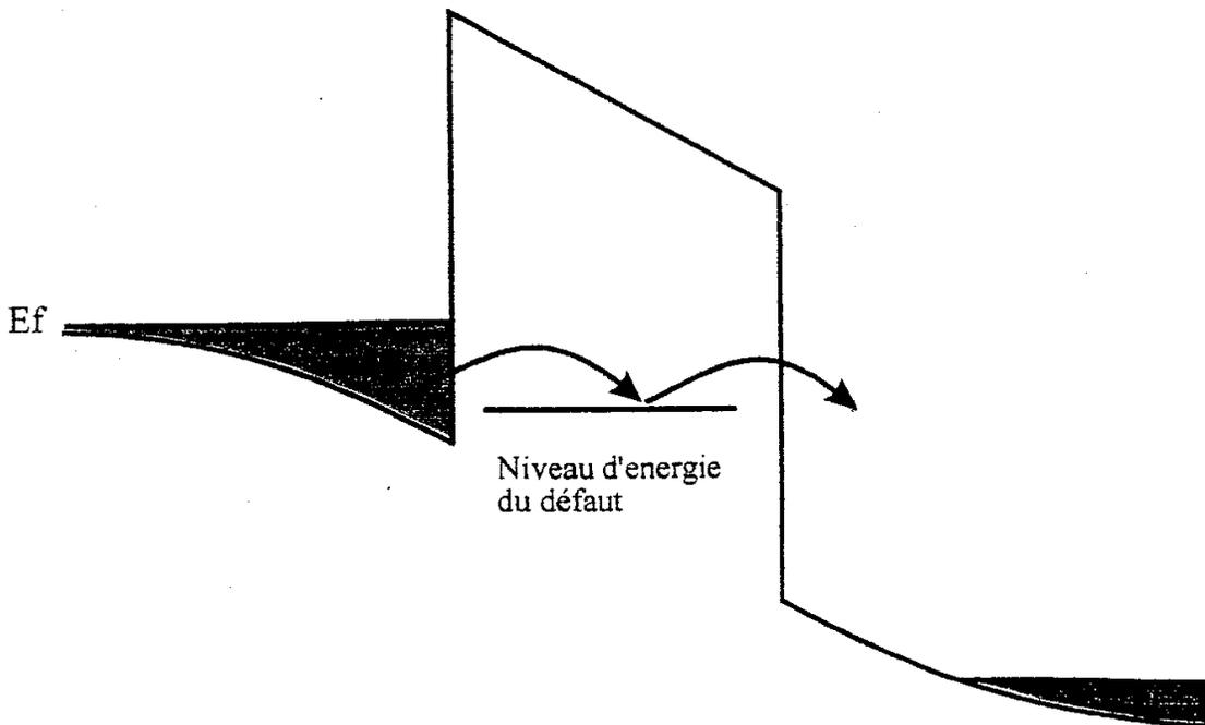
Figure II.23: Illustration des mécanismes de conduction assisté par défaut dans la barrière
