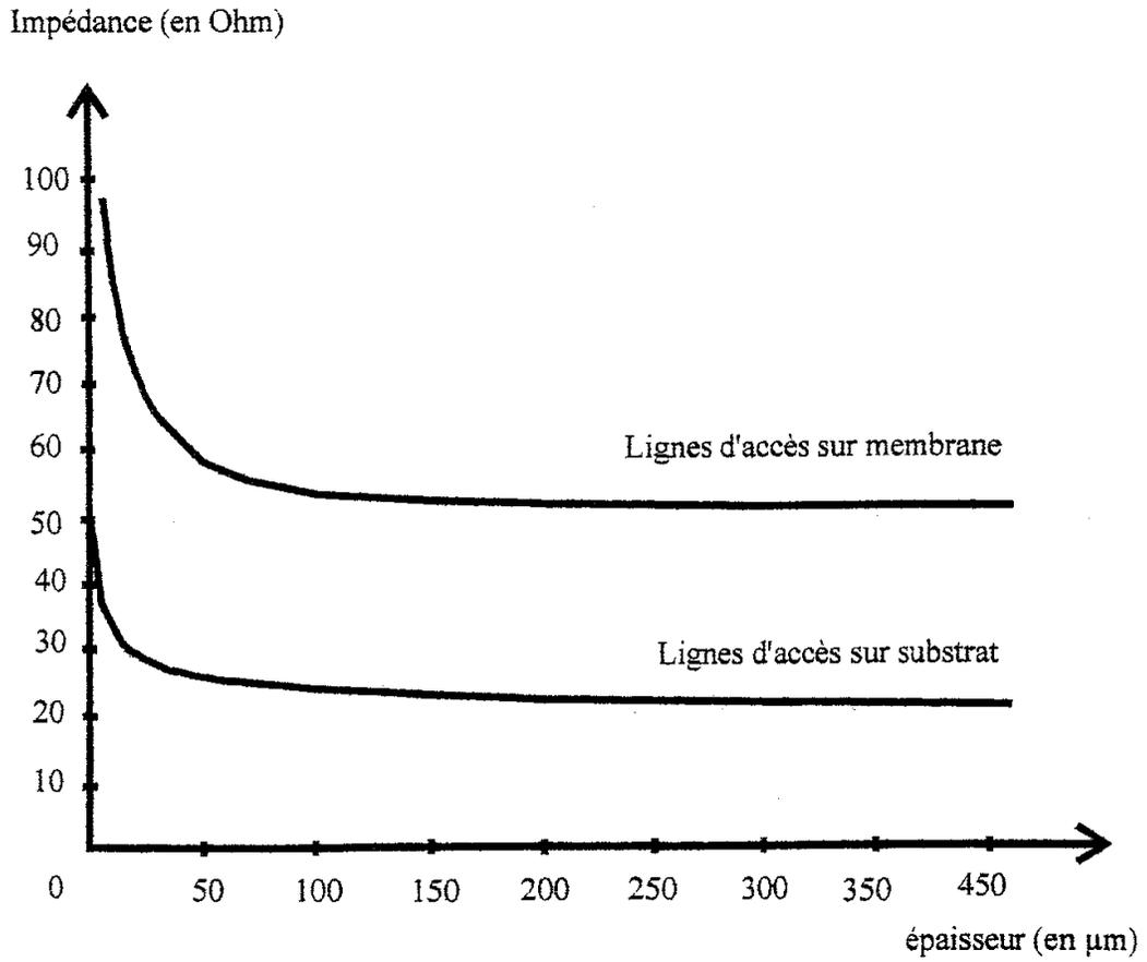
*Figure III.8: Evolution de l'impédance en fonction de l'épaisseur du substrat les dimensions  $w$  et  $a$  étant prises constantes, telles que l'impédance soit de 50 Ohm sur la membrane, ou sur le substrat*
