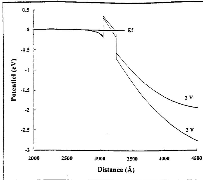
Figure II.20: Courbure de bas de bande de conduction pour deux polarisations différentes
