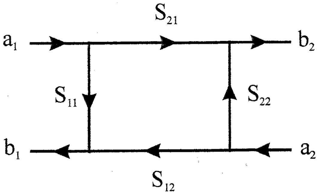
*Figure III.11: Schématisation du quadripôle hyperfréquence*
