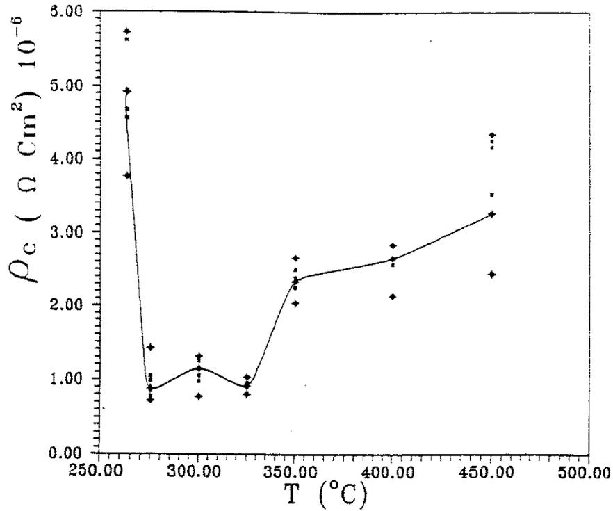
Figure 1.6: Evolution expérimentale de la résistivité  $\rho_c$  en fonction de la température, ce qui permet d'optimiser la température de recuit
