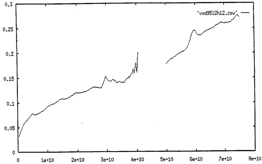
Figure III.21: Evolution de la constante d'atténuation en fonction de la fréquence
