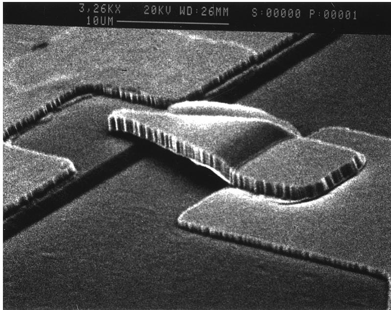
*Figure I.21: Pont réalisé par évaporation de métal*
