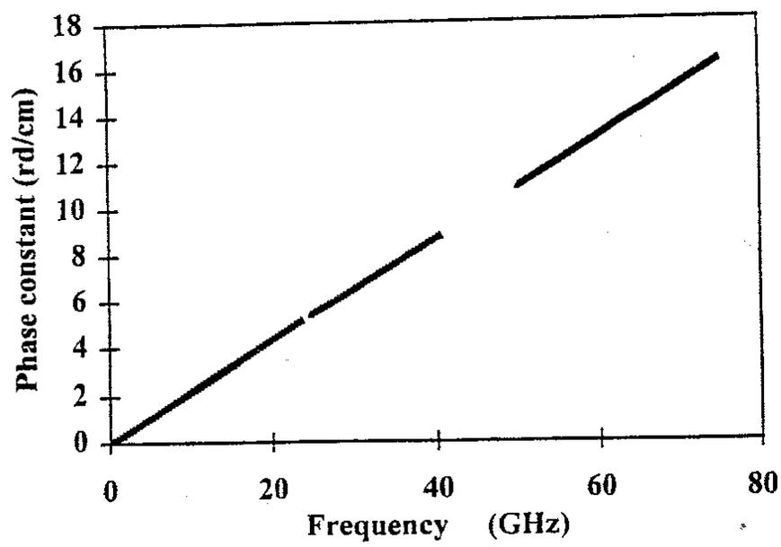
*Fig.III.20: Evolution de la constante de propagation  $\beta$  entre 1 et 110 GHz*
