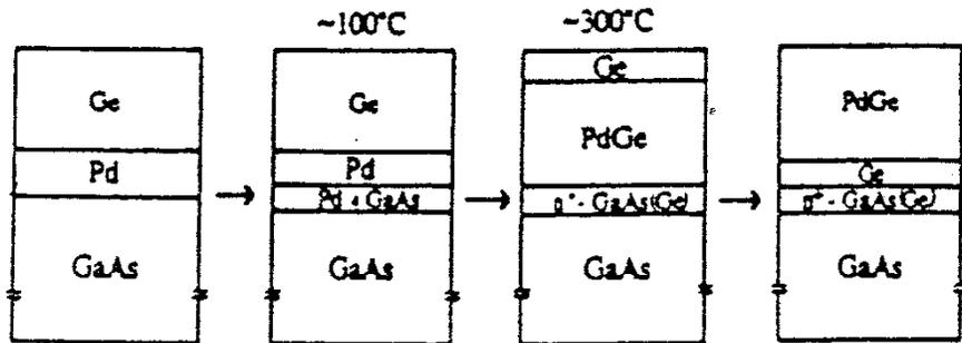
Figure 1.7: Illustration des phénomènes de formation de diverses phases apparaissant lors du recuit d'un contact Pd/Ge sur GaAs
