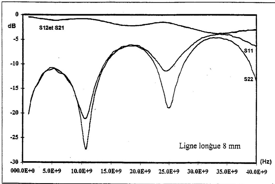
Fig.III.14: Couple de lignes 50 Ohm sur une membrane en Polyimide
